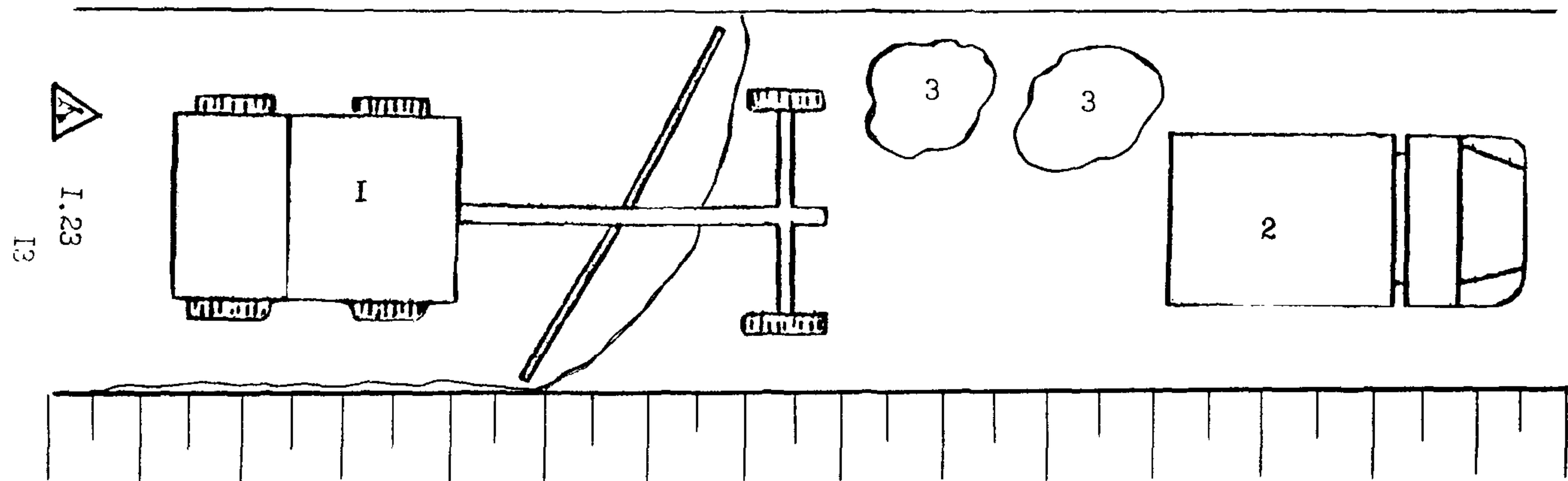
1 - автогрейдер ДЗ-122; 2 – автомобиль – самосвал; 3 – гравий.
