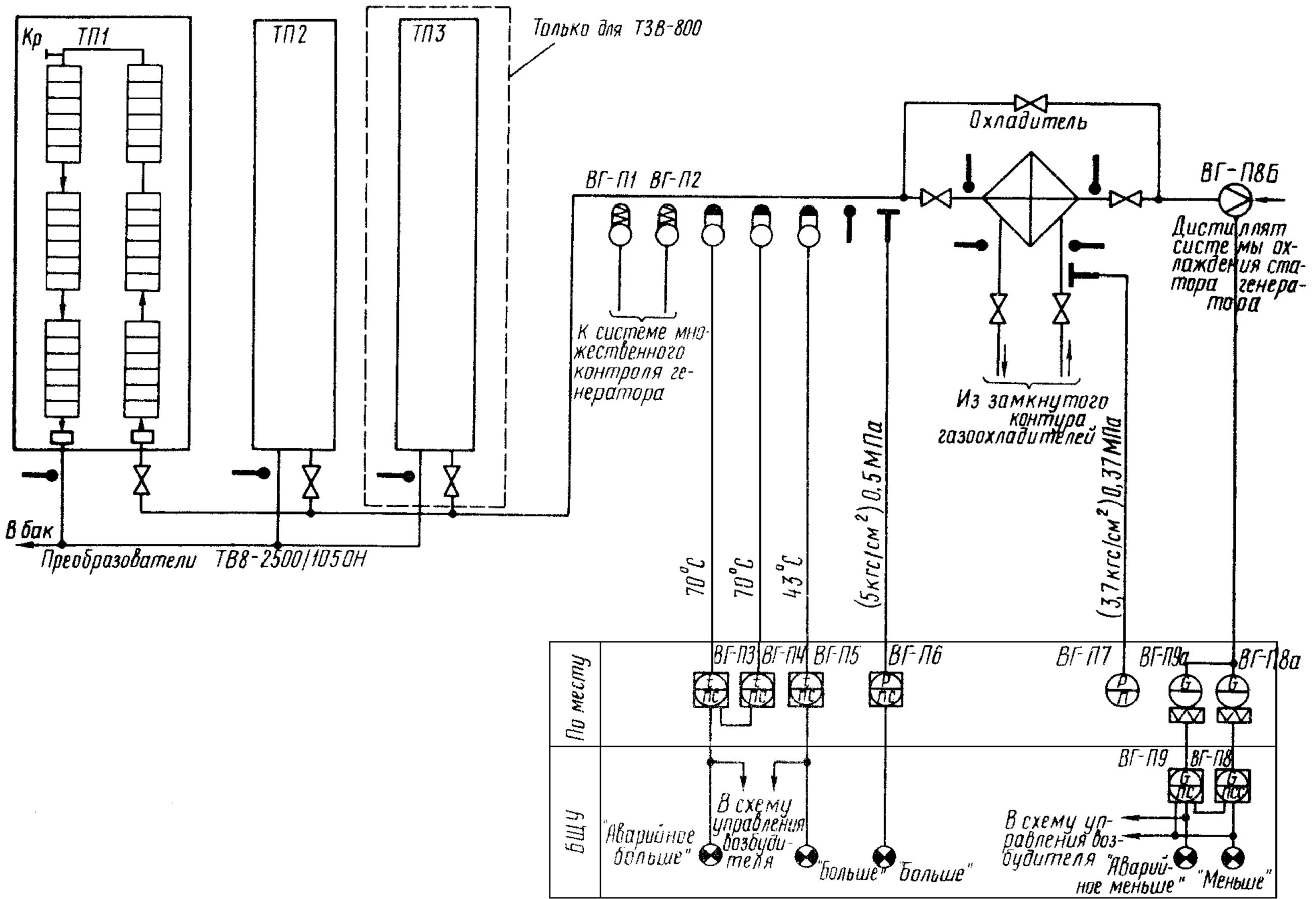
Рис. 2. Схема системы охлаждения тиристорных преобразователей:
