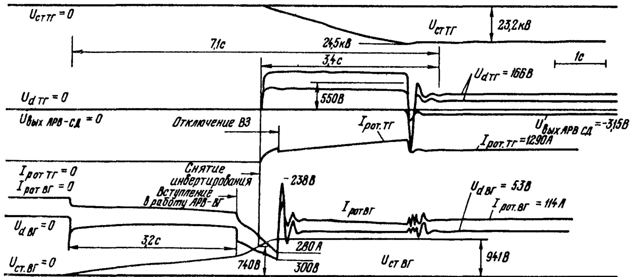
Рис.12. Осциллограмма начального возбуждения ТВВ-800-2 с АРВ-ТГ
