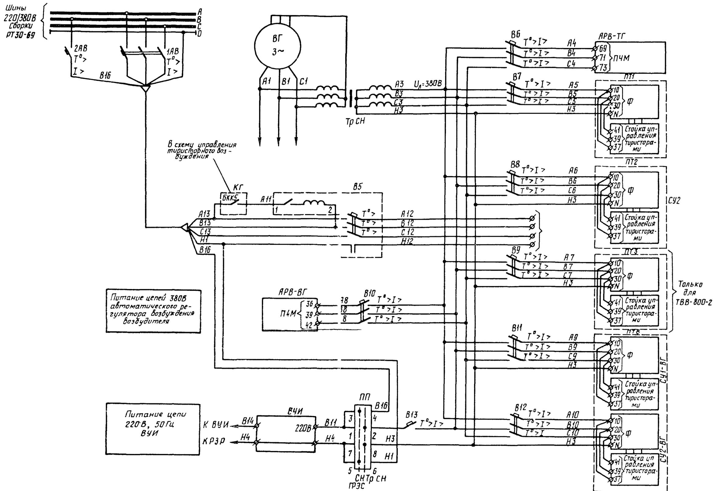
Рис. III.3. Схема питания собственных нужд тиристорного возбуждения:
