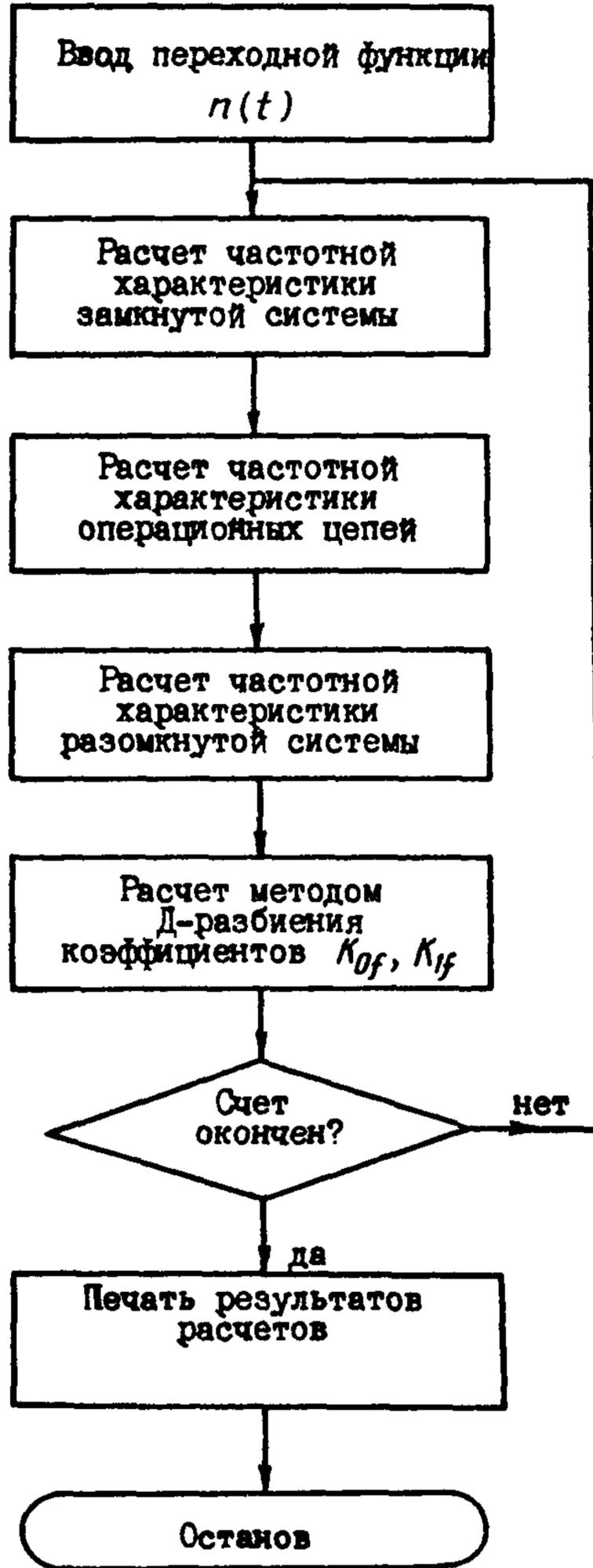
Рис. П2.11. Блок-схема расчета области устойчивости на ЗВМ
