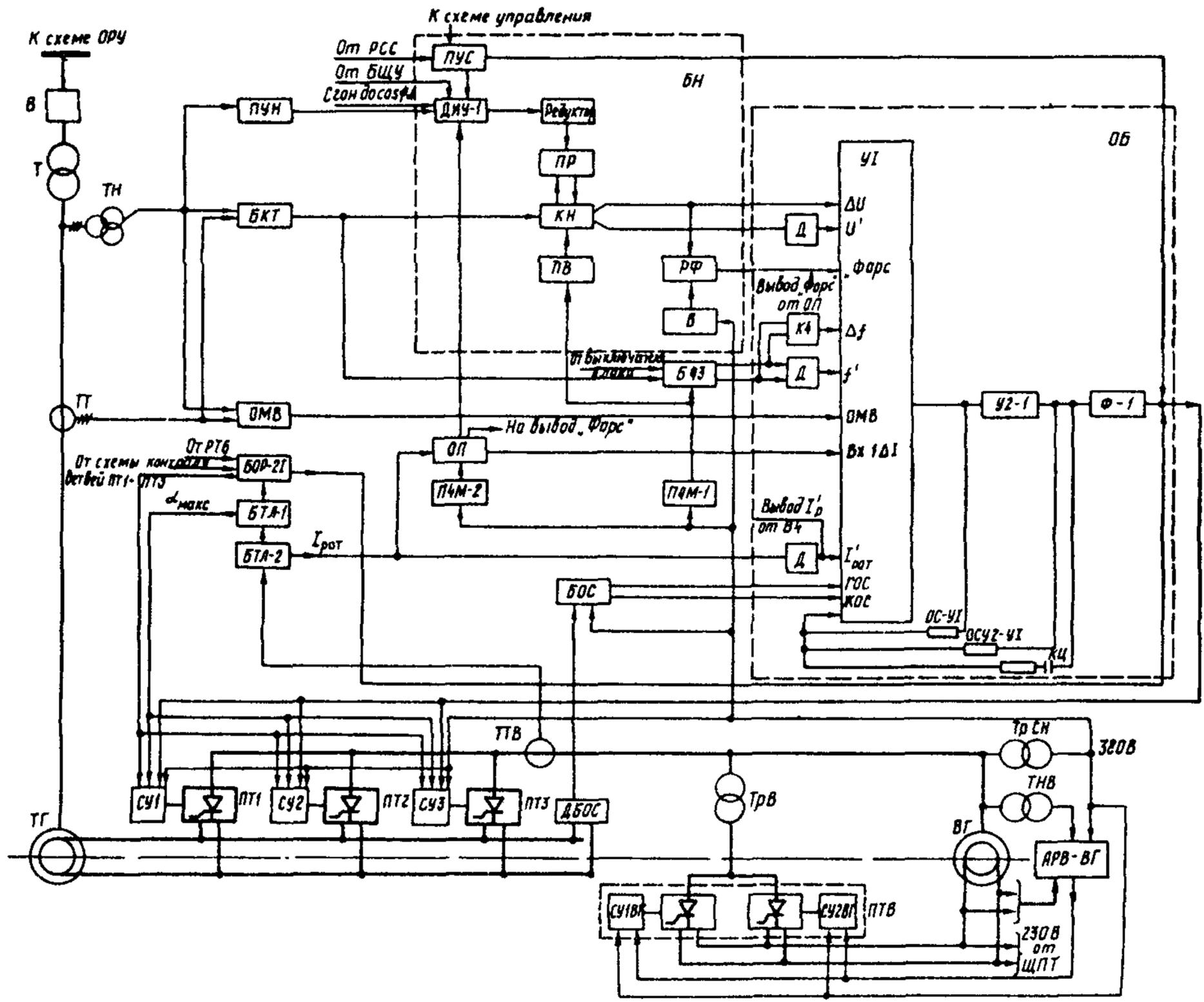
Рис. П.1. Структурная схема тиристорного возбудителя с АРВ турбогенератора ТВВ-800-2:
