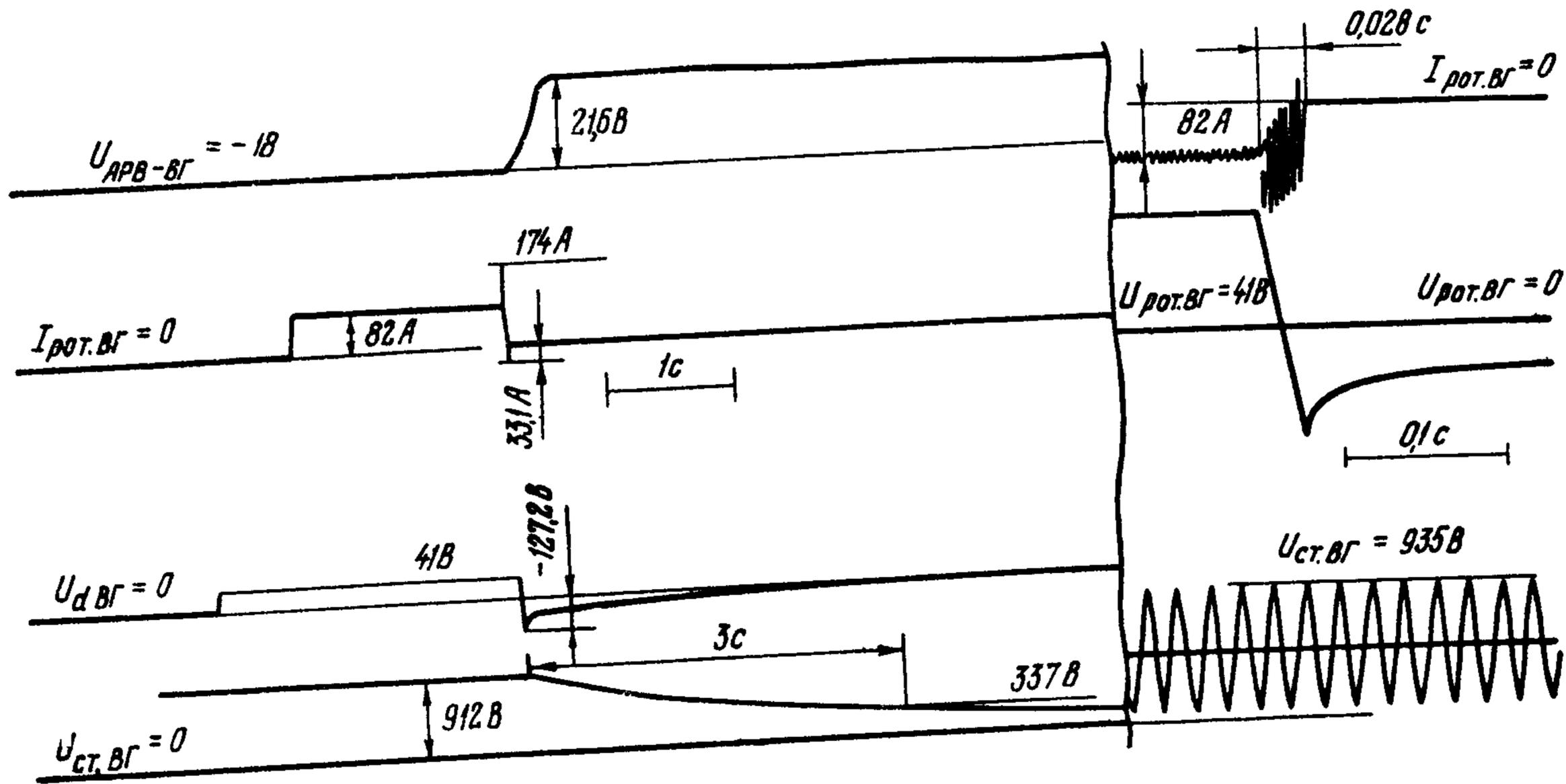
Рис.6. Осциллограмма гашения поля ВГ отключением контактора КТ для ТВВ-800-2 (холостой ход)
