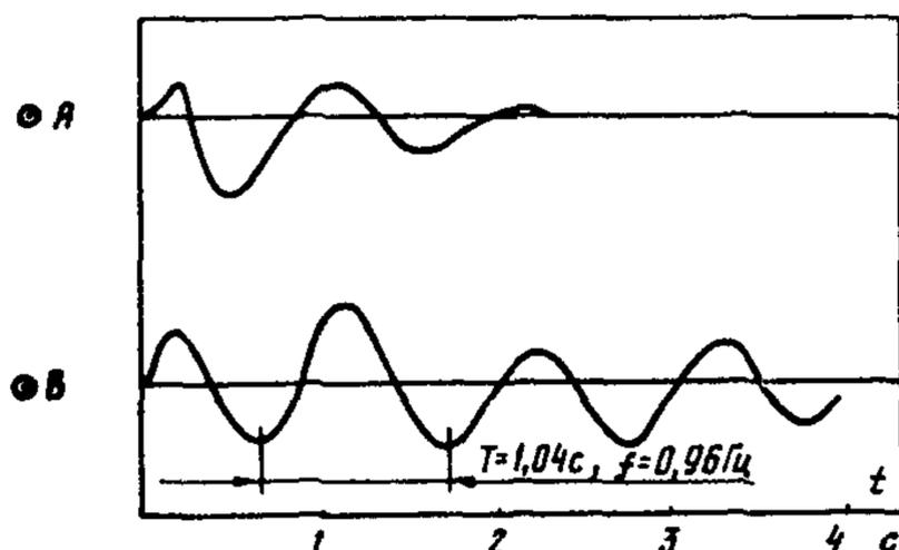
Рис.П2.10. Базовая и контрольная осциллограммы для расчета области устойчивости на ЭВМ
