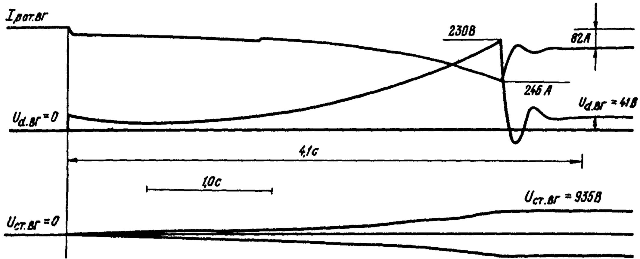
Рис.5. Осциллограмма начального возбуждения ВГ с ПДУ для ТВВ-800-2
