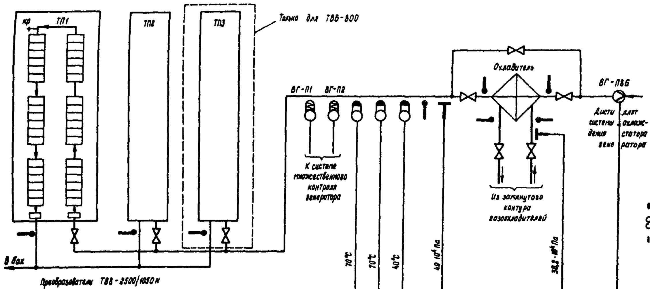
Рис. III.4. Система охлаждения тиристорных преобразователей
