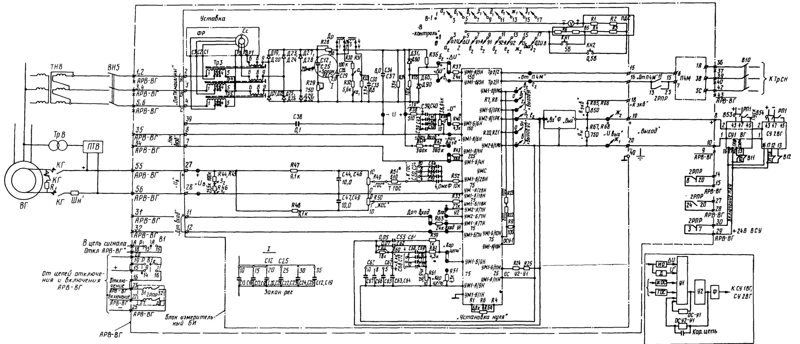
Рис. ПЛ.10. Схема регулятора возбуждения АРВ-ВГ-0:
