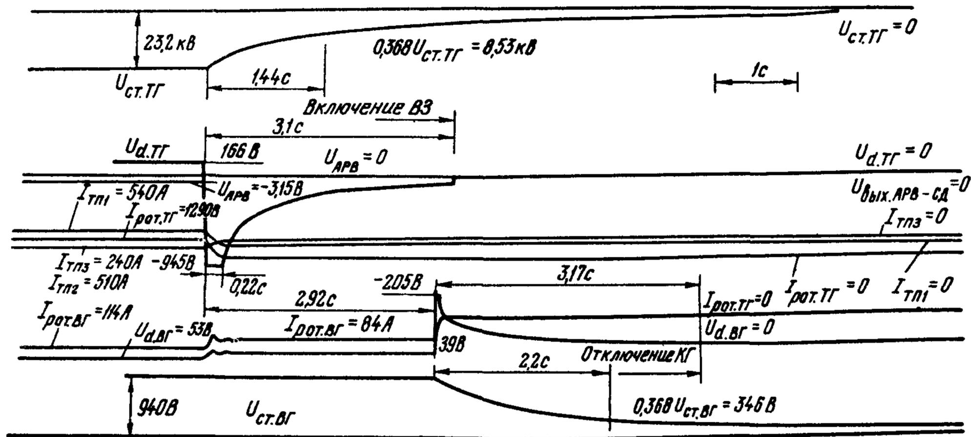
Рис. 10. Осциллограмма гашения поля ТВВ-800-2 при работе его на холостом ходу ключом с БЩ
