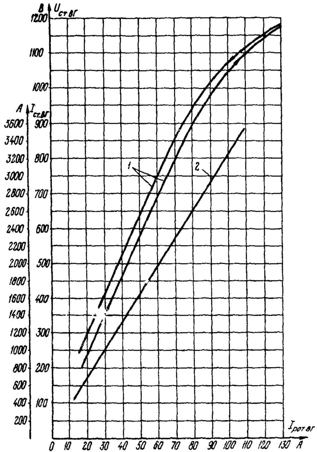
Рис. I. Характеристики холостого хода и короткого замыкания ВГ для ТВВ-800-2:
