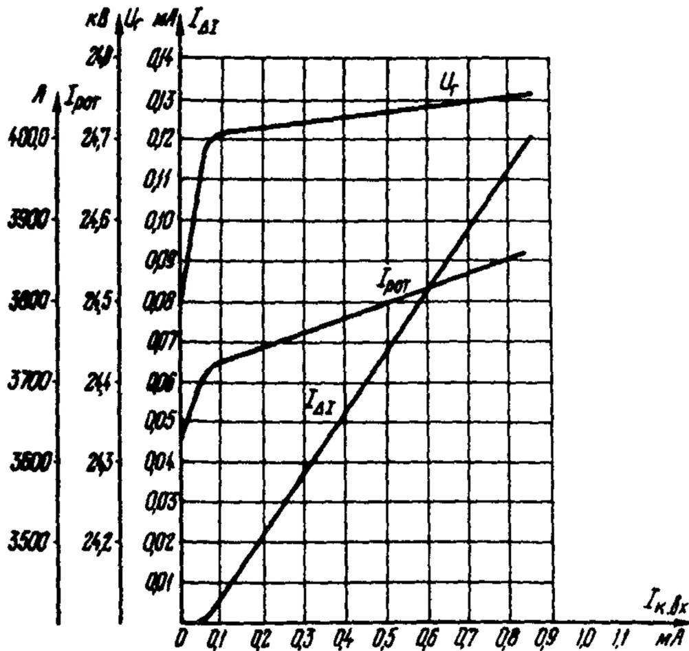
Рис.14. Характеристика работы статической схемы ОП
