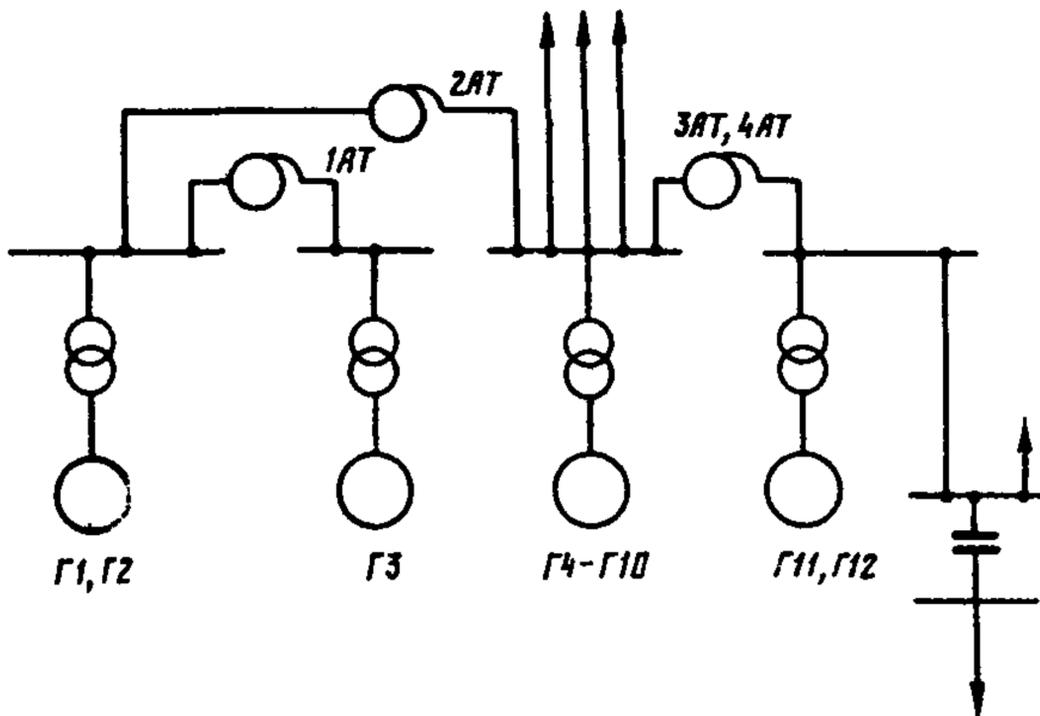
Рис. П2.3. Упрощенная электрическая схема Молдавской ГРЭС
