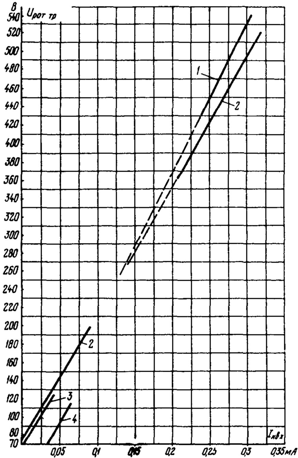
Рис.7. Регулировочная характеристика системы возбуждения генератора:
