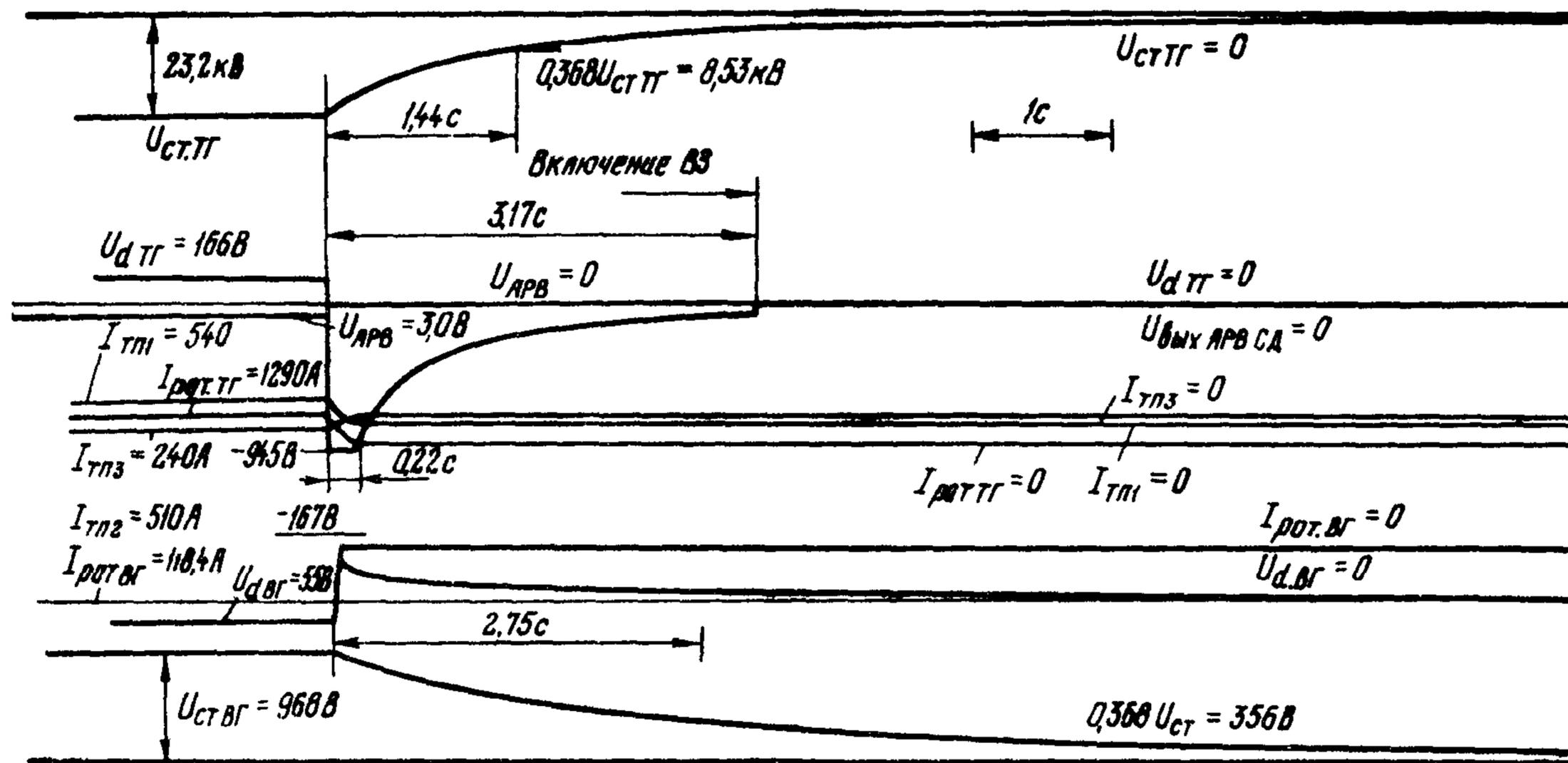
Рис. II. Осциллограмма гашения поля ТВВ-800-2 при работе его на холостом ходу отключением КГ от защиты
