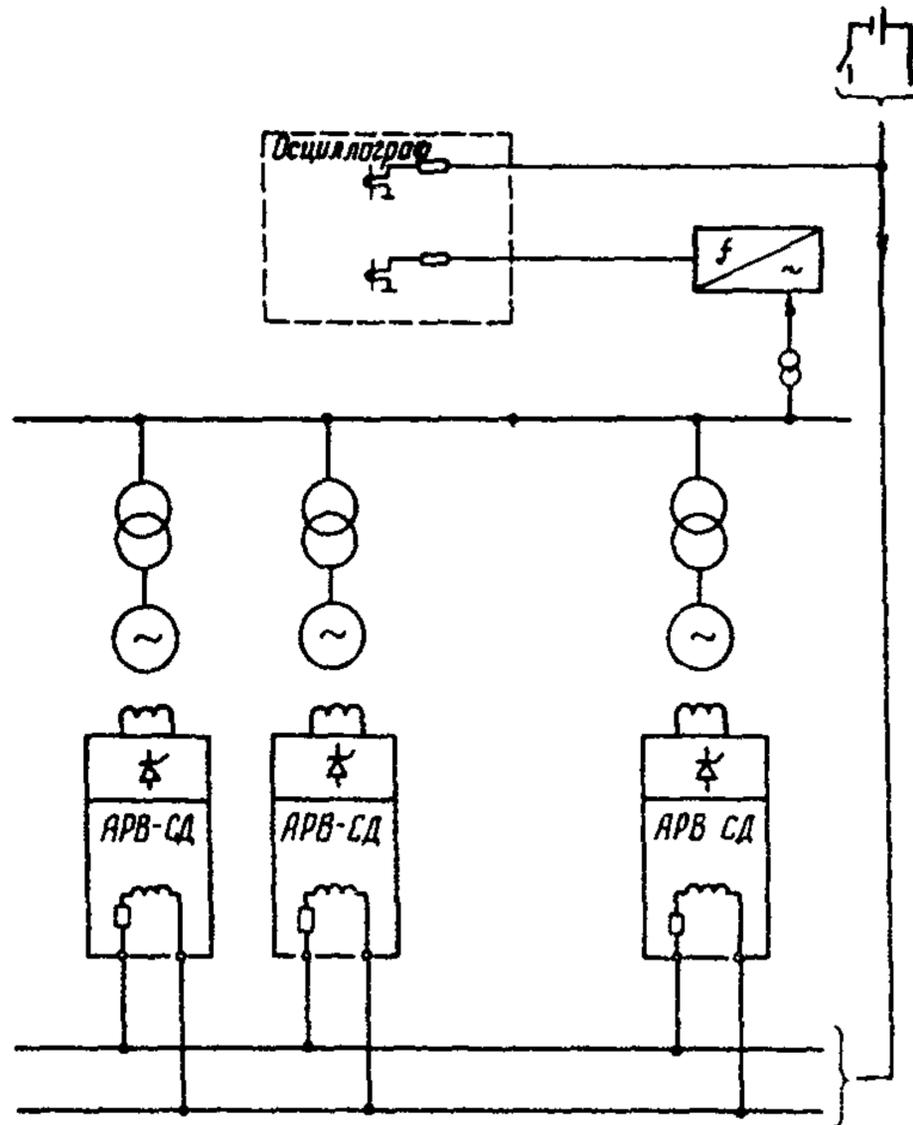
Рис. П2.8. Схема, поясняющая метод проведения системных испытаний
