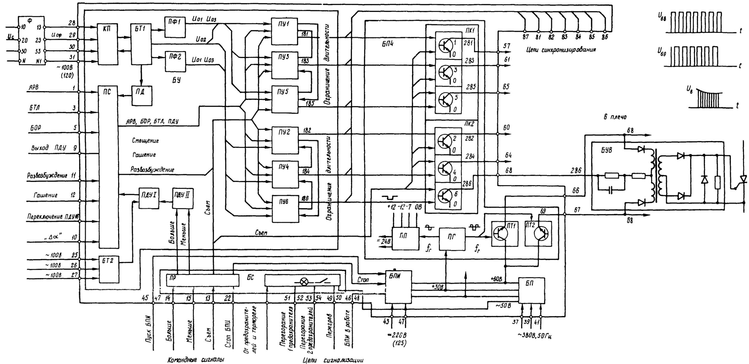
Рис. П.1.5. Структурная схема системы управления тиристорами:
