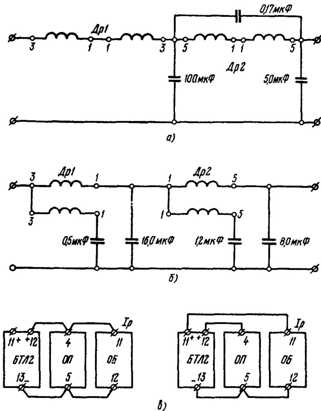
Рис.9. Схема выходного фильтра ОБ и цепей  $I_p'$  в системе самовозбуждения ТГВ-200:
