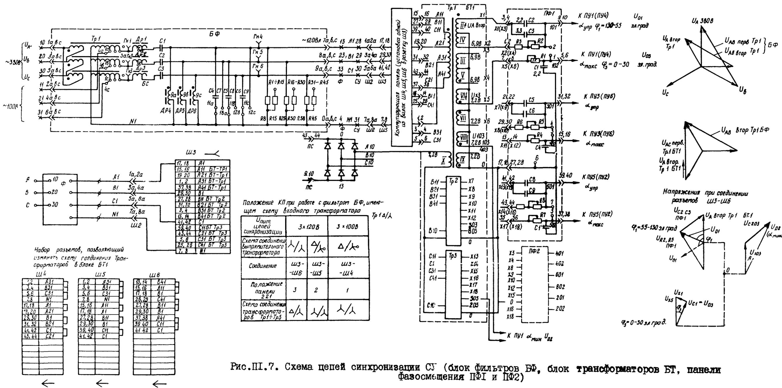
Рис. III.7. Схема цепей синхронизации СУ (блок фильтров БФ, блок трансформаторов БТ, панели фазосдвигающих ПФ1 и ПФ2)
