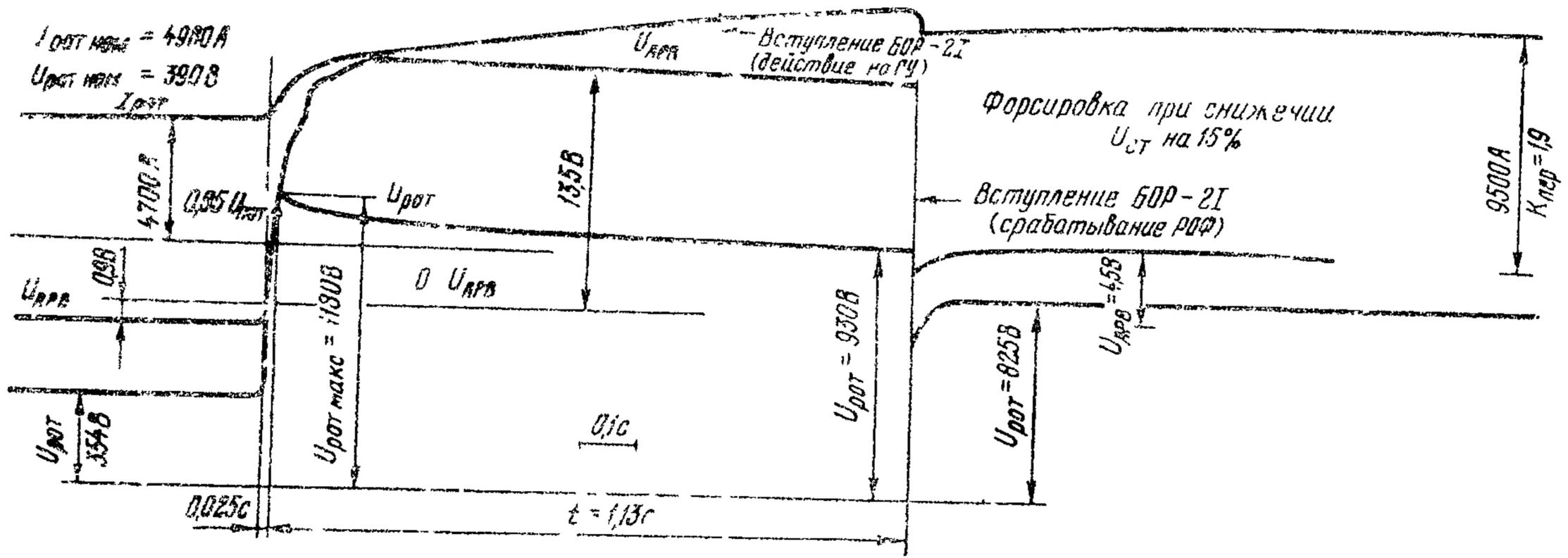
Рис. 16. Опыт форсировки возбуждения при работе ТБВ-300-2 в сети
