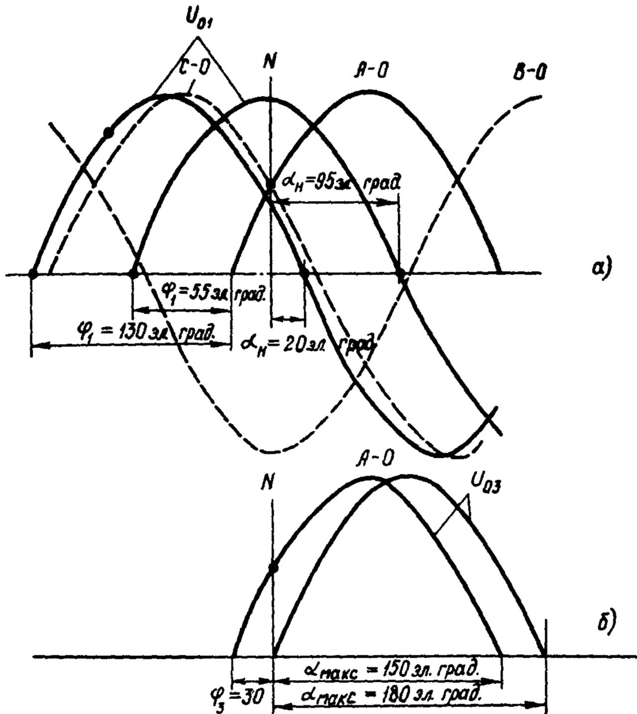
Рис. П.9. Взаимное расположение опорных синусоид в панели ПФ:
