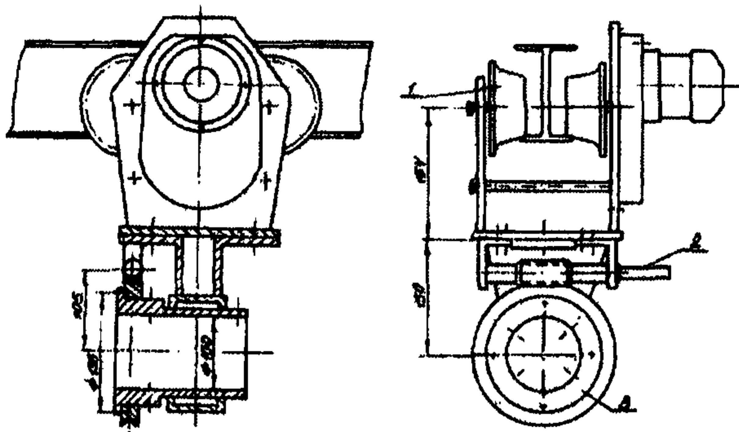
Рис.2.4. Приспособление для перемещения и вращения зонда:
