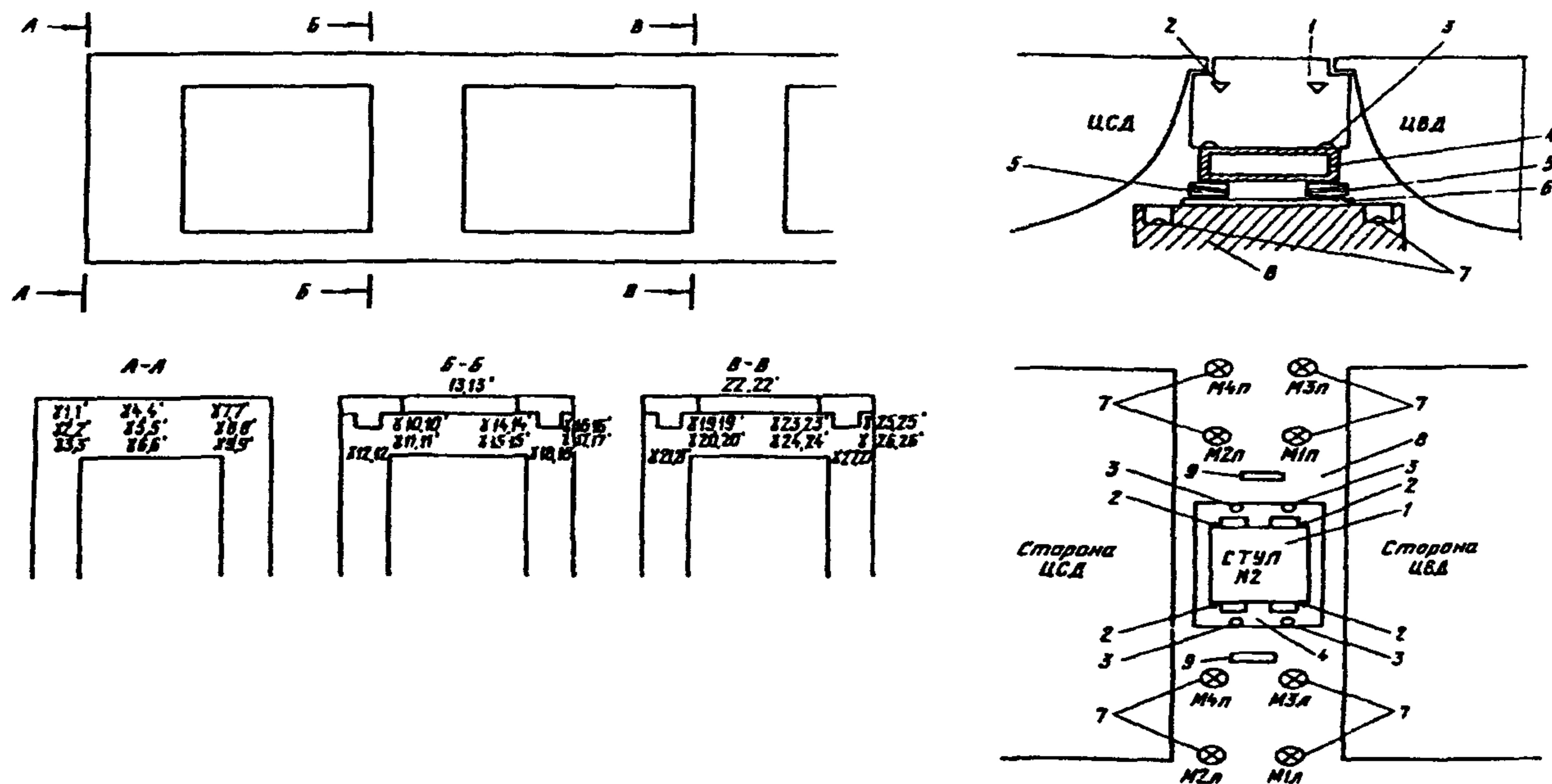
1 – опорный стул; 2 – деформационная марка на опорном стуле; 3 – марка в фундаментной плите;
