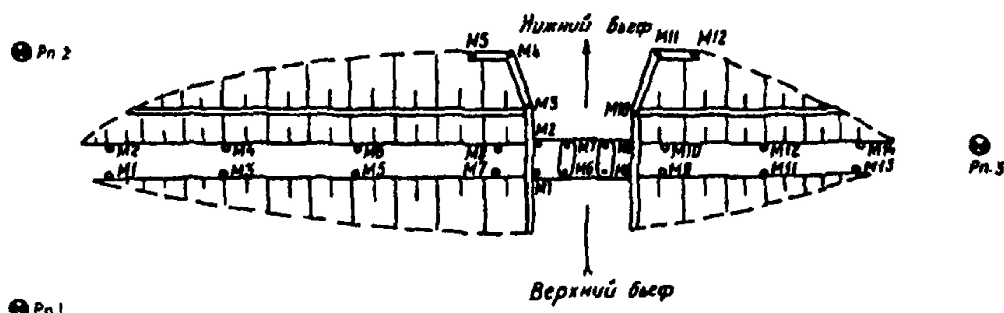
● Rп.1 – исходный репер и его номер; ○ M2 – осадочная марка в земляной плотине и ее номер; ■ M4 – торцевая осадочная марка в бетонном водосбросе (тип «в») и ее номер
