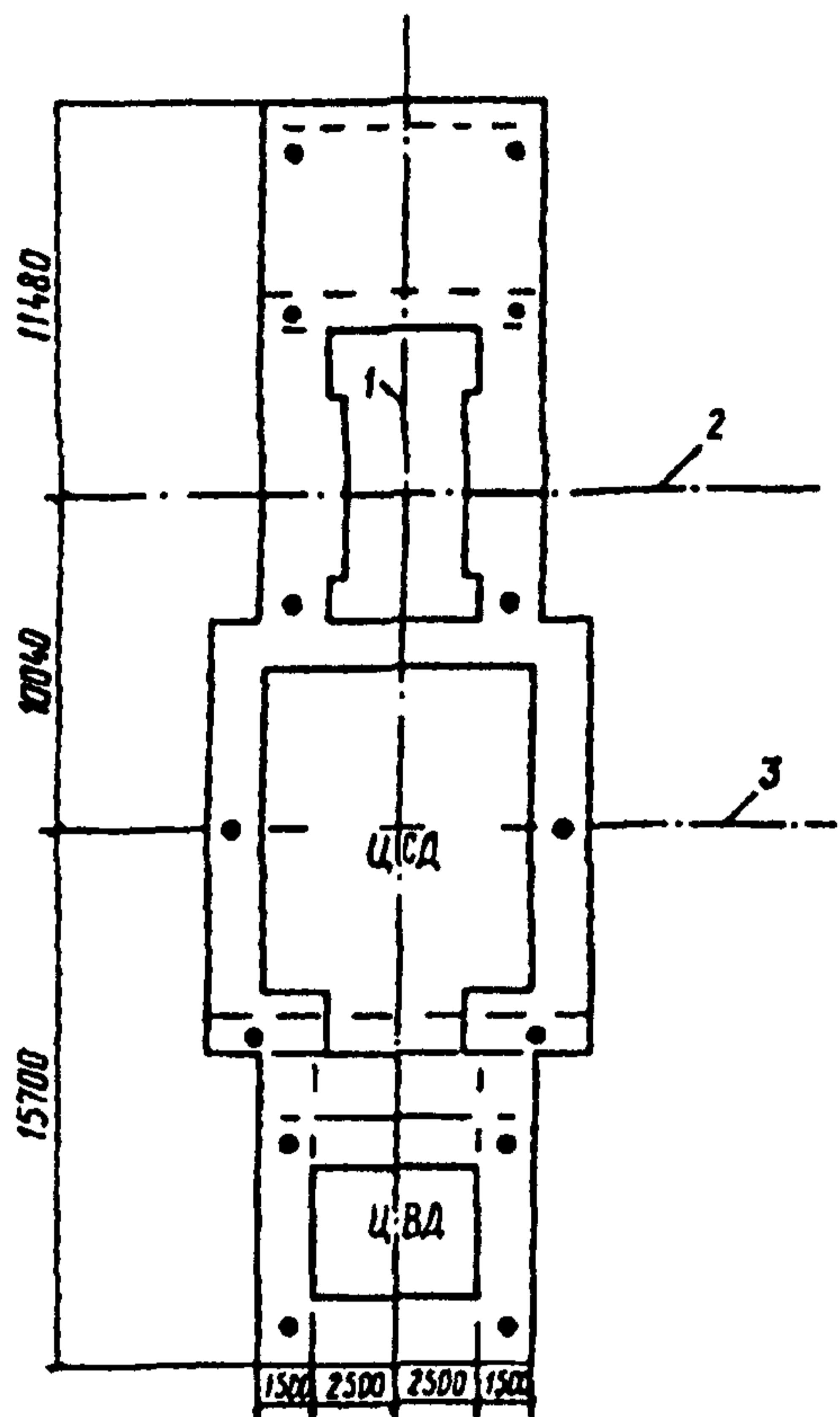
1 – ось турбоагрегата; 2 – ось генератора; 3 – ось конденсатора
