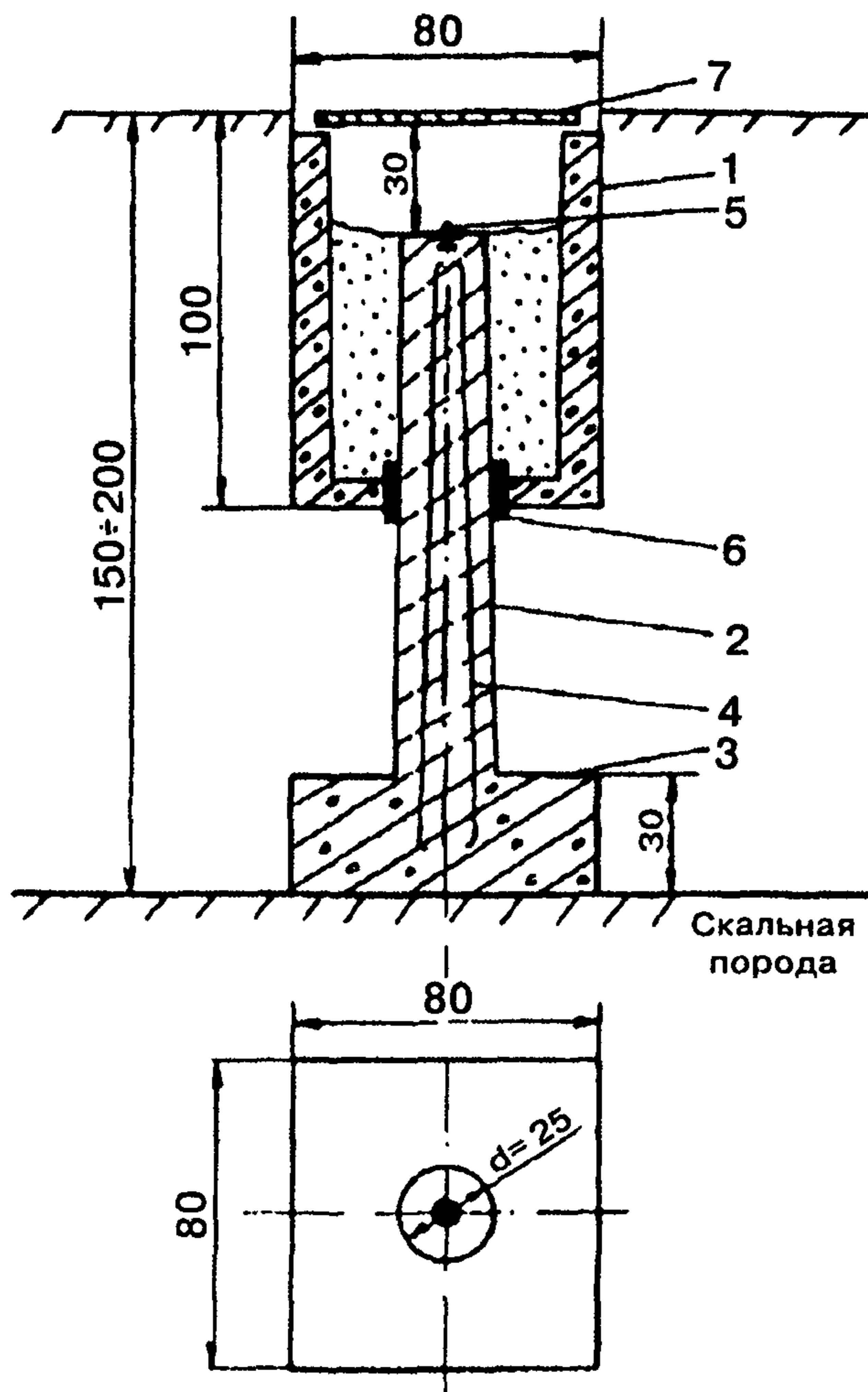
1 – железобетонный или металлический колодец, 2 – асбокрементная труба диаметром 250 мм, 3 – железобетонный пилои; 4 – арматура; 5 – нивелирная марка; 6 – сальник; 7 – крышка
