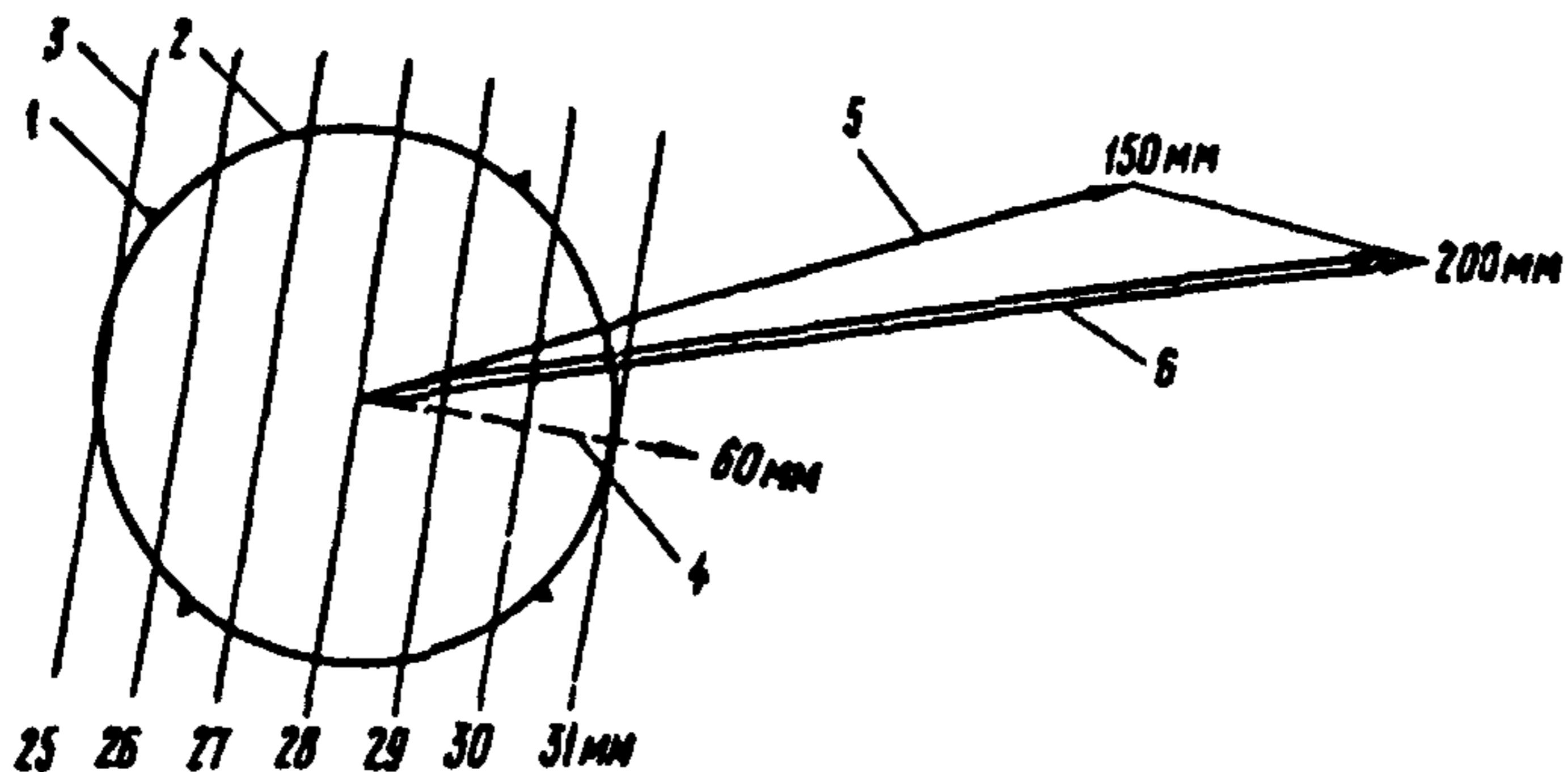
1 – осадочная марка; 2 – дымовая труба; 3 – линия равной осадки через 1 мм; 4 – крен и его направление, вычисленные по разности осадки; 5 – направление крена трубы к моменту изменения осадки; 6 – общий крен
