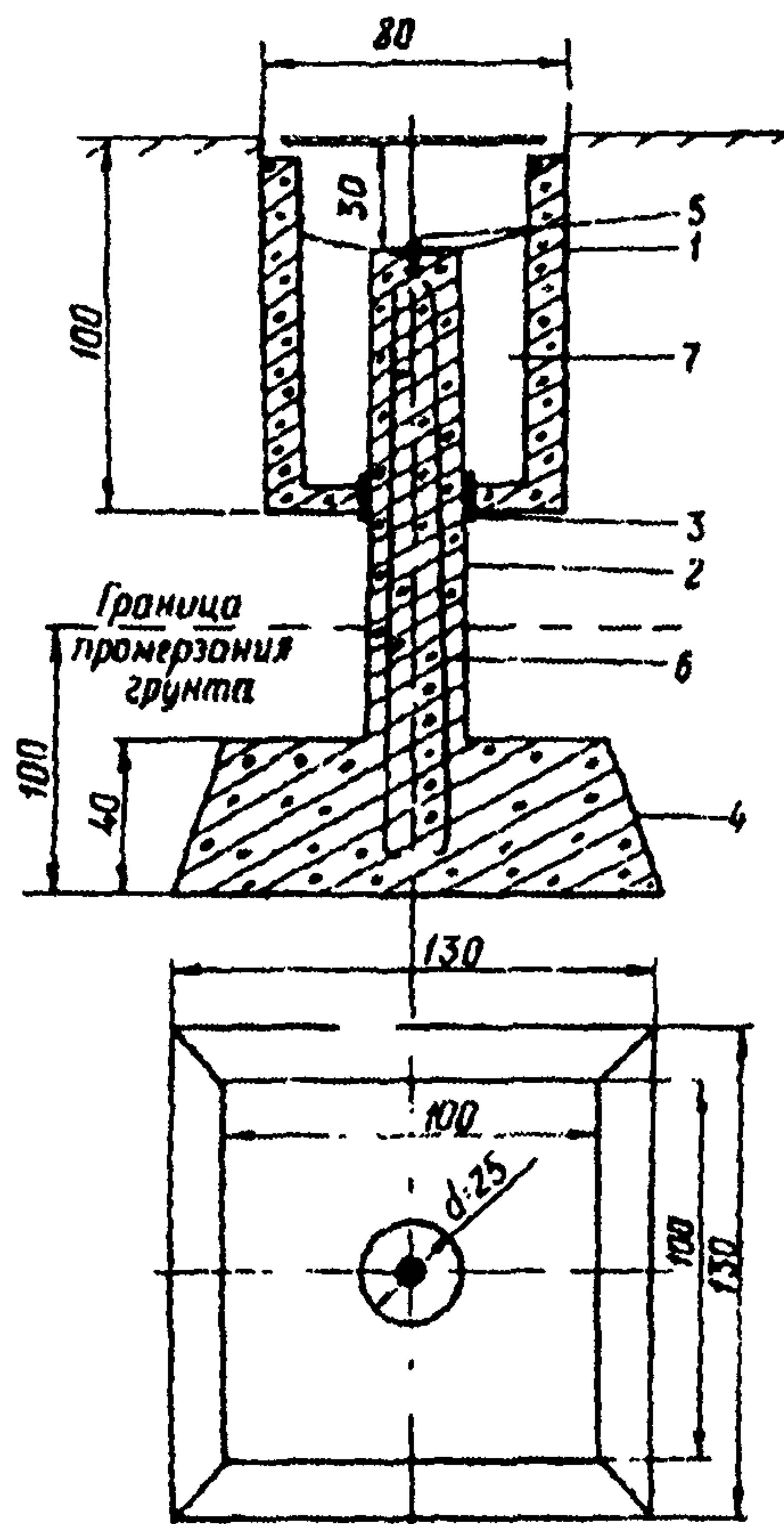
1 – железобетонный или металлический колодец с крышкой; 2 – асбоцементная труба диаметром 250 мм; 3 – сальник; 4 – железобетонный монолит; 5 – нивелирная марка; 6 – арматура; 7 – шлак, песок
