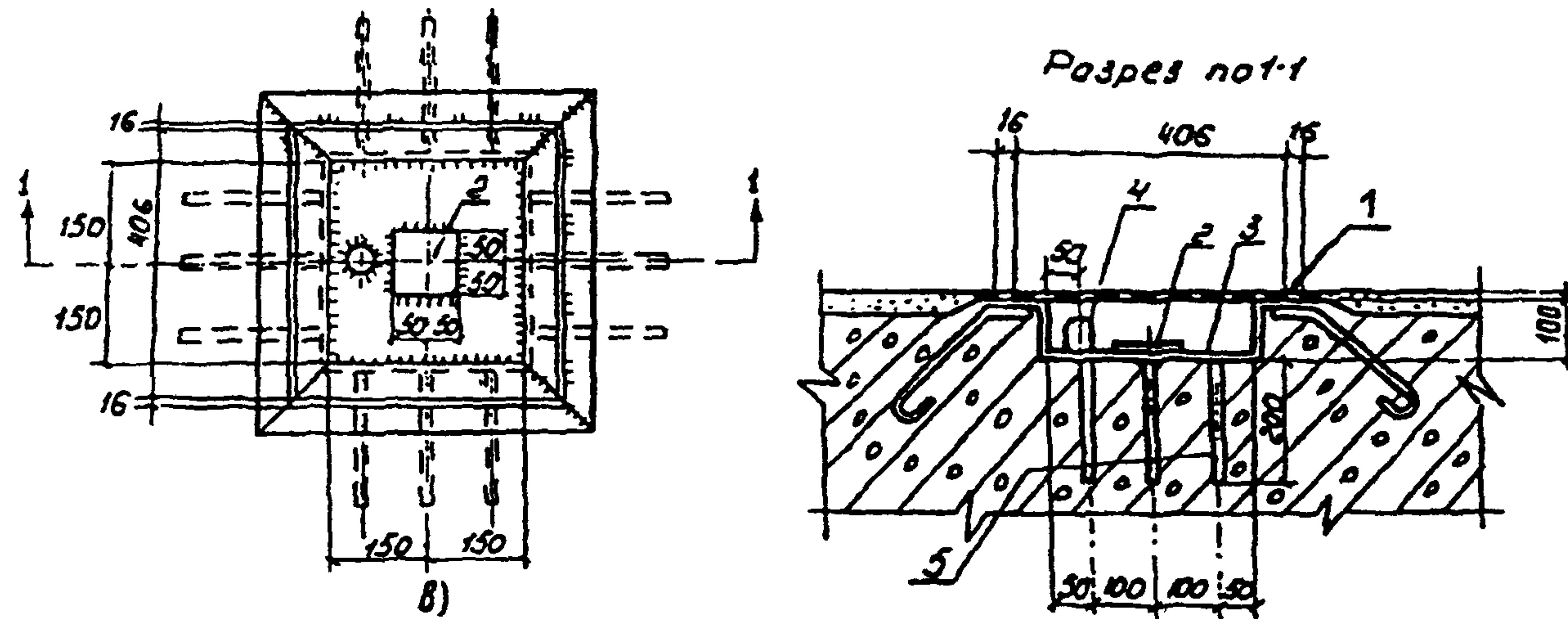
а – тип «а» для кирпичных стен и железобетонных конструкций, материал – Ст 3; б – тип «б» для металлических колонн, материал – Ст 3 прокатная равнобокая (ГОСТ 8509-93 [2]);
