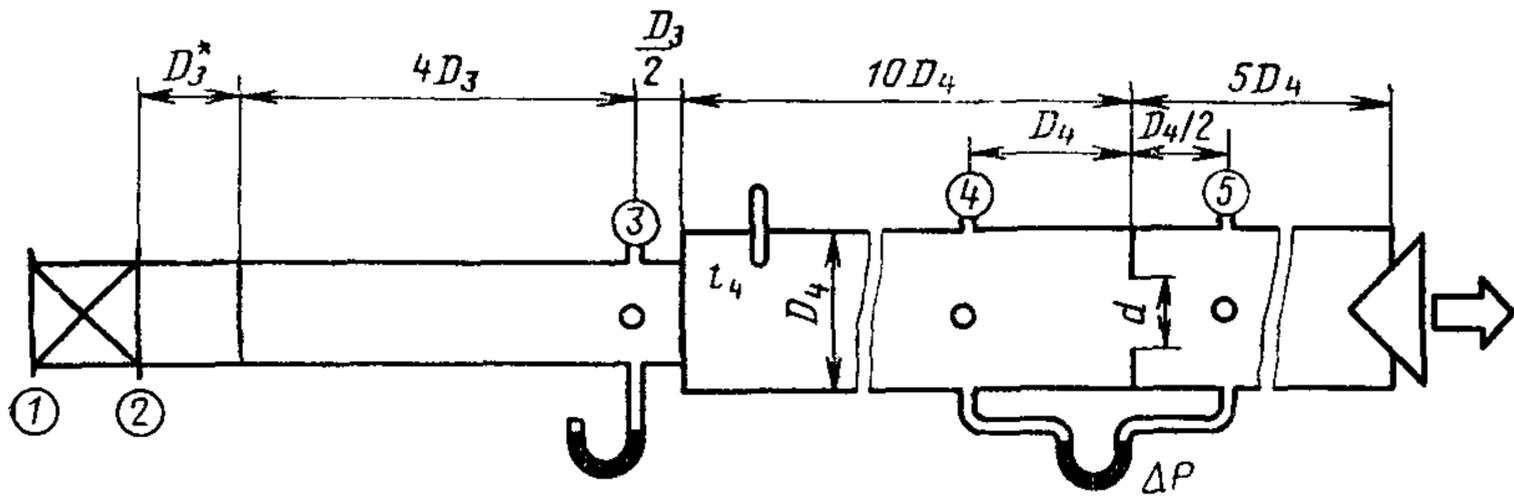
b — стенд с диафрагмой в трубе  $D_4$  и  $D_4/2$  или с угловыми отверстиями
