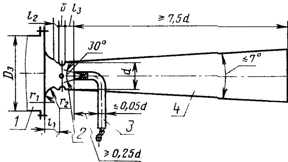
$r_1 = 0,2d$ ;  $r_2 = 0,333d$ ;  $l_1 = 0,304d$ ;  $l_2 = 0,3d$ ;  $0,4d \geq l_3 \geq 0,2d$ ;  $\delta < 0,13d$
