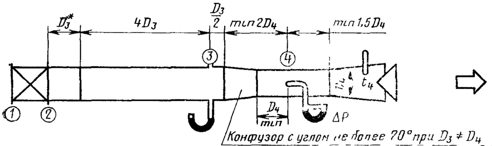
c — стенд с использованием трубки Пито
