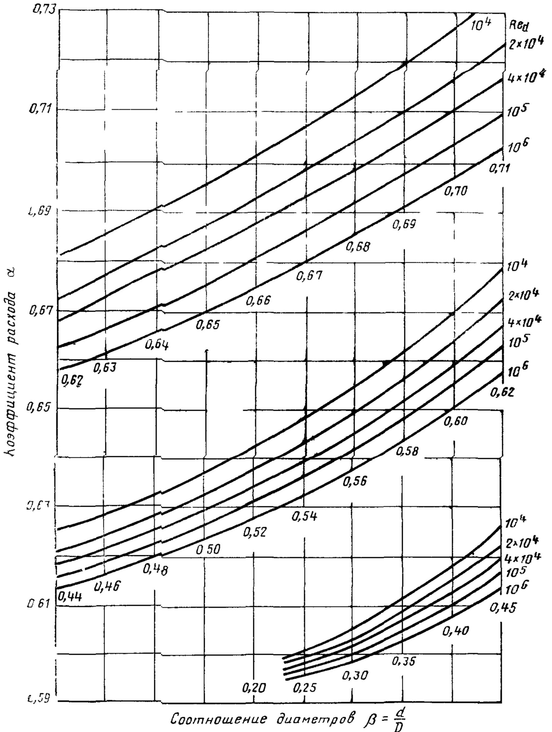
Коэффициент расхода при использовании диафрагмы в трубе с угловыми отверстиями
