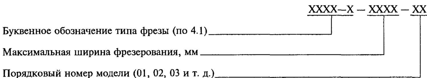
**Пример** индексации колесной фрезы с максимальной шириной фрезерования 1000 мм третьей модели:
