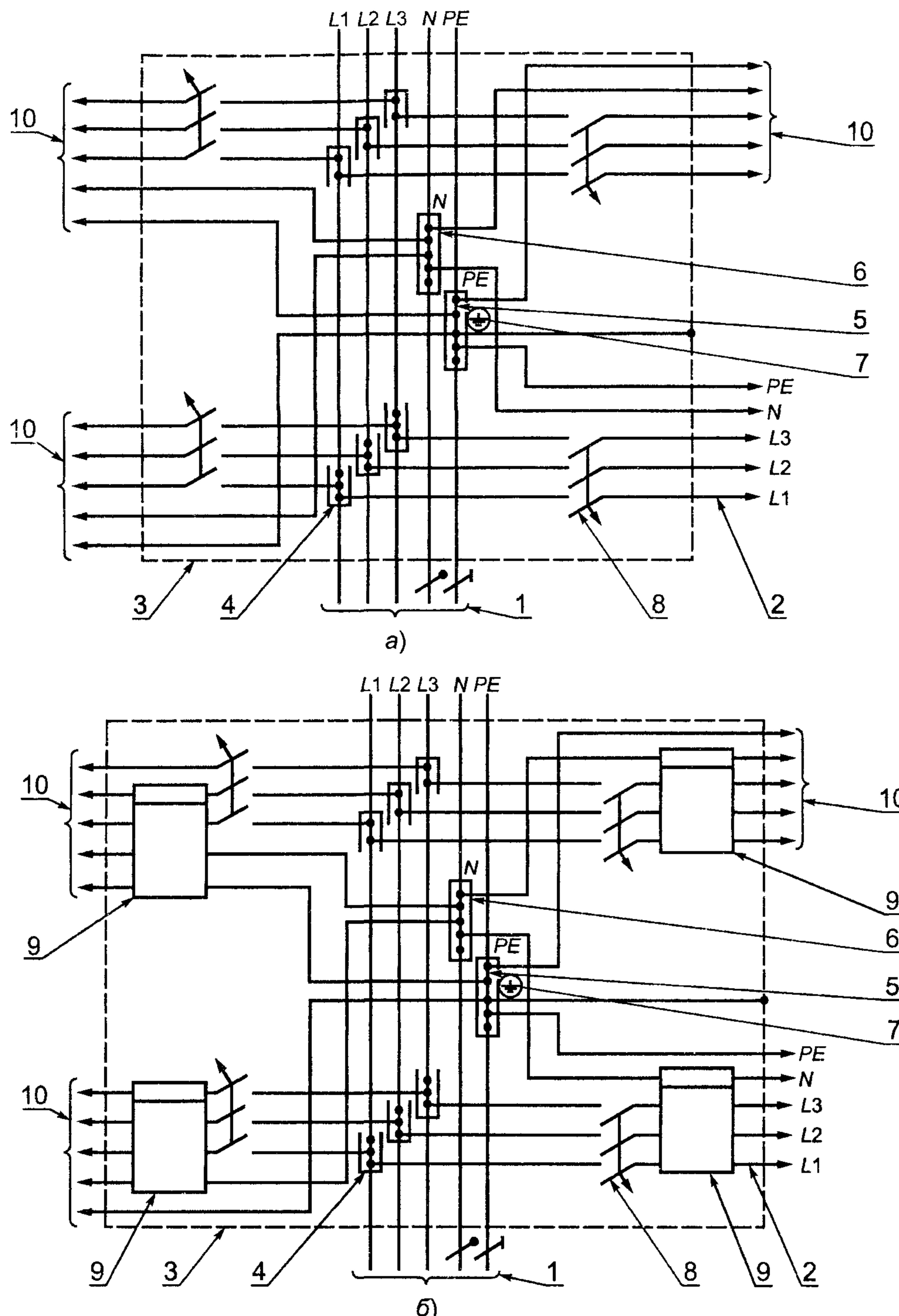
1 — питающая цепь; 2 — распределительная цепь; 3 — проводящая оболочка щитка; 4, 5, 6 — зажимы для проводников питающей цепи (фазных, нулевого защитного РЕ и нулевого рабочего N) и проводников распределительных цепей; 7 — знак заземления у зажима (поз. 6); 8 — автоматические выключатели; 9 — счетчик; 10 — линии групповых цепей
