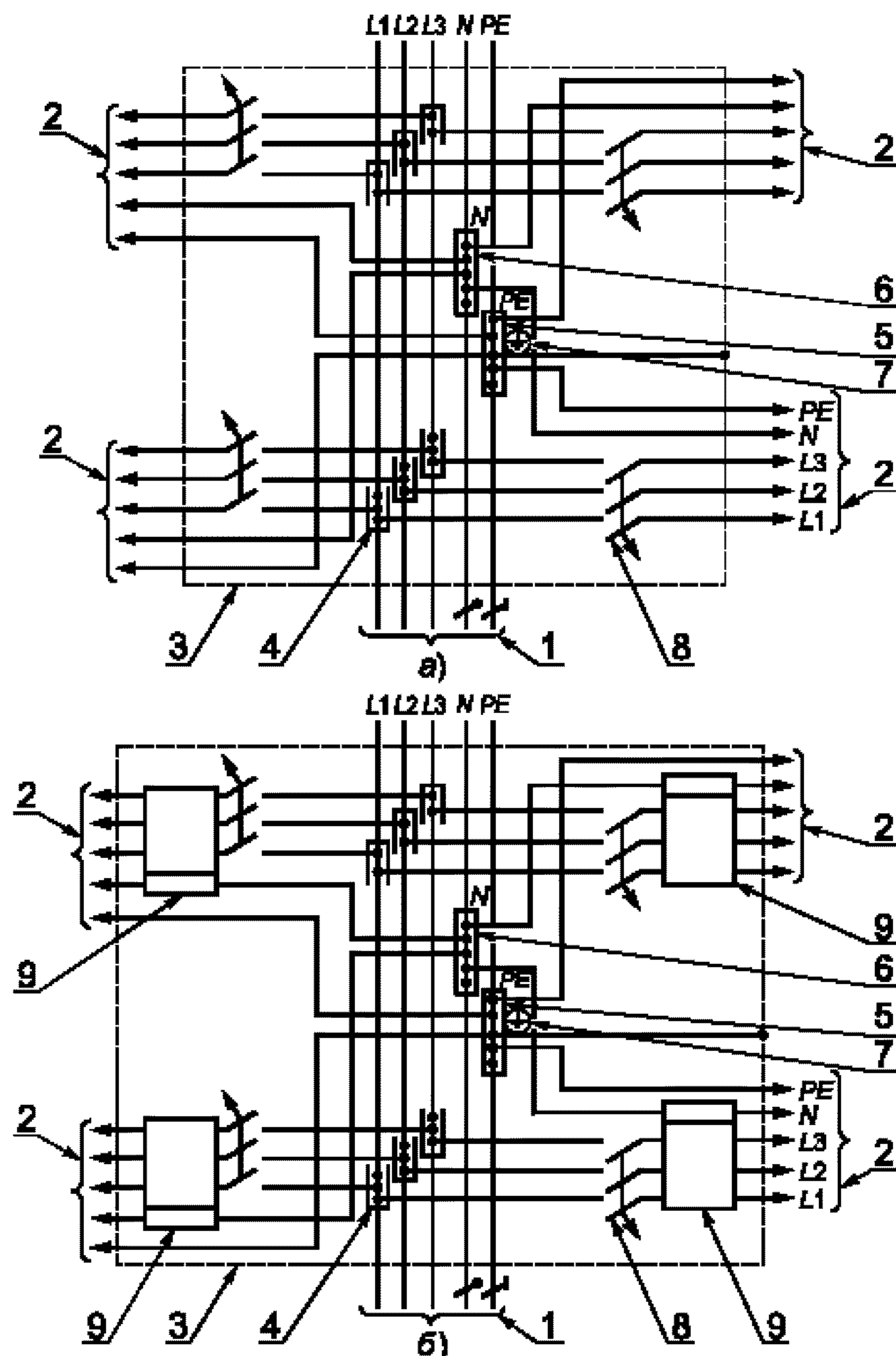
1 — питающая цепь; 2 — распределительная цепь; 3 — проводящая оболочка щитка; 4, 5, 6 — зажимы для проводников питающей цепи (фазных, нулевого защитного РЕ и нулевого рабочего N) и проводников распределительных цепей; 7 — знак заземления у зажима (поз. 6); 8 — автоматические выключатели; 9 — счетчик
