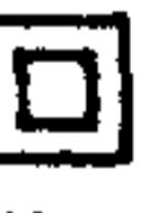
, обозначающий защиту от поражения электрическим током при помощи двойной или усиленной изоляции.
