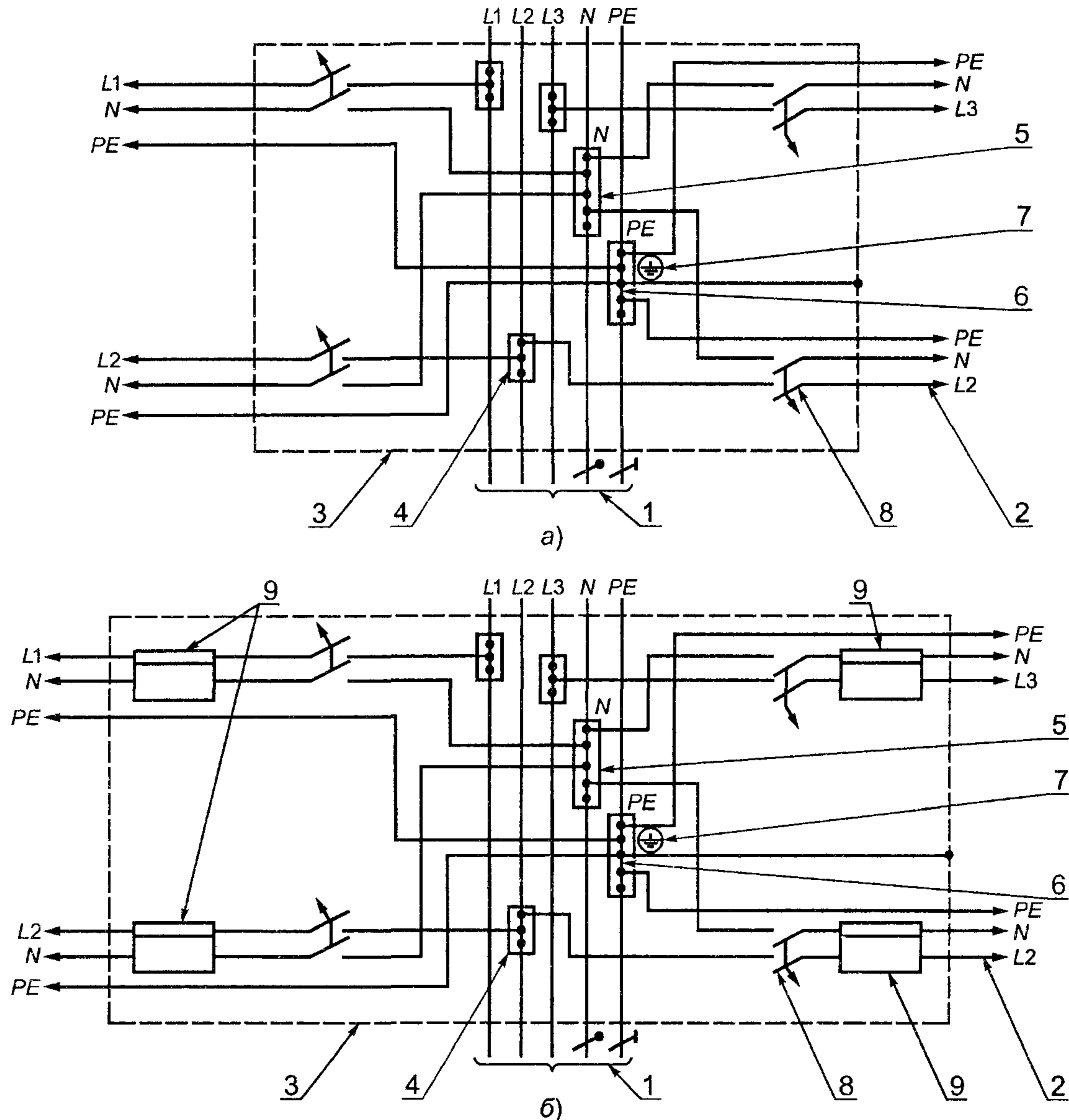
1 — питающая цепь; 2 — распределительная цепь; 3 — проводящая оболочка щитка; 4, 5, 6 — зажимы для проводников питающей цепи (фазных, нулевых защитных  $PE$ , нулевых рабочих  $N$ ) и проводников распределительных цепей; 7 — знак заземления у зажимов (поз. 6); 8 — автоматический выключатель; 9 — счетчик
