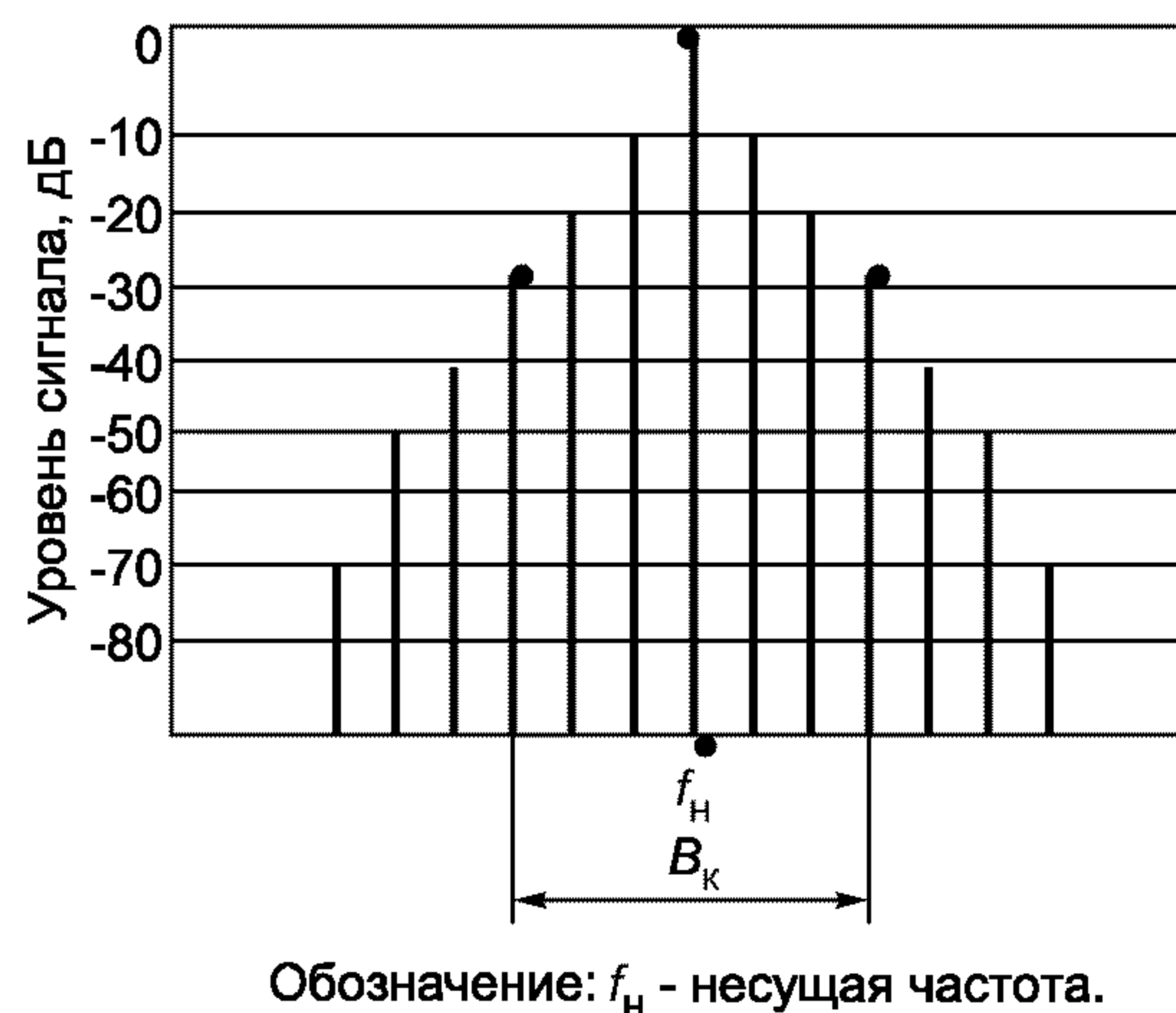
Рисунок 21 — Отсчет контрольной ширины полосы частот B_k на экране анализатора спектра с логарифмическим детектором
