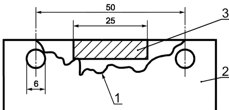
1 — участок пластинки, покрытый средством защиты; 2 — металлическая пластинка;
