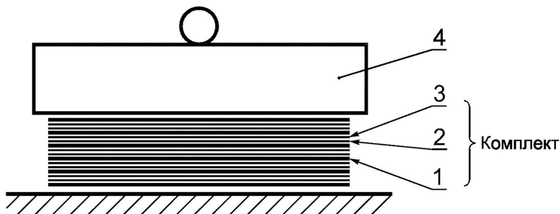
1 — металлическая пластинка; 2 — образец испытываемой бумаги;
