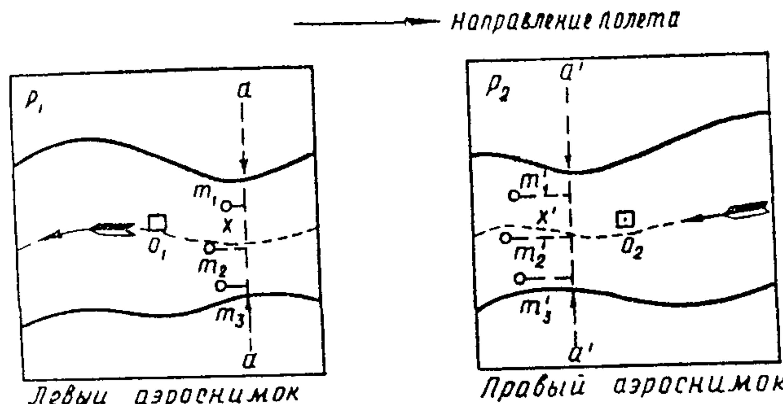
Рис. 1 Изображение поверхностных поплавков на смежных аэрофотоснимках
