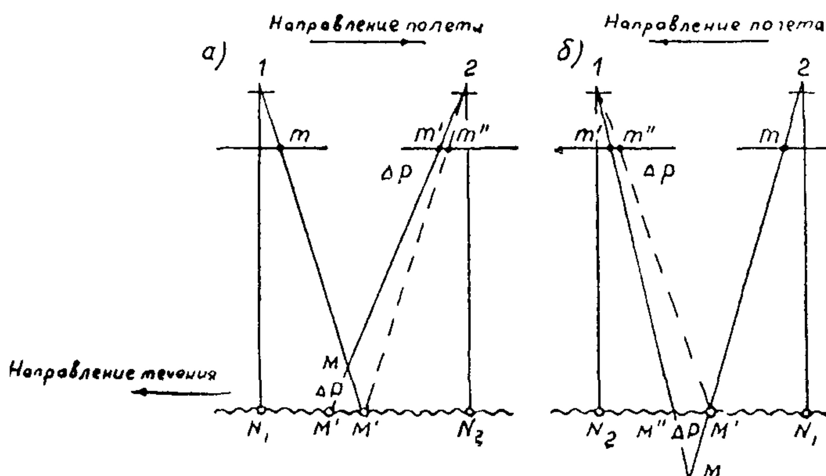
Рис. 2. Схема стереофотограмметрического измерения скорости течения:
