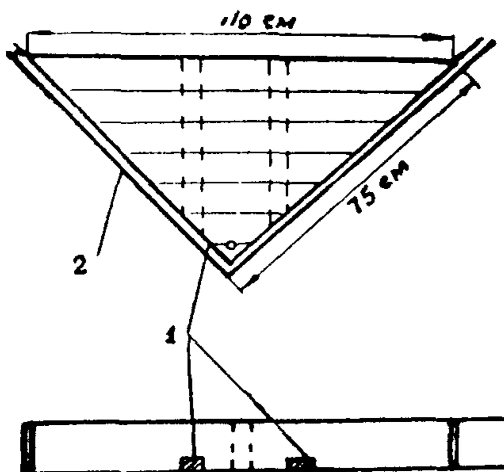
Рис 3 Деревянные щитовые буйки
