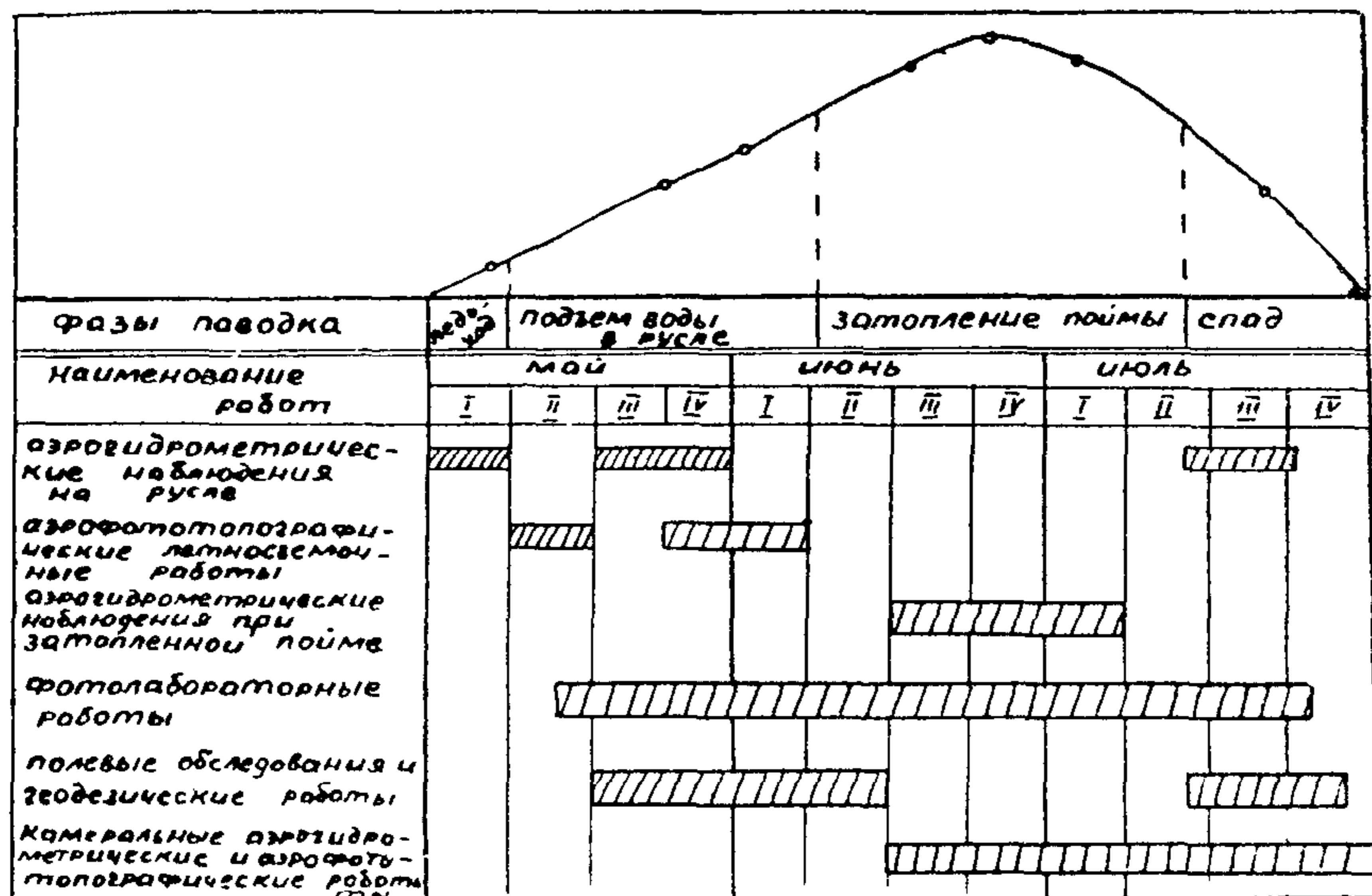
Рис. 14 Технологическая схема аэрогидрометрических работ
