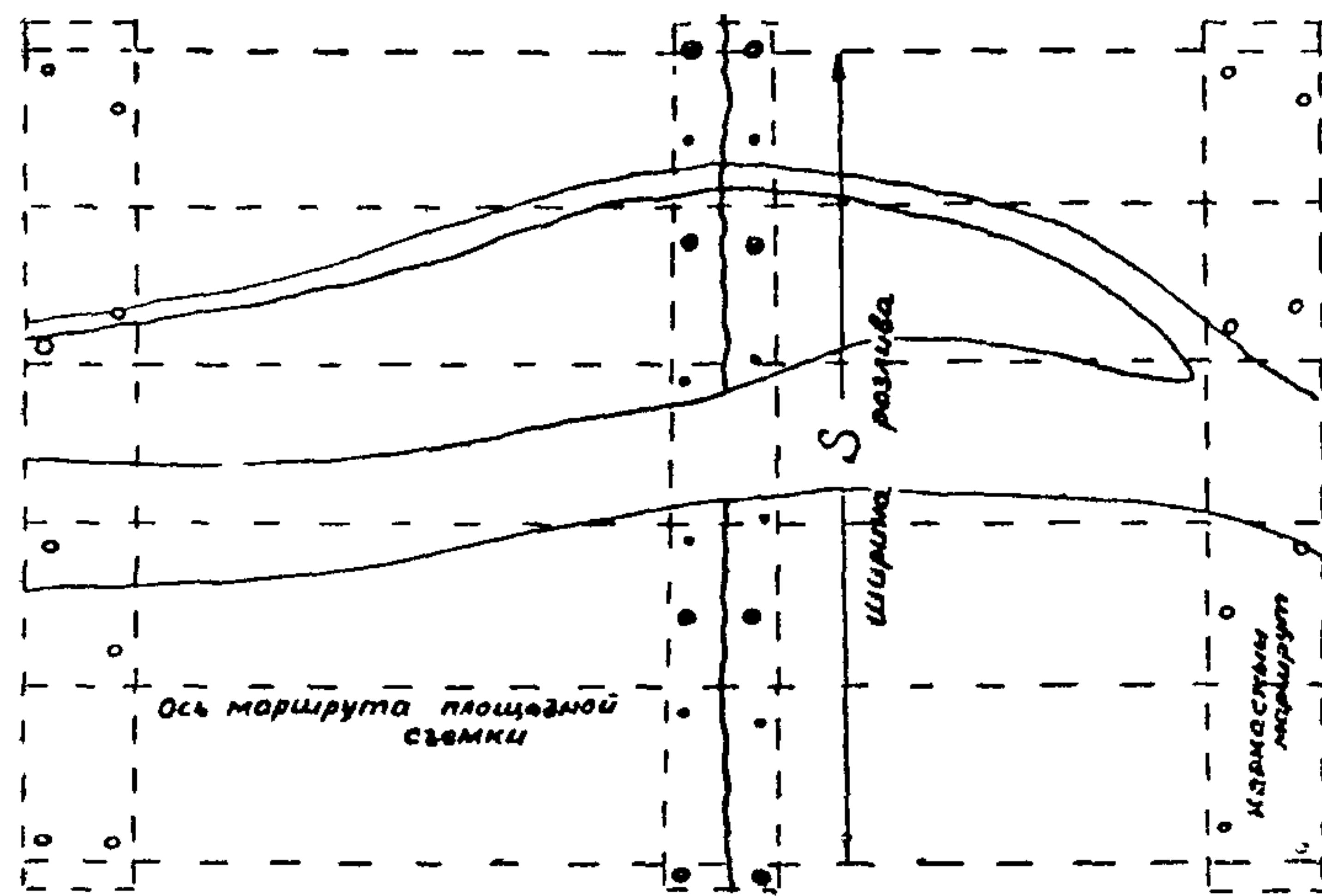
Рис. 9. Схема геодезического обоснования генерального плана перехода в необжитом районе
