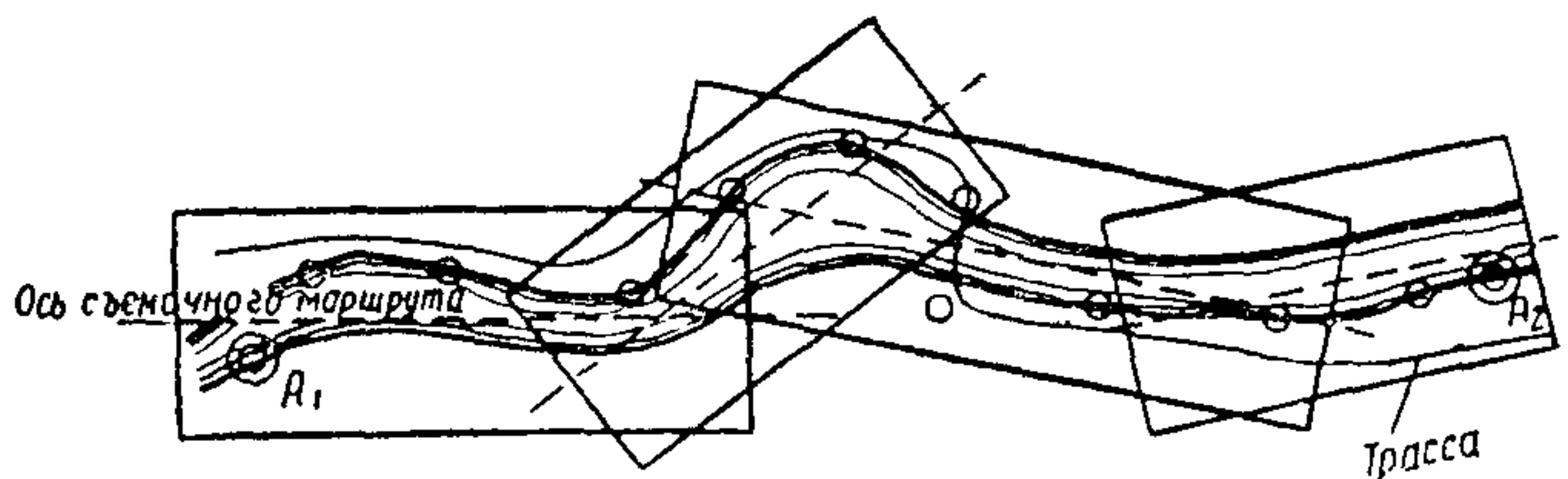
Рис. 15. Схема аэрофотосъемки долинного хода и размещения высотных опознавателей
