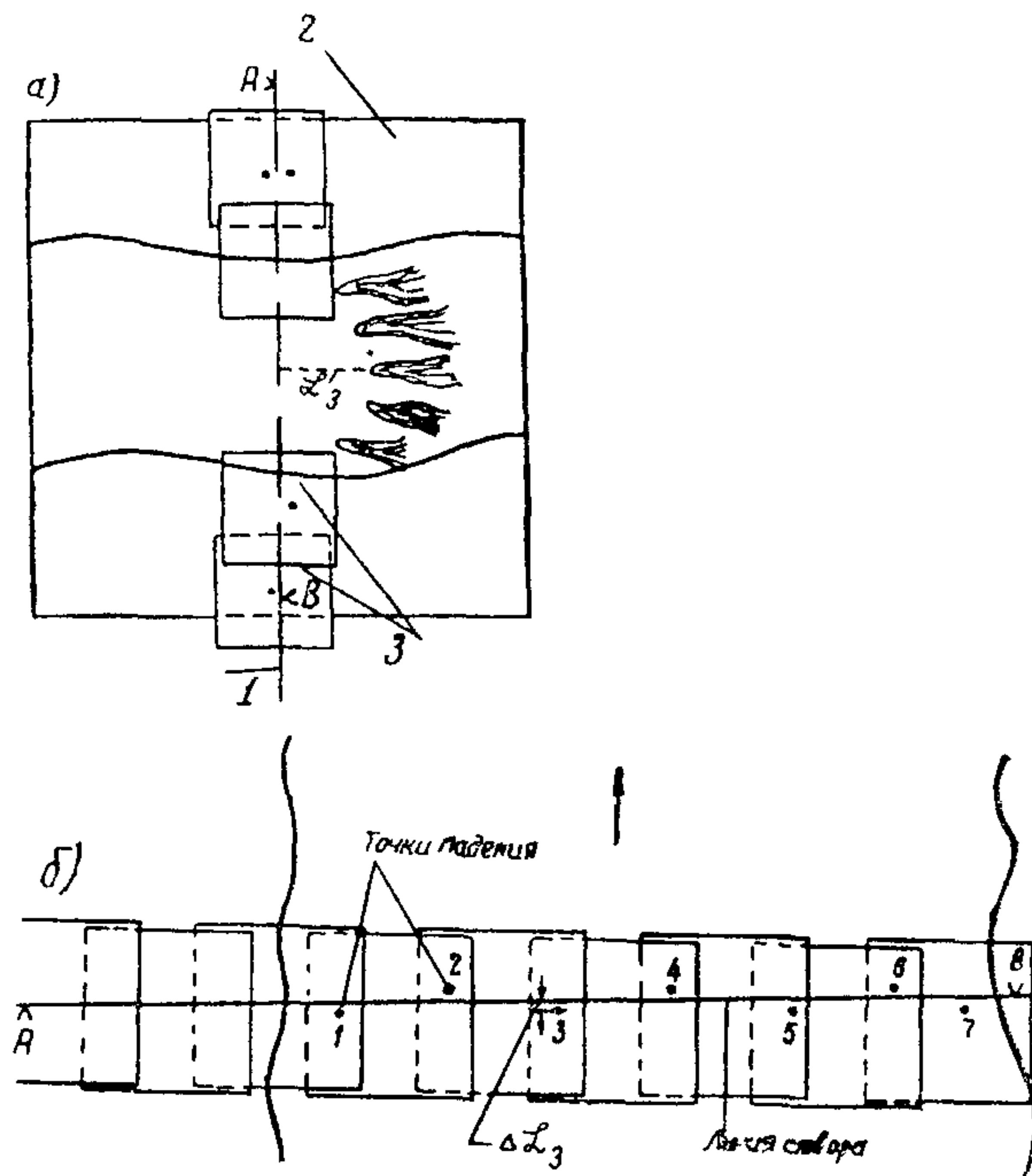
Рис. 5. Схема расположения аэроснимков на створе наблюдений:
