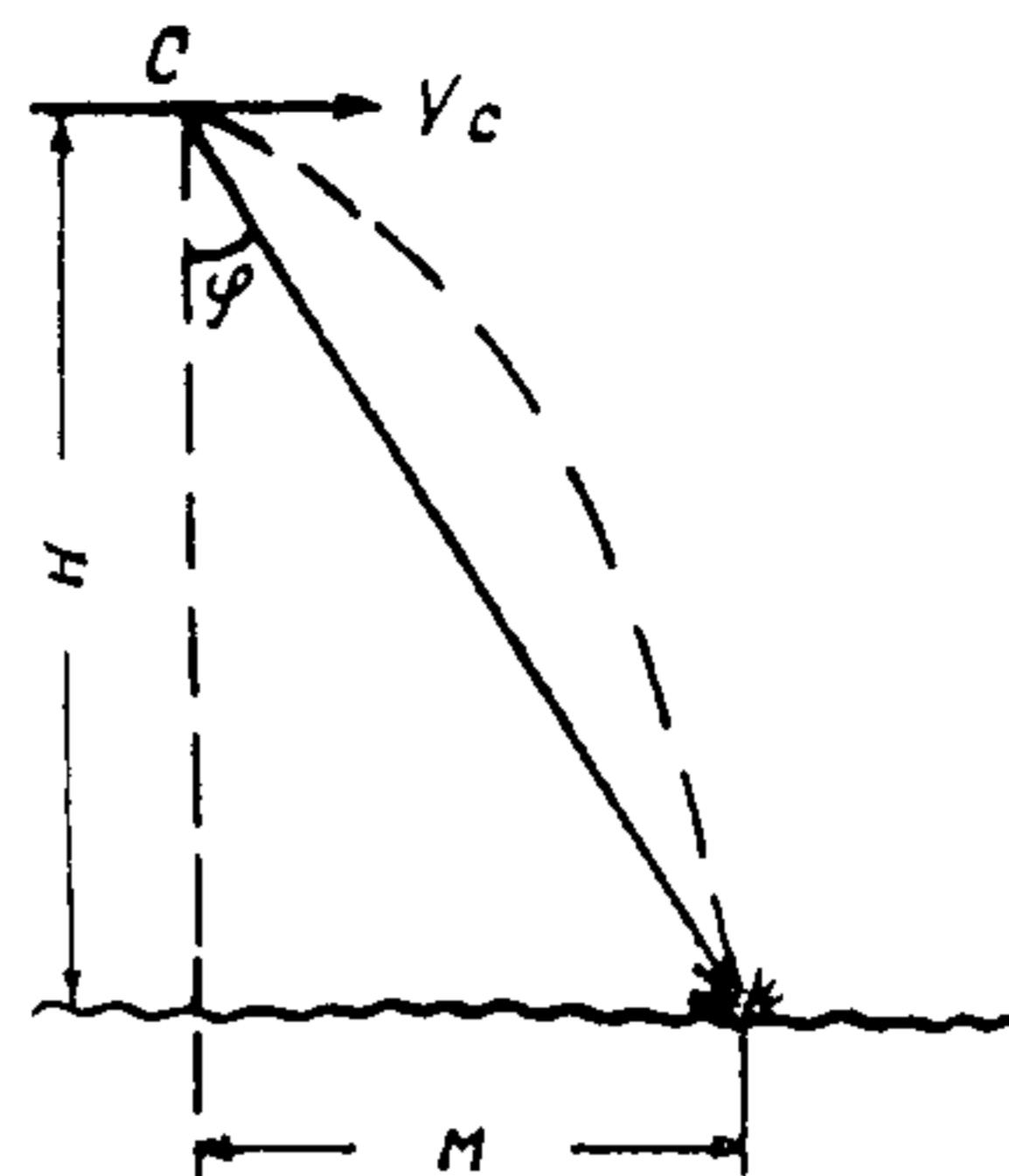
Рис. 4. Элементы, определяемые при сбрасывании судов с индикатором
