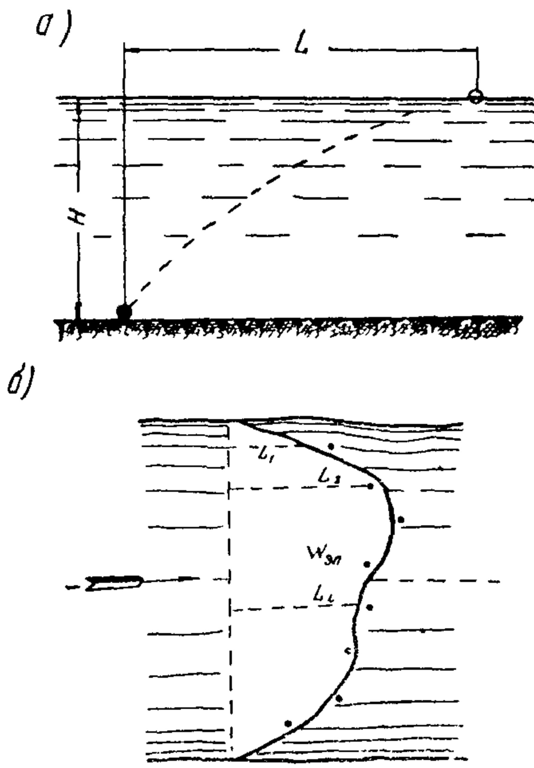
Рис 3 Определение расхода воды методом поплавков-интеграторов
