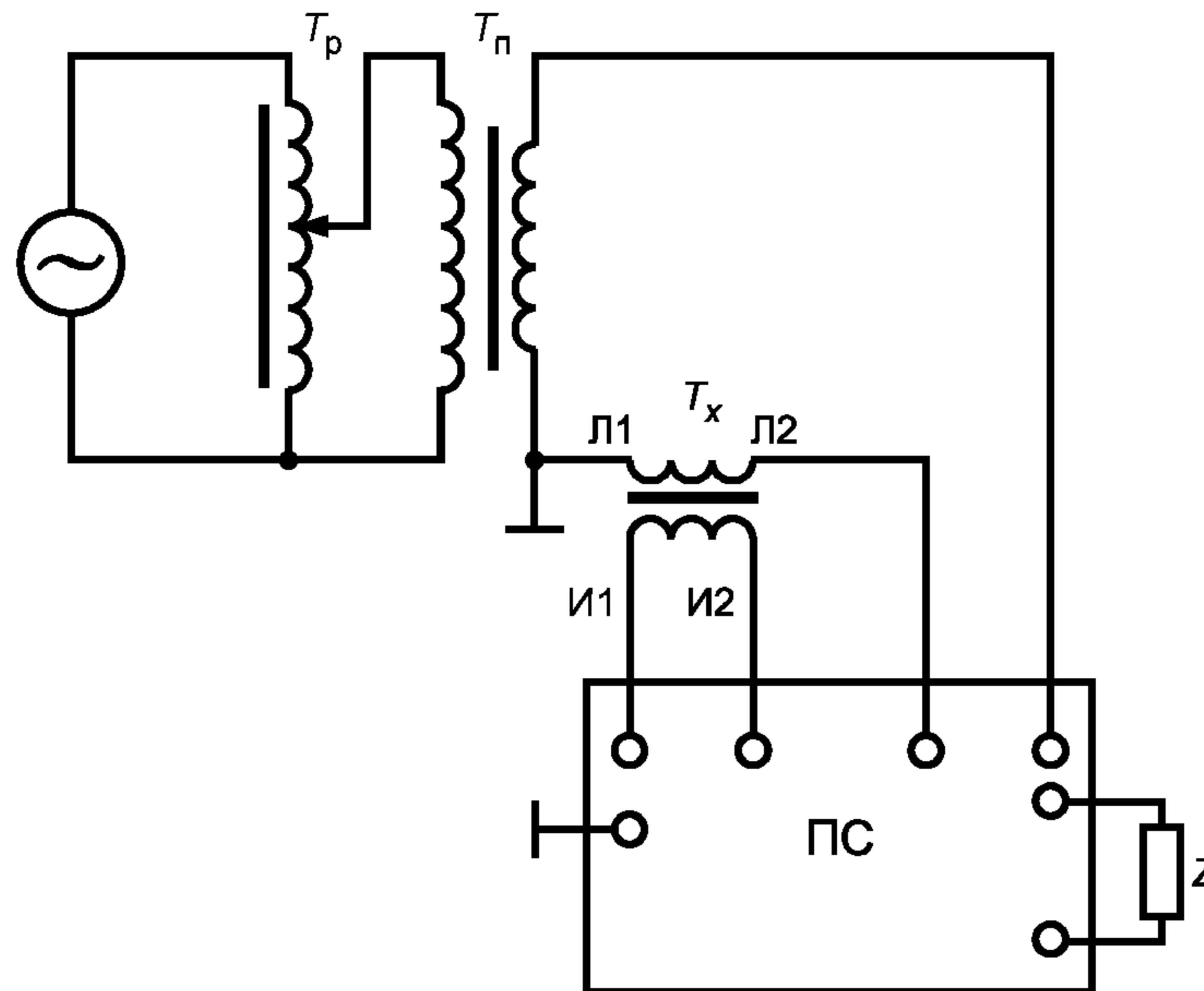
$\sim$  — сеть (генератор);  $T_p$  — регулирующее устройство (автотрансформатор);  $T_\pi$  — понижающий силовой трансформатор;  $T_x$  — поверяемый трансформатор тока;  $L_1$ ,  $L_2$  — контактные зажимы первичной обмотки;  $I_1$ ,  $I_2$  — контактные зажимы вторичной обмотки;  $Z$  — нагрузка;  $\Pi C$  — прибор сравнения типа К-535
