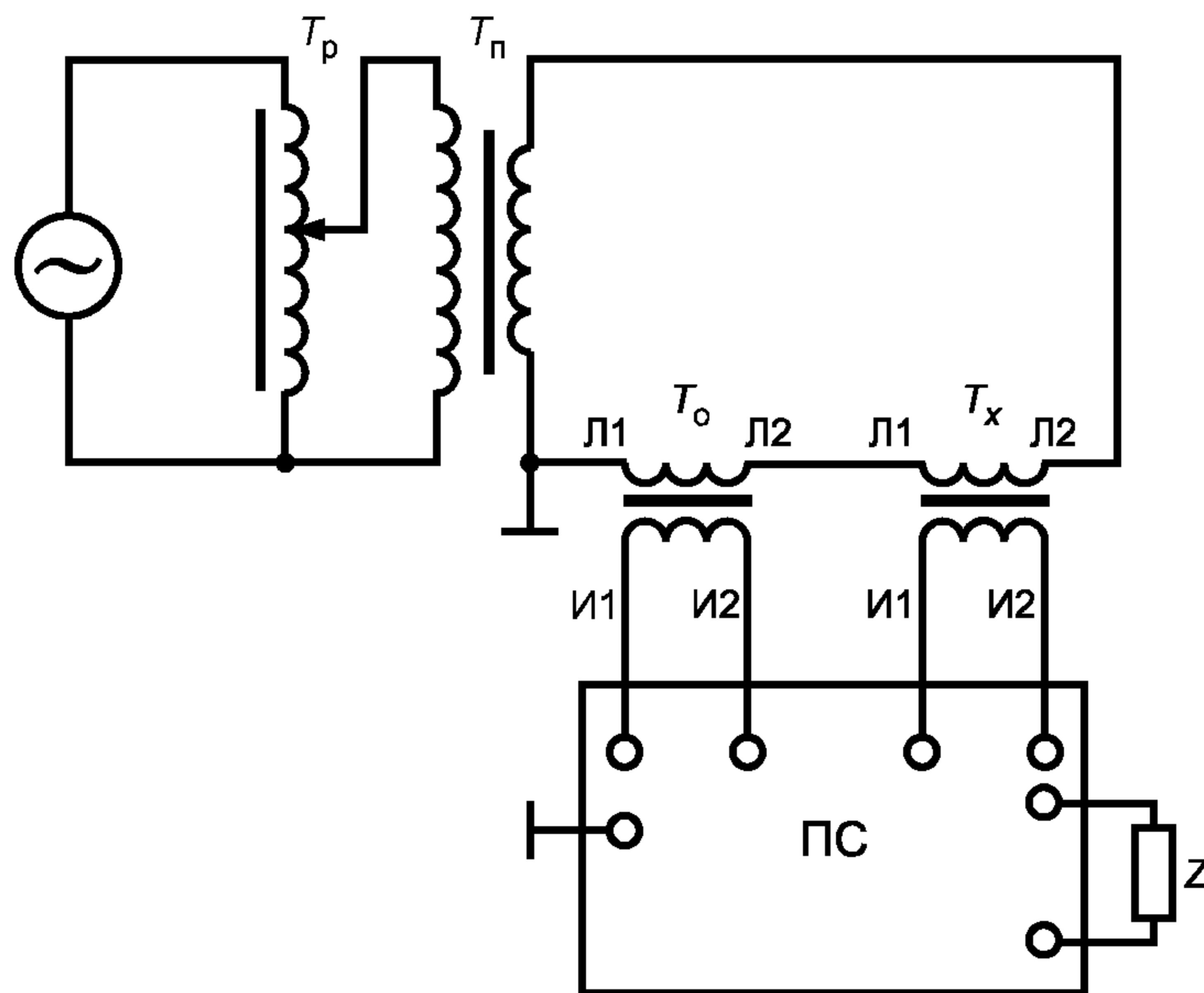
$\sim$  — сеть (генератор);  $T_p$  — регулирующее устройство (автотрансформатор);  $T_\pi$  — понижающий силовой трансформатор;  $T_o$  — рабочий эталон;  $T_x$  — поверяемый трансформатор тока;  $L_1$ ,  $L_2$  — контактные зажимы первичной обмотки;  $I_1$ ,  $I_2$  — контактные зажимы вторичной обмотки;  $Z$  — нагрузка;  $\Pi C$  — прибор сравнения
