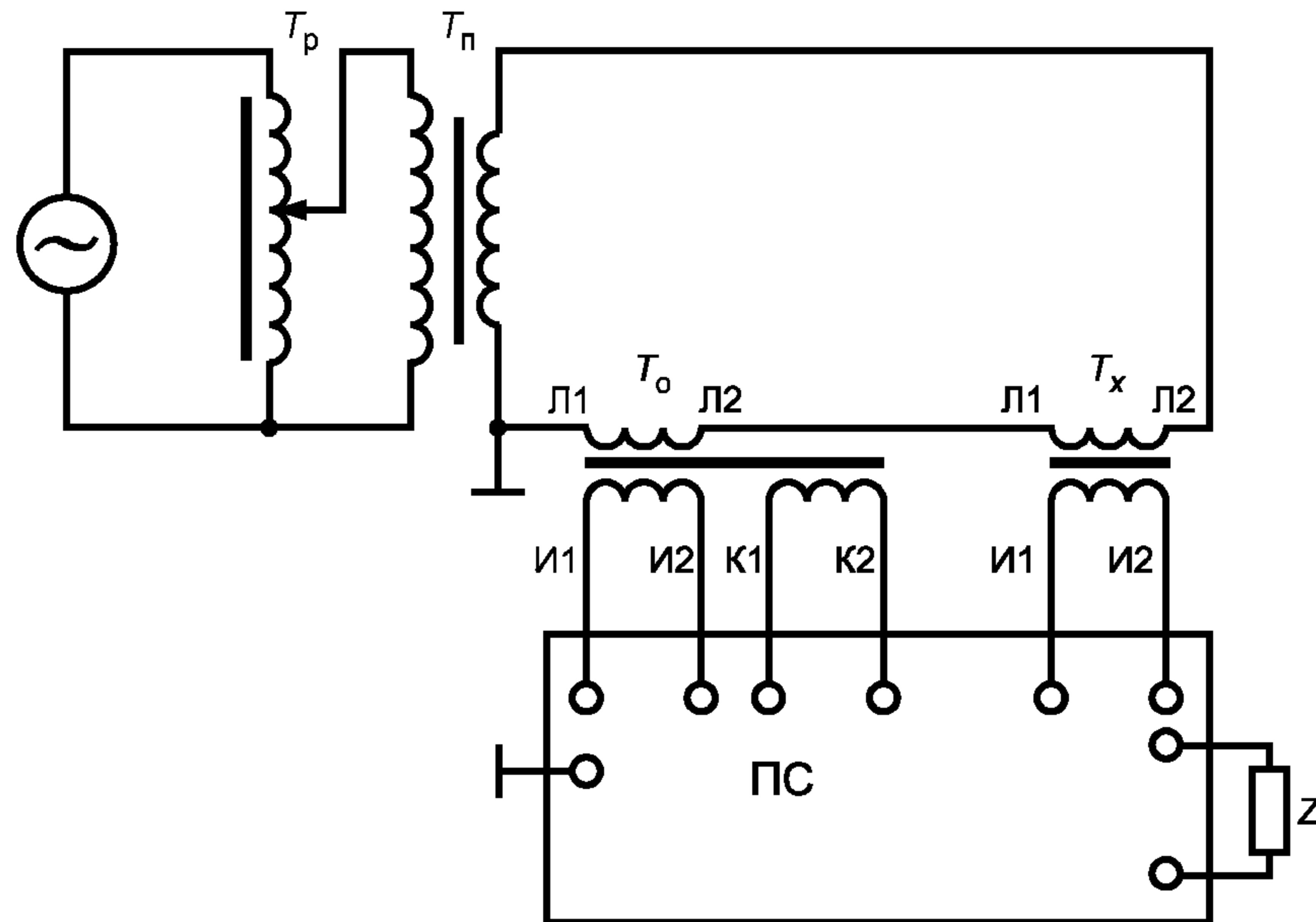
~ — сеть (генератор);  $T_p$  — регулирующее устройство (автотрансформатор);  $T_n$  — понижающий силовой трансформатор;  $T_o$  — рабочий эталон;  $T_x$  — поверяемый трансформатор тока;  $L_1$ ,  $L_2$  — контактные зажимы первичной обмотки;  $I_1$ ,  $I_2$  — контактные зажимы вторичной обмотки;  $K_1$ ,  $K_2$  — контактные зажимы дополнительной вторичной обмотки;  $Z$  — нагрузка; ПС — прибор сравнения типа КТ-01
