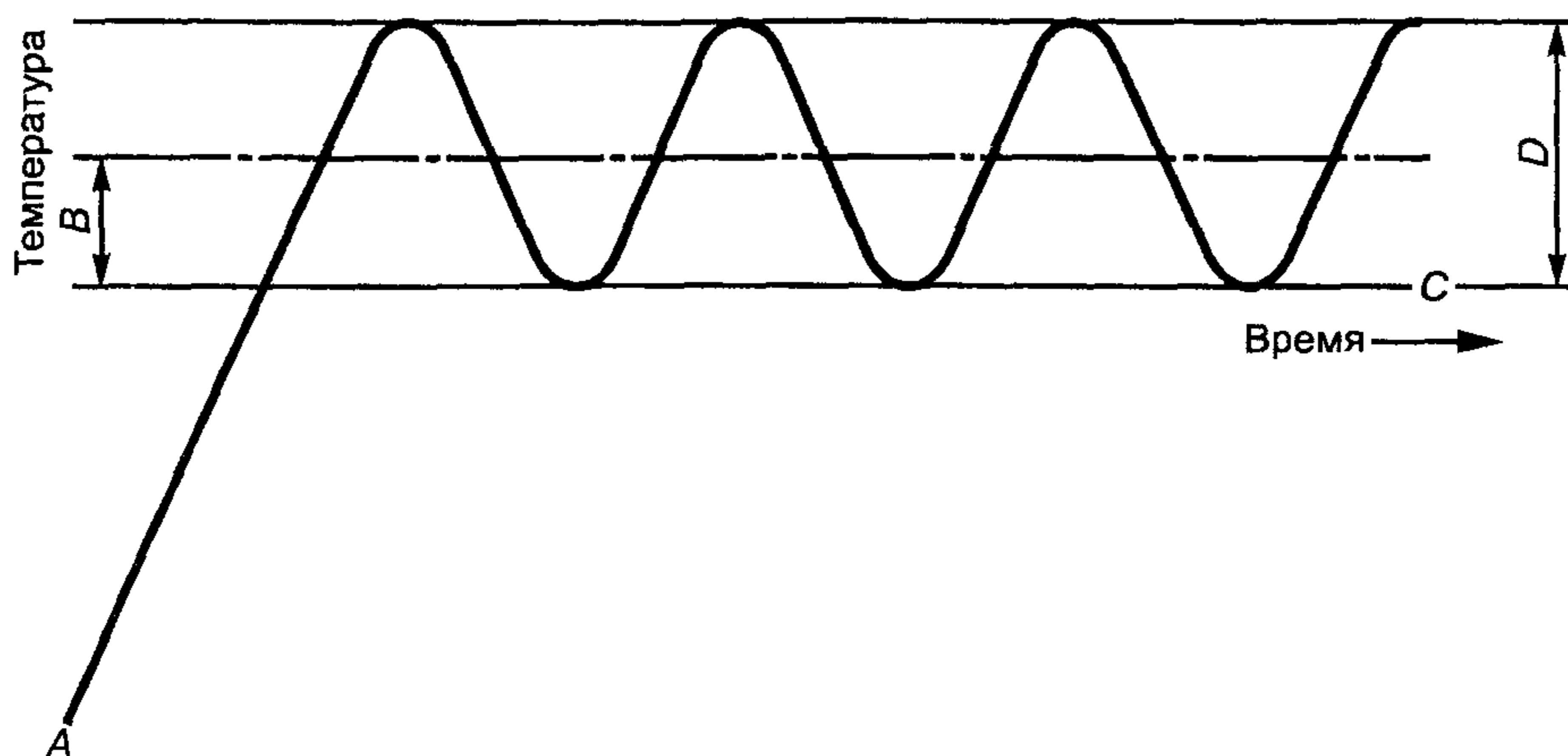
*A* — зарегистрированная температура; *B* — максимальное допустимое отклонение;
