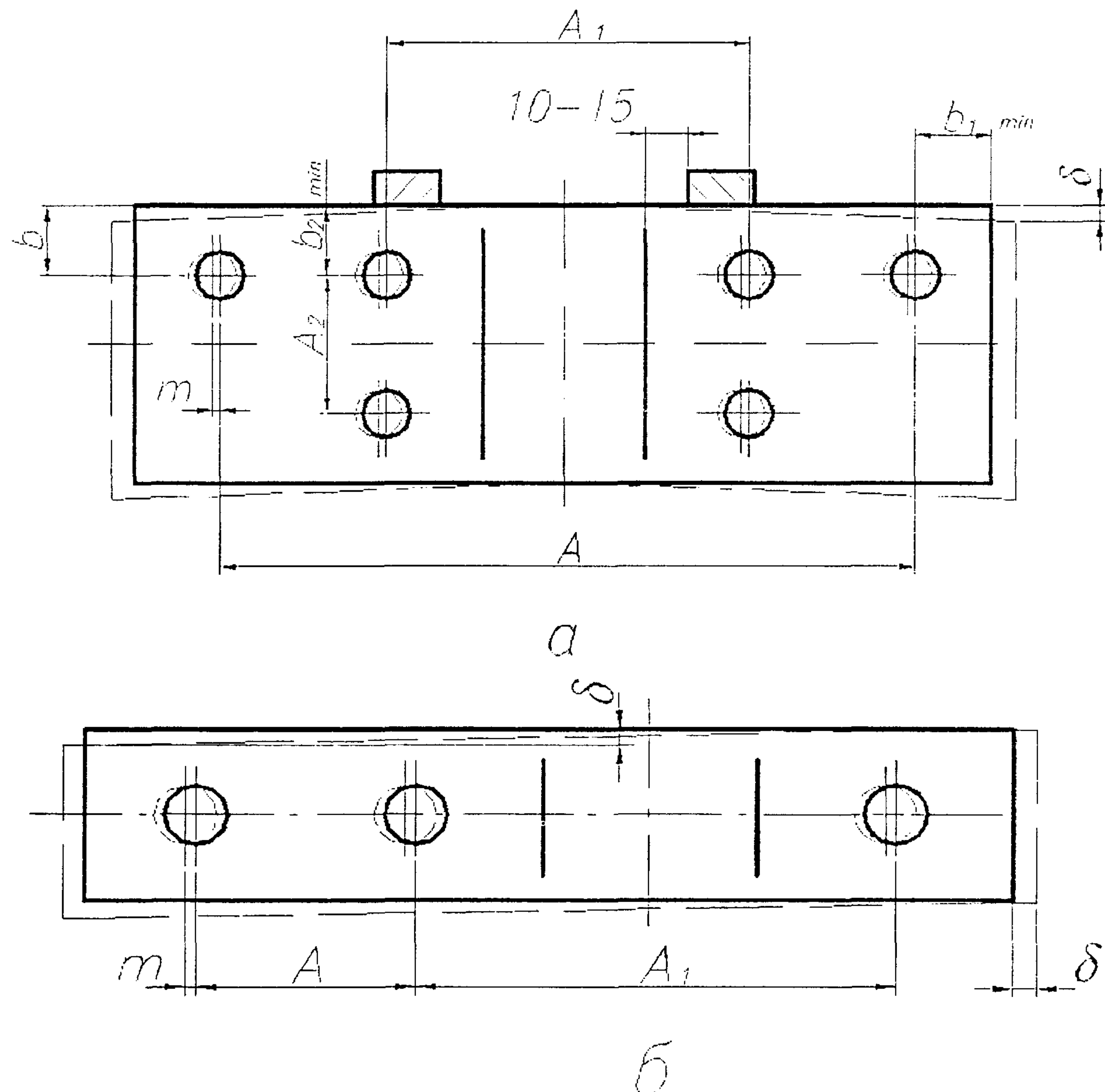
*a* – полухомуты для вертикальных трубопроводов; *б* – полухомуты для горизонтальных трубопроводов
