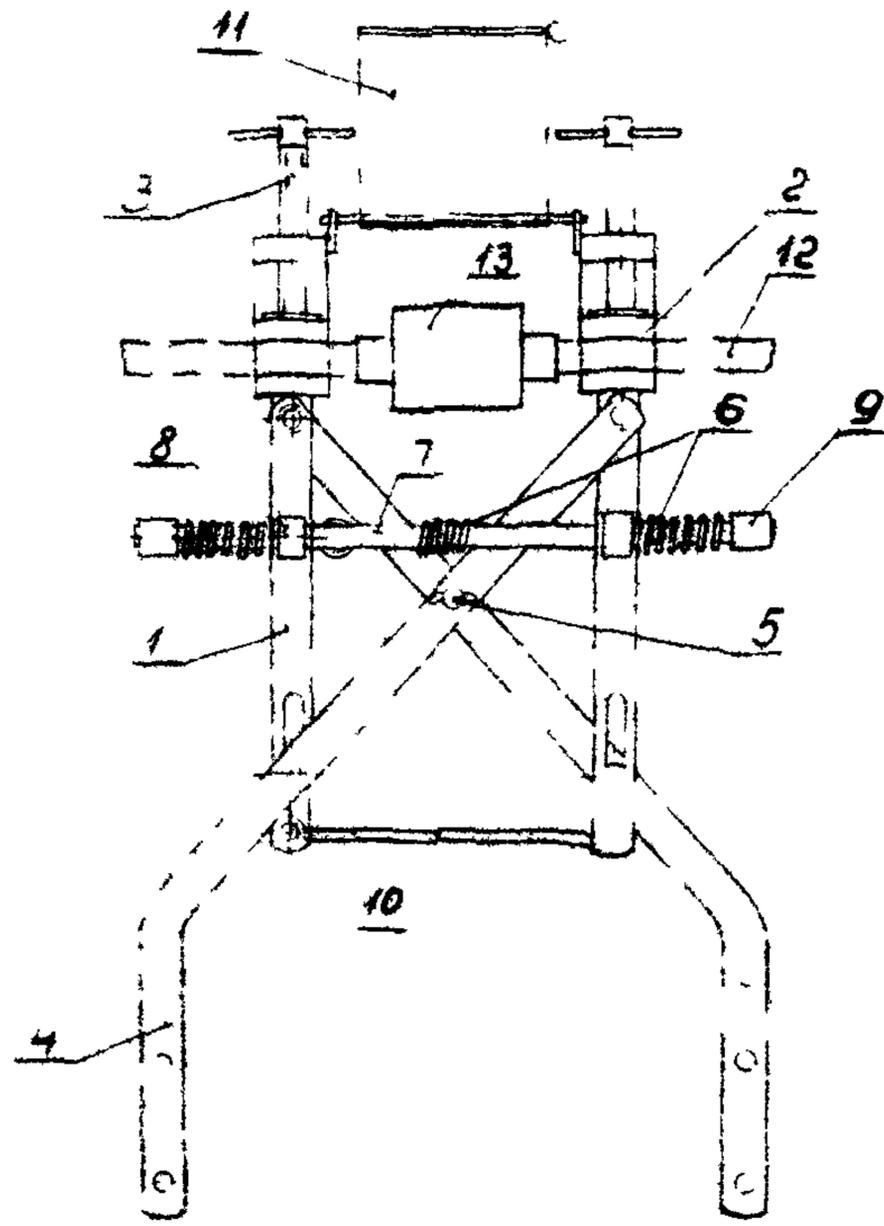
Приспособления „ПСП-2“ и „ПСП 3“ для сварки проводов
