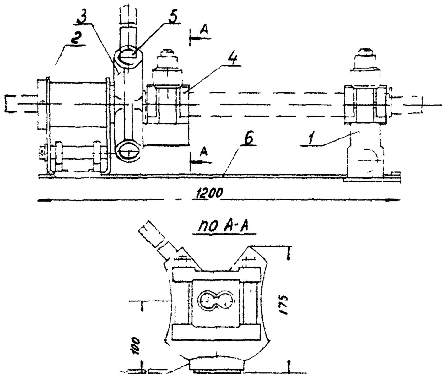
Приспособление МЦ-230А для скручивания
