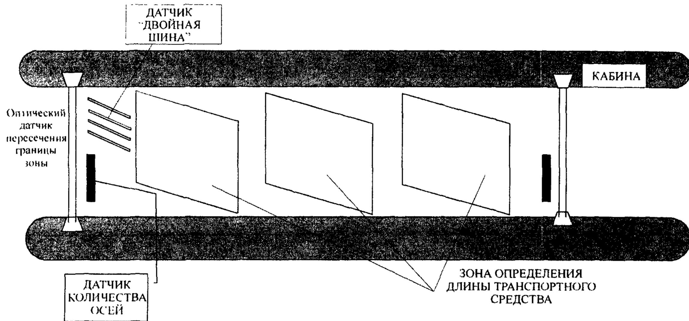
Рис.1. Схема зоны автоматического распознавания транспортных средств
