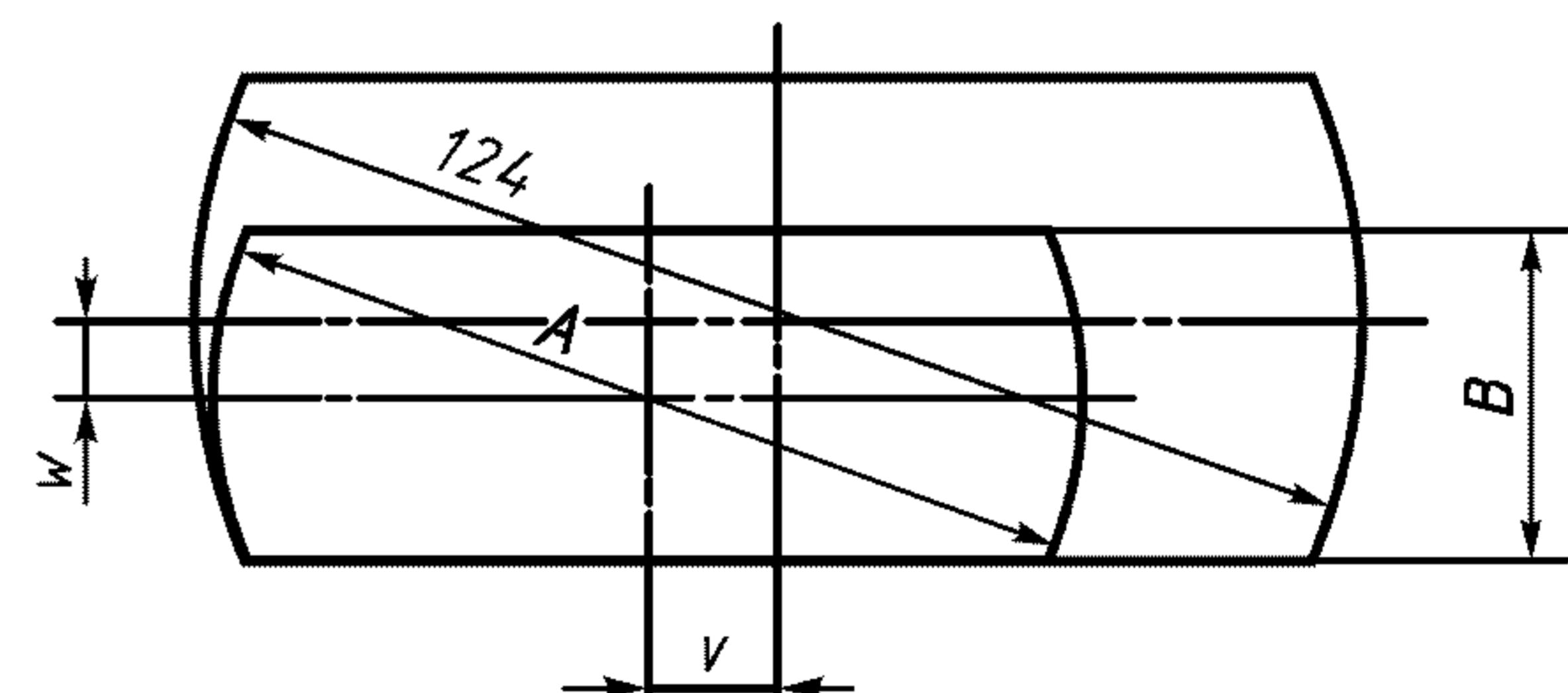
А — симметричный допуск для  $S_t$  в продольном направлении; В — симметричный допуск для  $P_t$  в поперечном направлении;  $w$  и  $v$  — эксцентрикитеты
