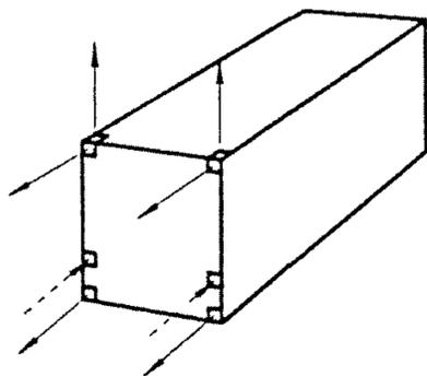
Рисунок 12 — Подъем за торцевые угловые фитинги (способ 2)
