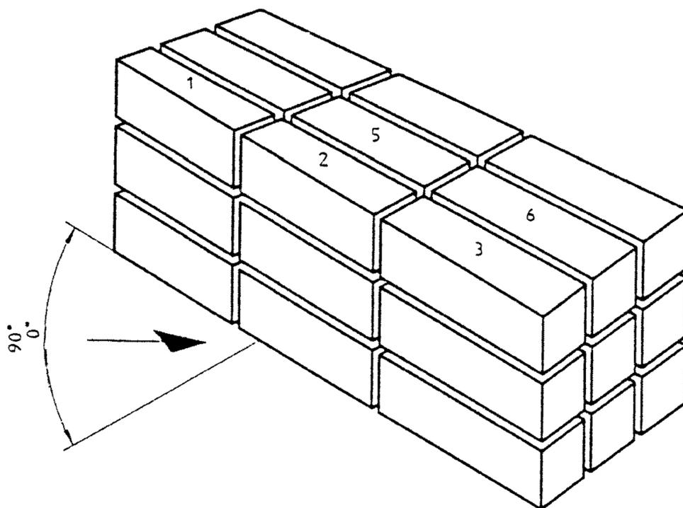
Рисунок 15 — Схема действия ветровых нагрузок на блок контейнеров
