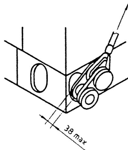
Рисунок 6 — Крепление стропа к нижнему угловому фитингу
