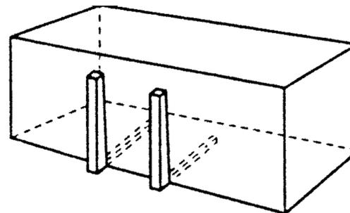
Рисунок 14 — Подъем вилочным захватом
