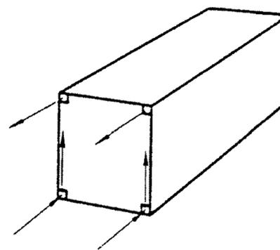
Рисунок 11 — Подъем за торцевые угловые фитинги (способ 1)
