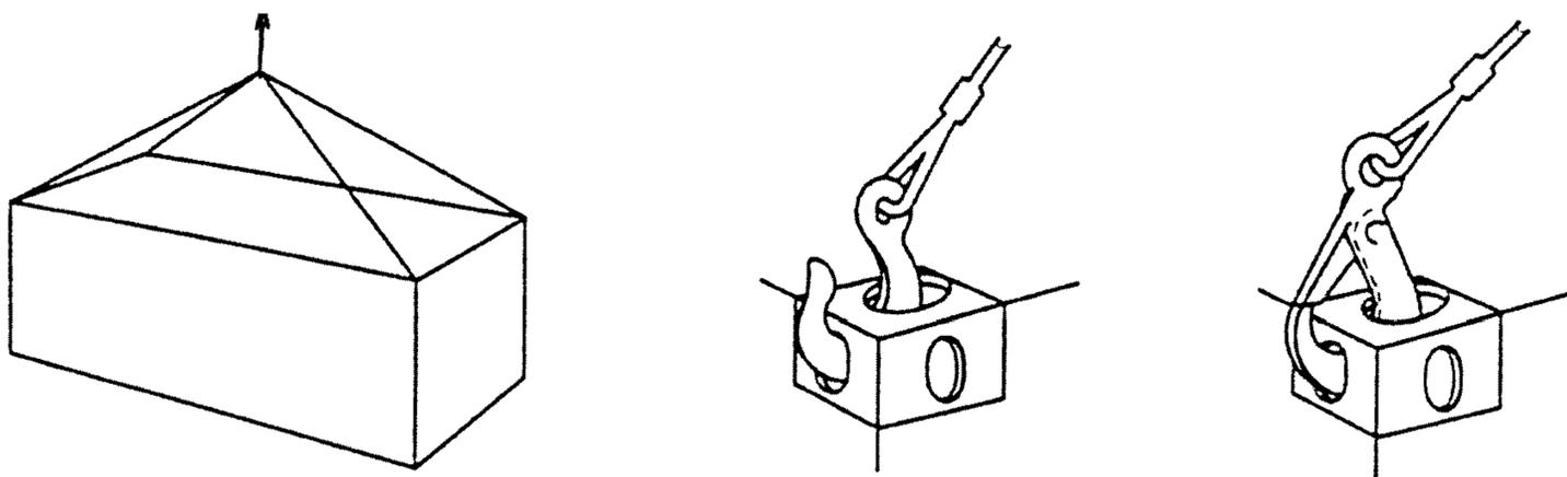
Рисунок 3 — Подъем стропами за верхние угловые фитинги
