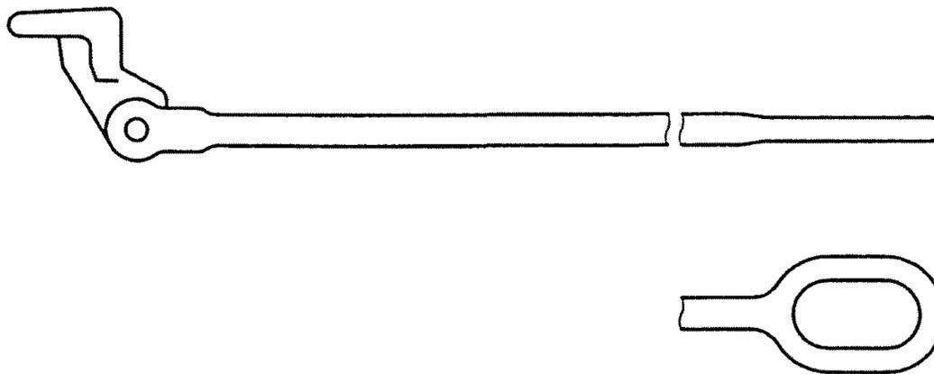
Рисунок Г.4 — Контейнерная штанга с шарнирным оголовком
