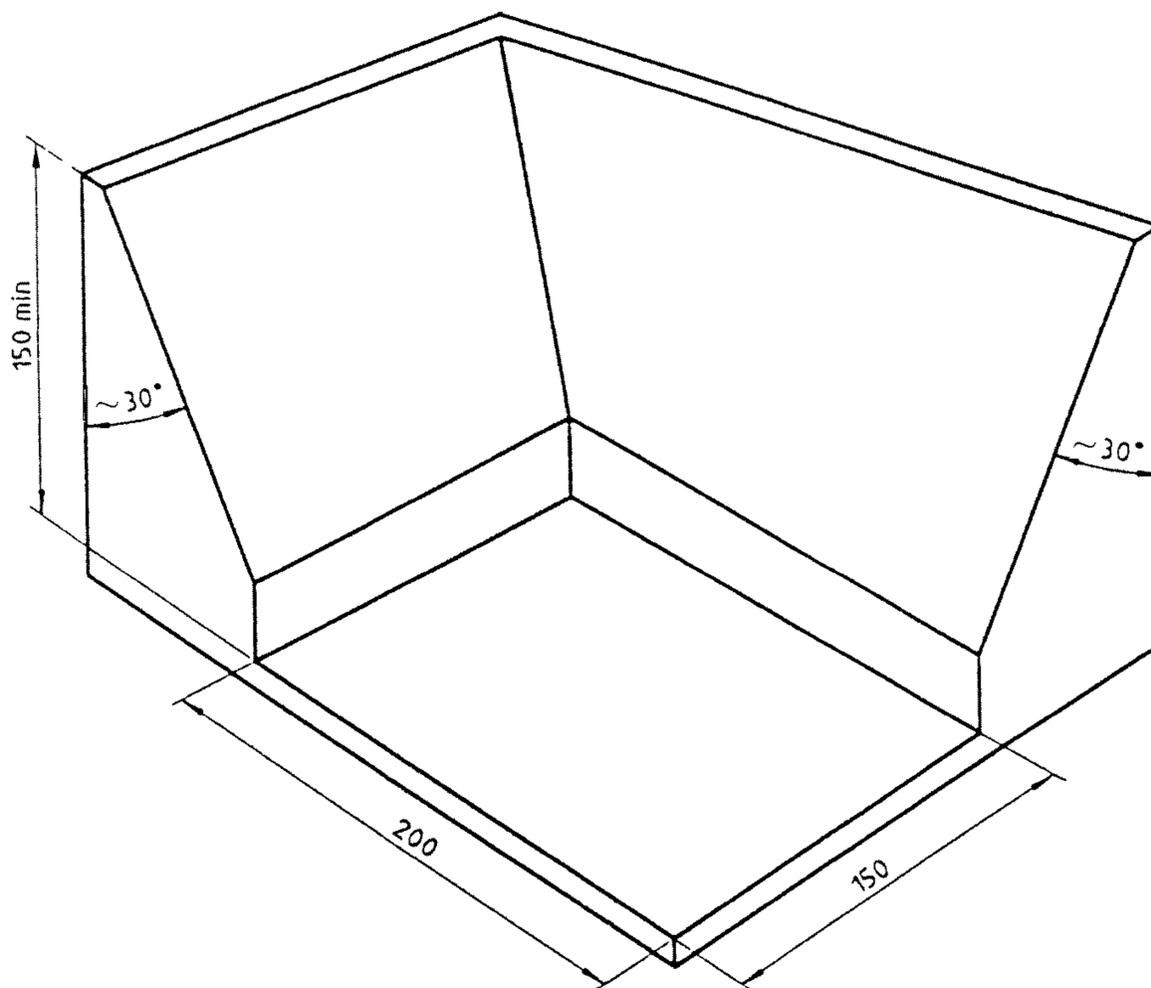
Рисунок 23 — Пример уголковой направляющей с горизонтальным упором
