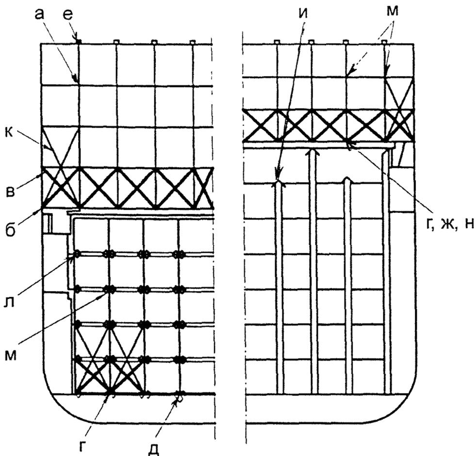
Рисунок 21 — Пример типового оборудования для крепления контейнеров
