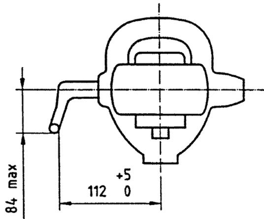
Рисунок Б.5 — Длина рукоятки, работающей в вертикальной плоскости
