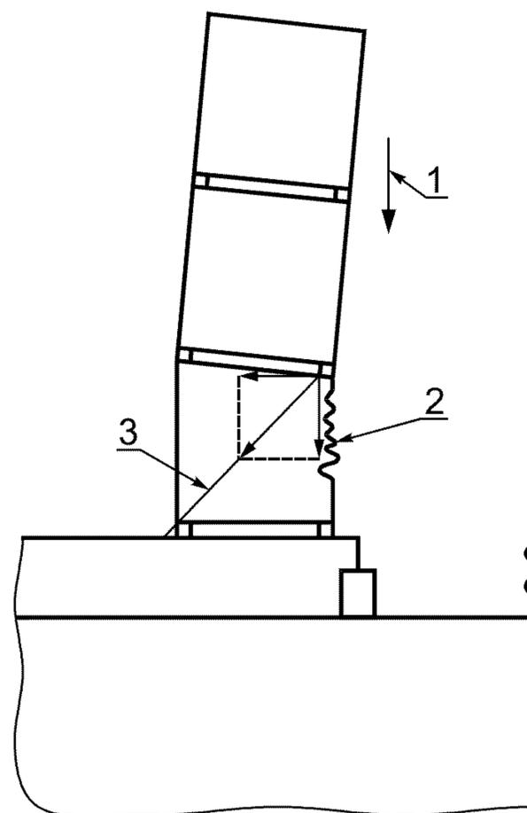
1 — сила сжатия; 2 — разрушение; 3 — найтов
