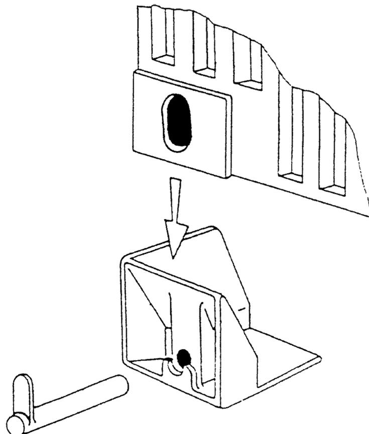
Рисунок 27 — Угловой направляющий ограничитель со стопорным пальцем
