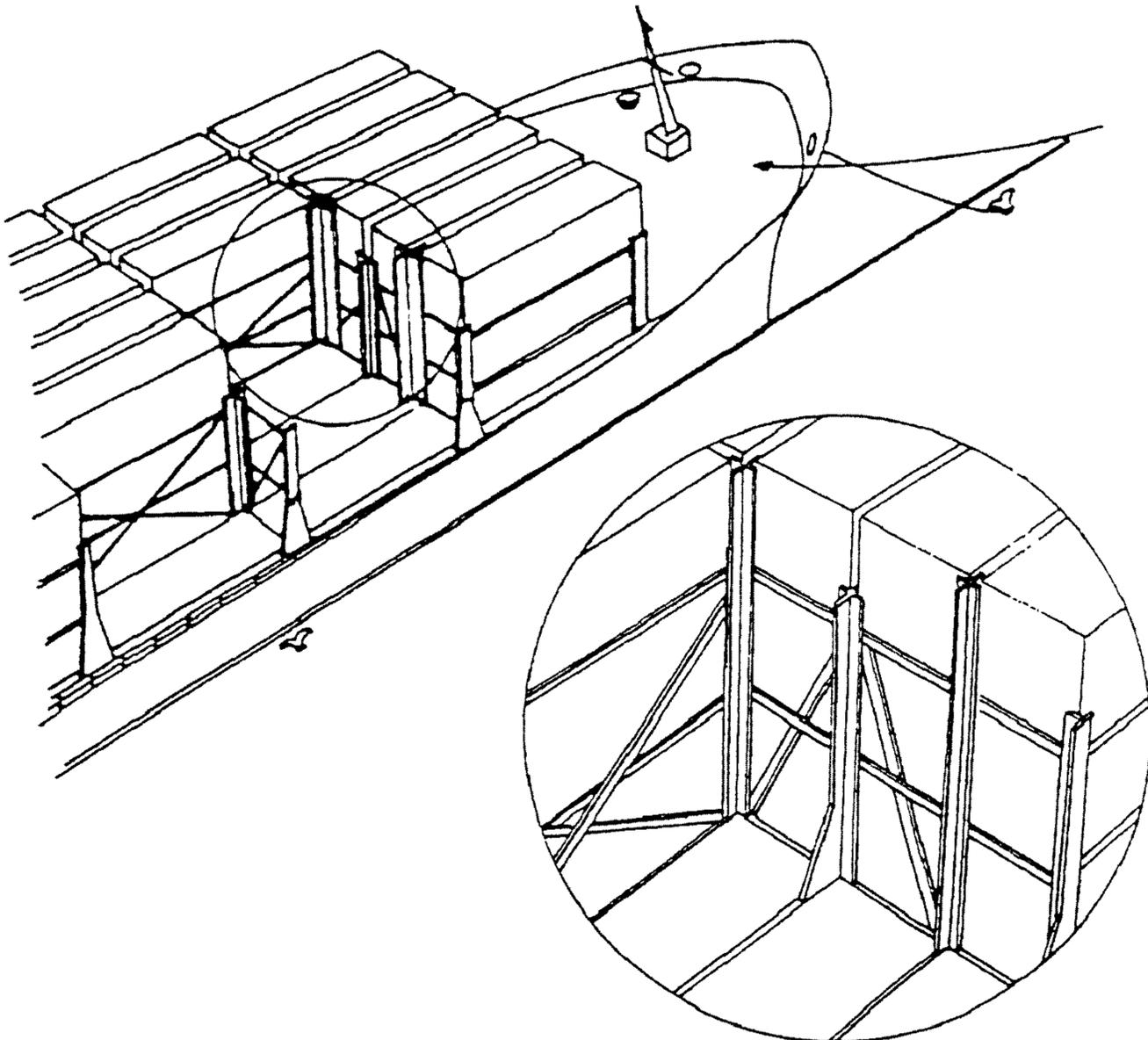
Рисунок 19 — Пример палубных направляющих, образующих ячейки
