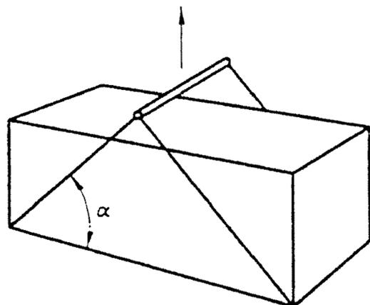
Рисунок 5 — Подъем стропами за нижние угловые фитинги
