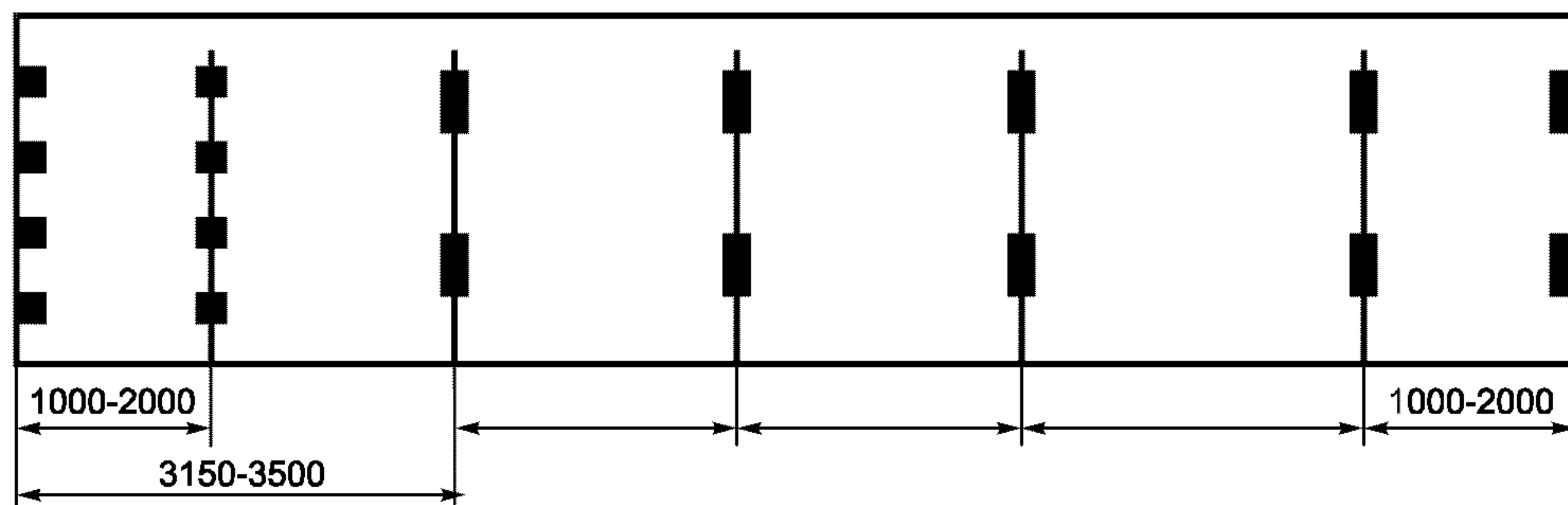
Рисунок Б.9\* — Требования к контейнерам, имеющим 7 пар опорных площадок
