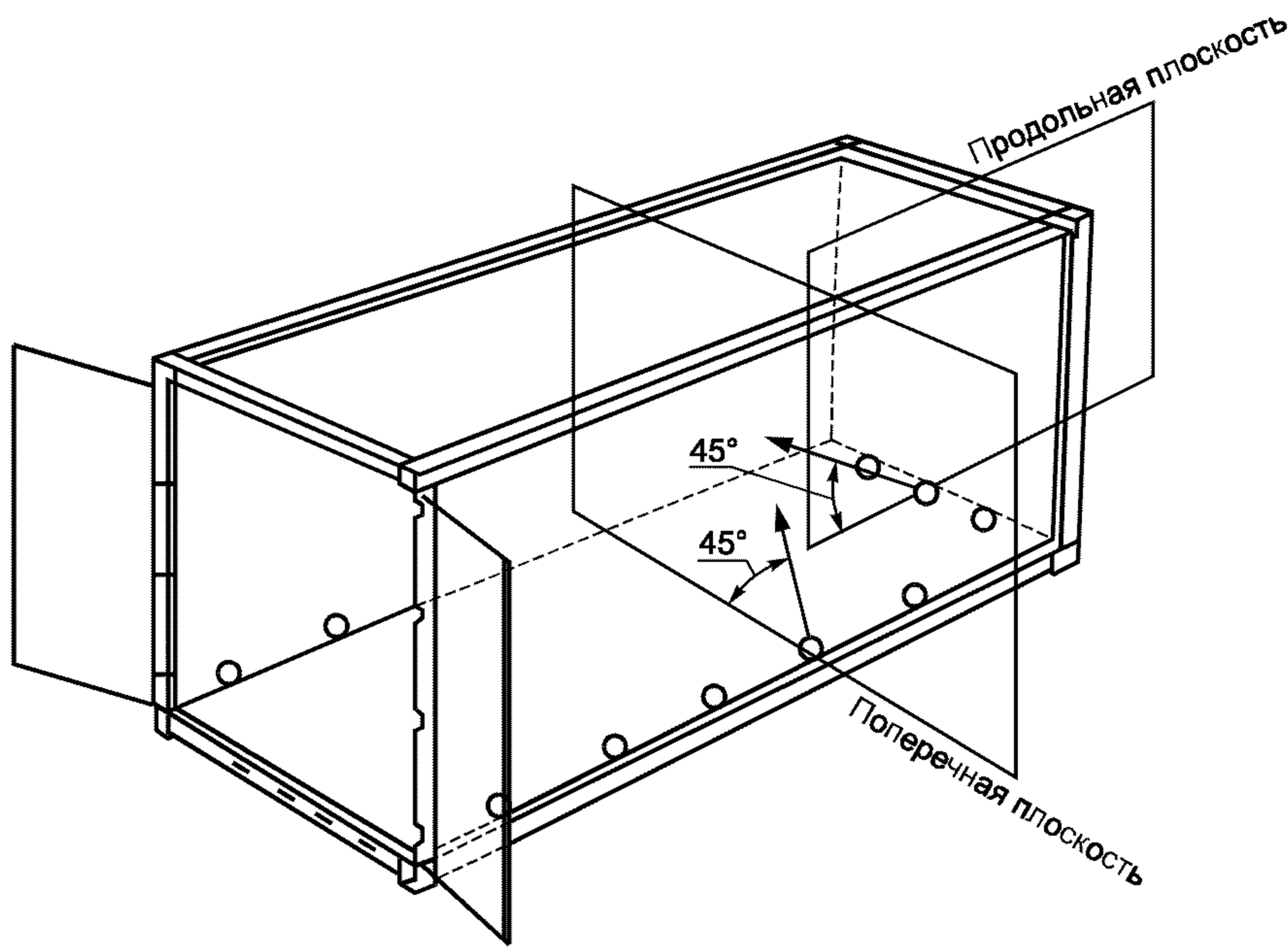
Рисунок Д.1 — Схемы приложения испытательных сил
