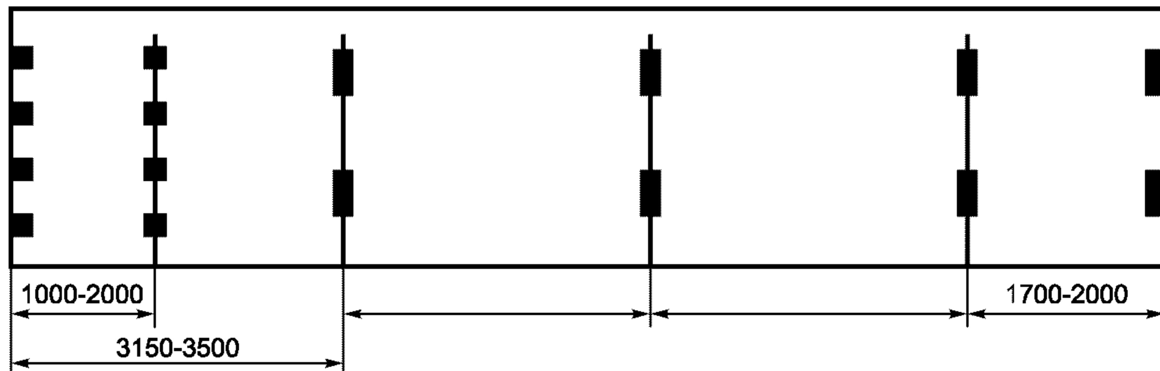
Рисунок Б.8\* — Минимальные требования: 6 пар опорных площадок (1 пара на каждый торец плюс 4 промежуточные пары)
