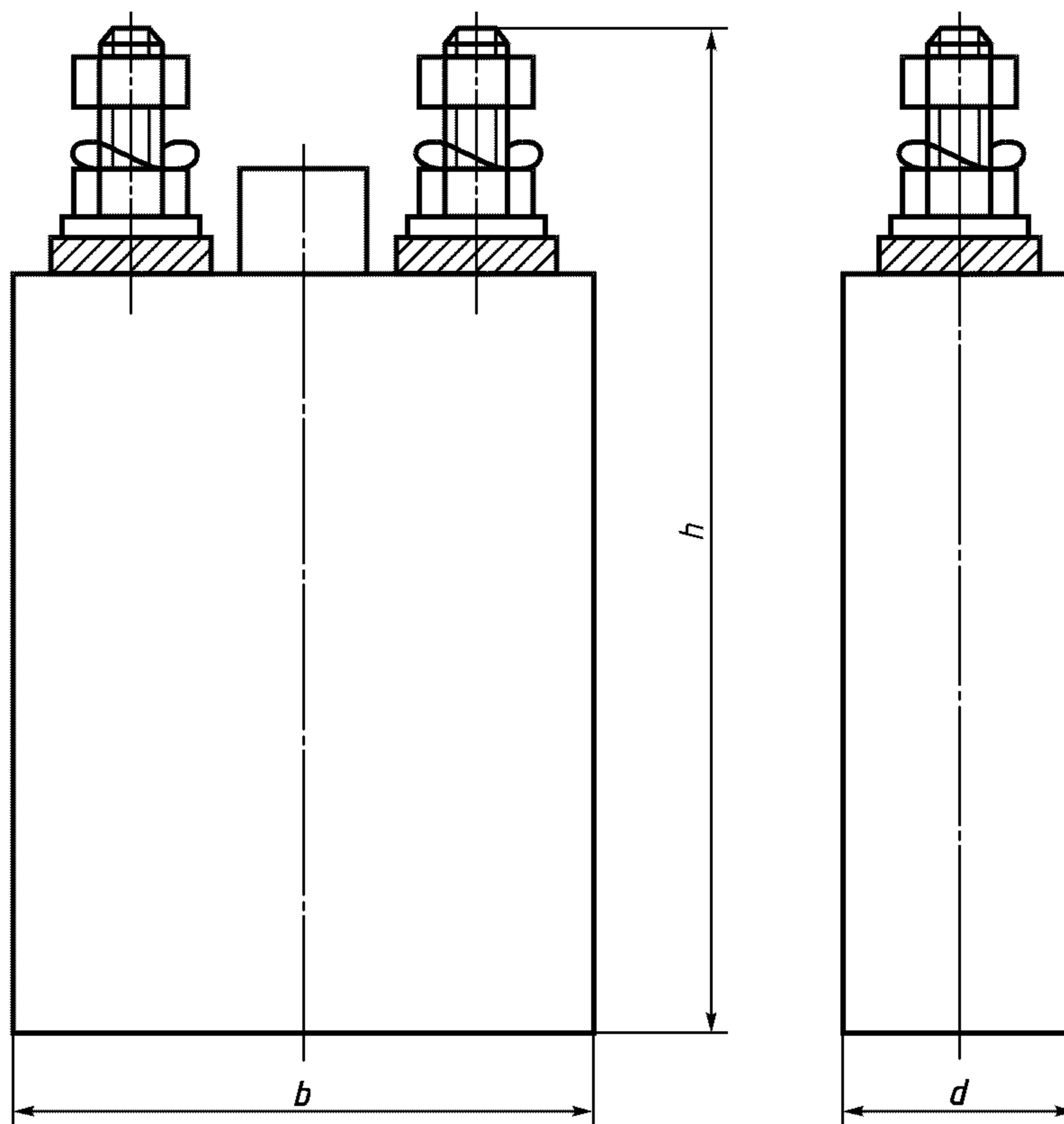
Рисунок 1 — Пример герметичного призматического аккумулятора
