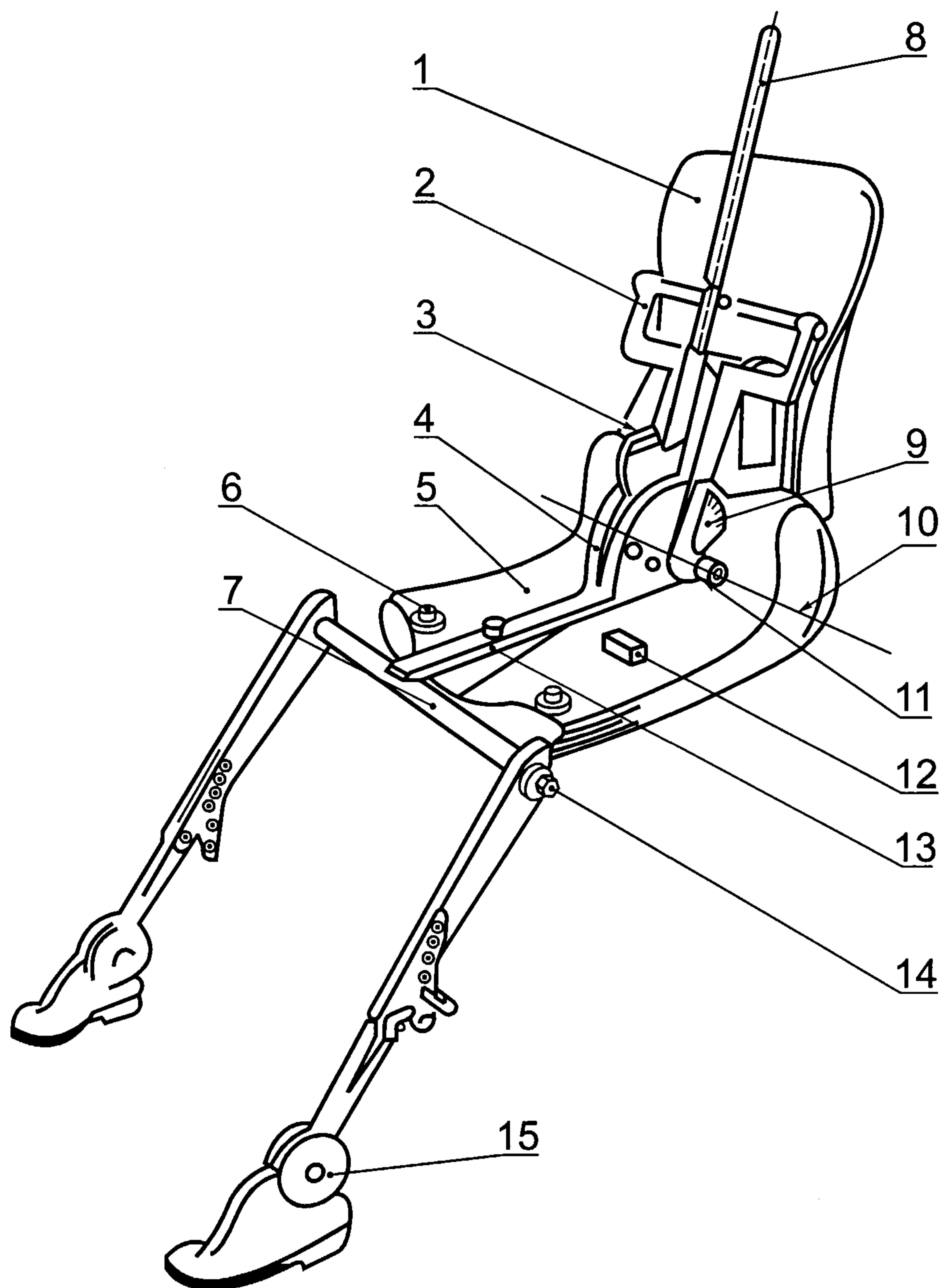
1 — спинка; 2 — кронштейн спинных грузов; 3 — уровень угла наклона спинки; 4 — круговой сектор наклона бедра; 5 — основание; 6 — кронштейн набедренных грузов; 7 — Т-образный коленный шарнир; 8 — штырь; 9 — круговой сектор наклона спинки; 10 — визитные метки точки  $H$ ; 11 — ось вращения точки  $H$ ; 12 — поперечный уровень; 13 — кронштейн бедра; 14 — круговой сектор сгиба колена; 15 — круговой сектор сгиба ступни
