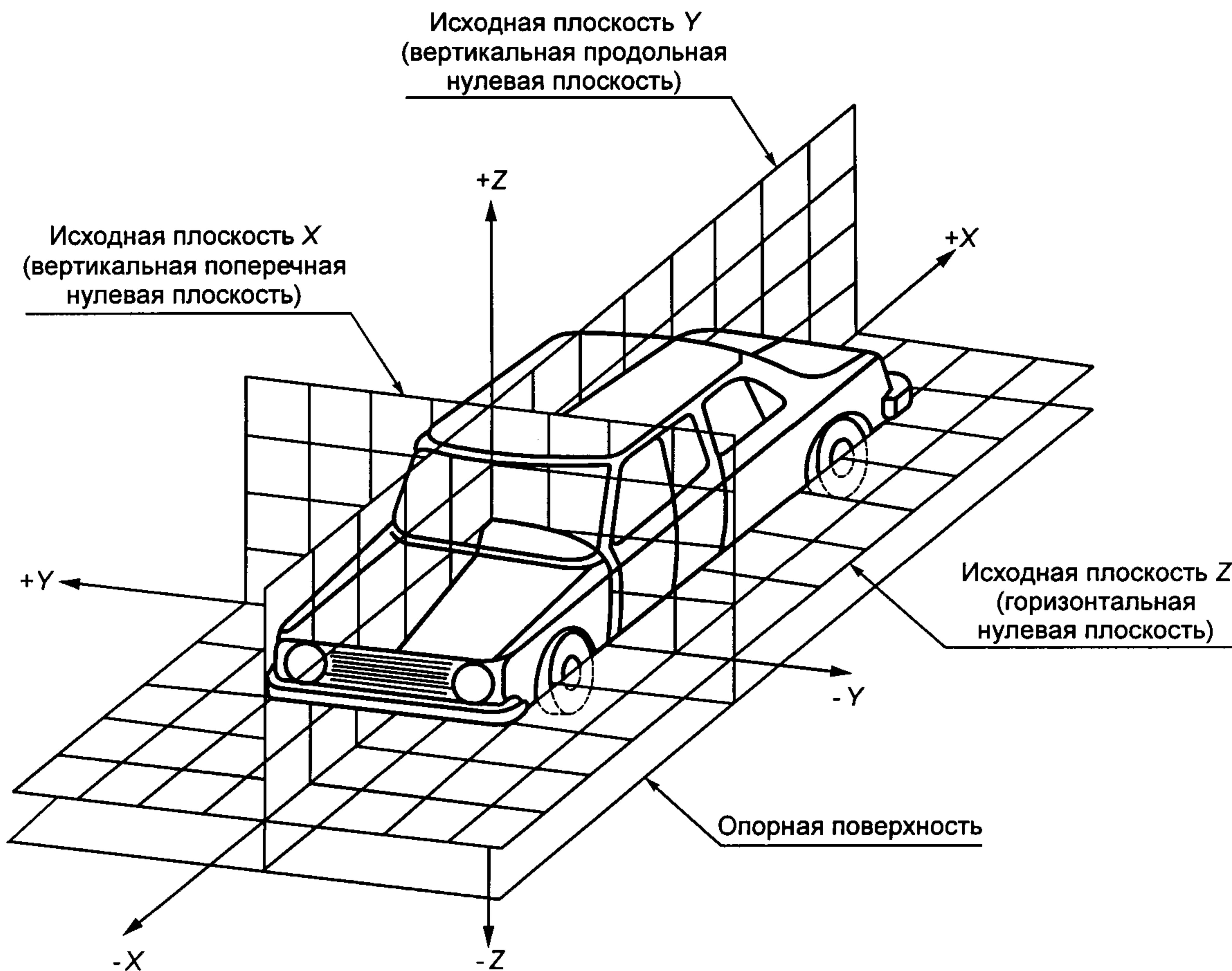
Рисунок 6.1 — Трехмерная система координат
