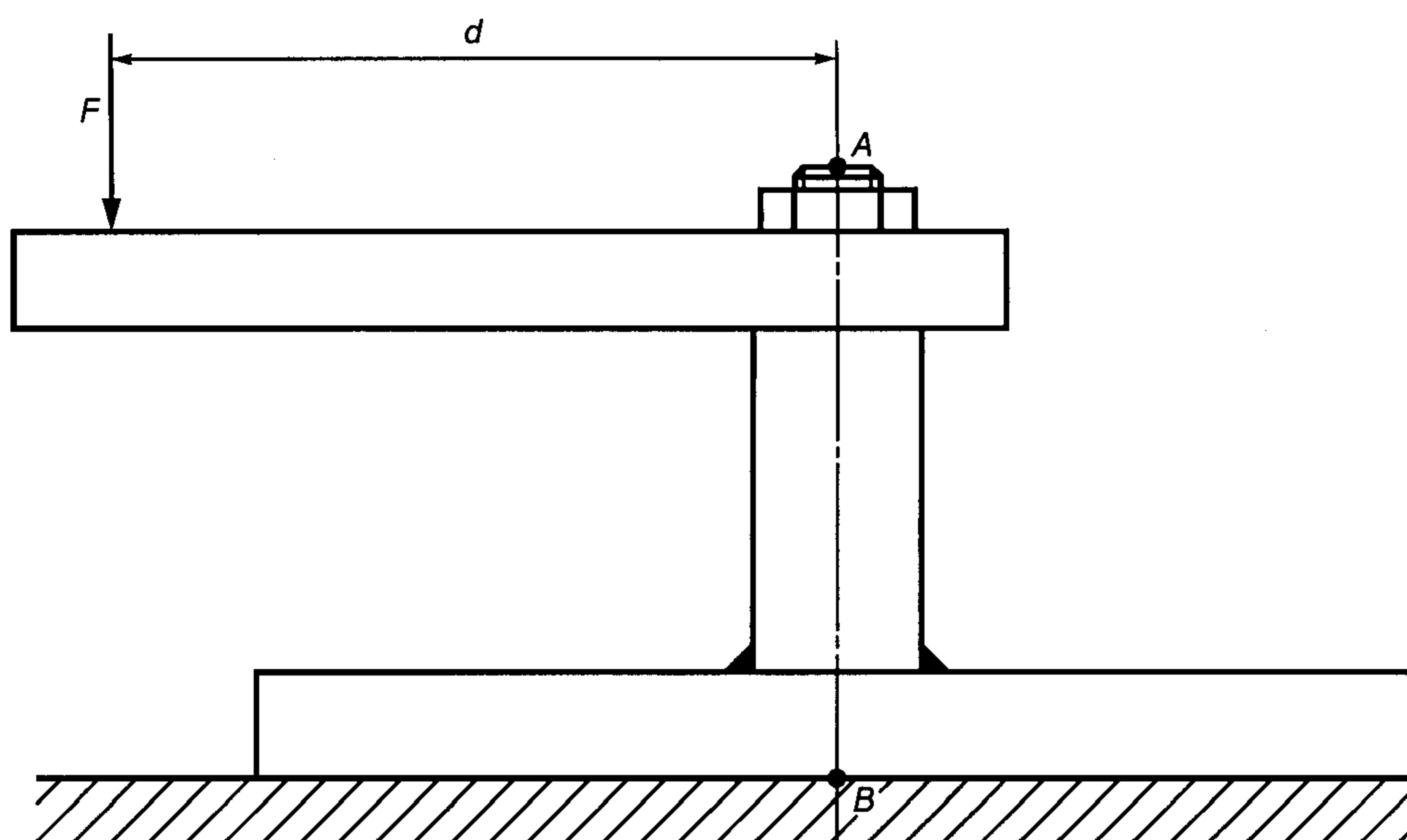
Рисунок 1б — Измерение жесткости крепления испытательной установки
