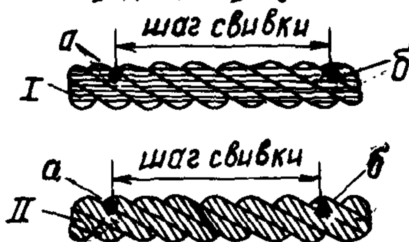
Схема свивки каната: I - крестовой; II - односторонней
