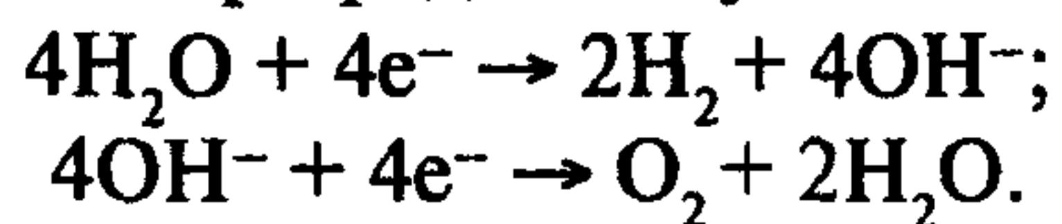
В результате электролиза у катода происходит концентрирование гидрата калия, а у анода — разбавление электролита образующейся водой. Ион калия не разряжается на катоде, являясь только переносчиком тока. Таким образом, процесс электролиза воды можно выразить суммарной реакцией:
