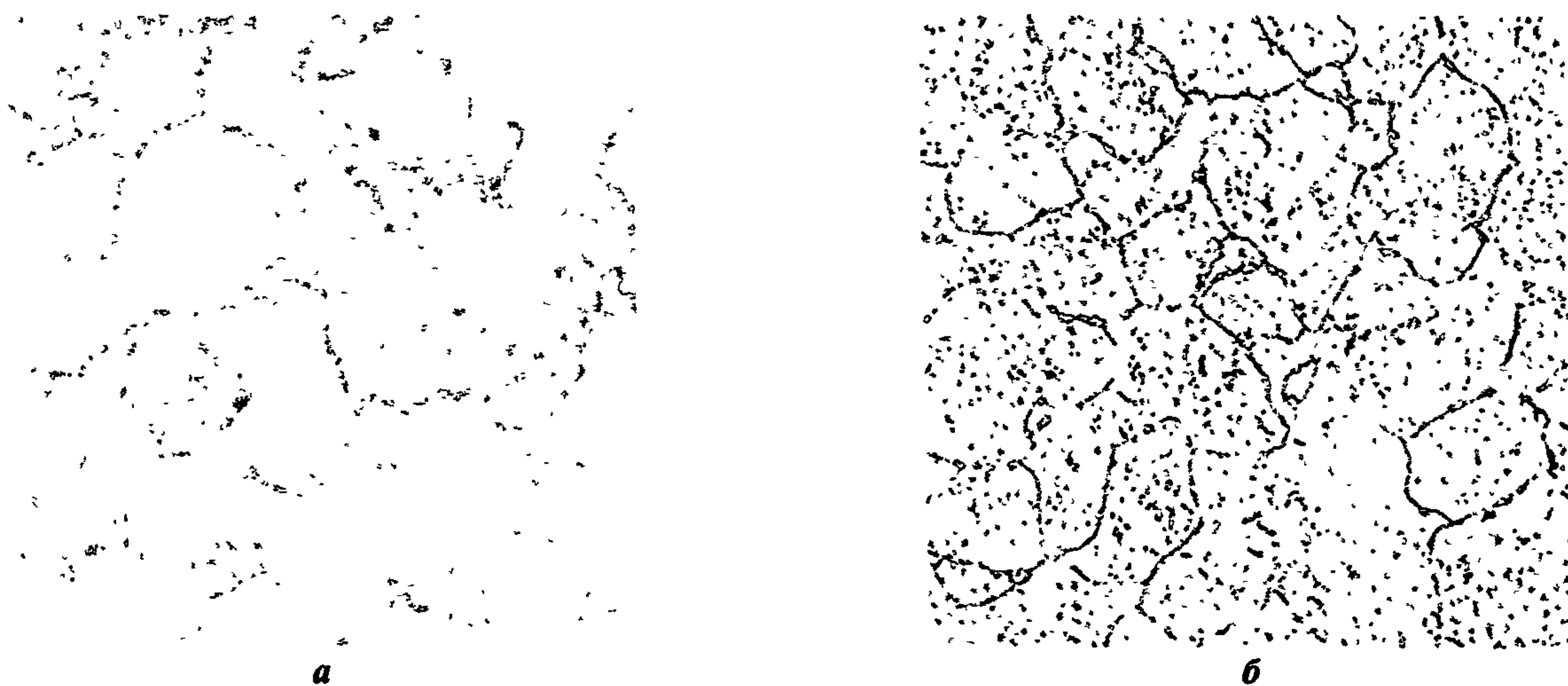
Рис.5. Микроструктура сталей 12Х1МФ (а) и 15Х1М1Ф (б). Микрошлифы, \times 500 . Микропоры отсутствуют. Карбиды имеют светлую окраску с окантовкой по краям.
