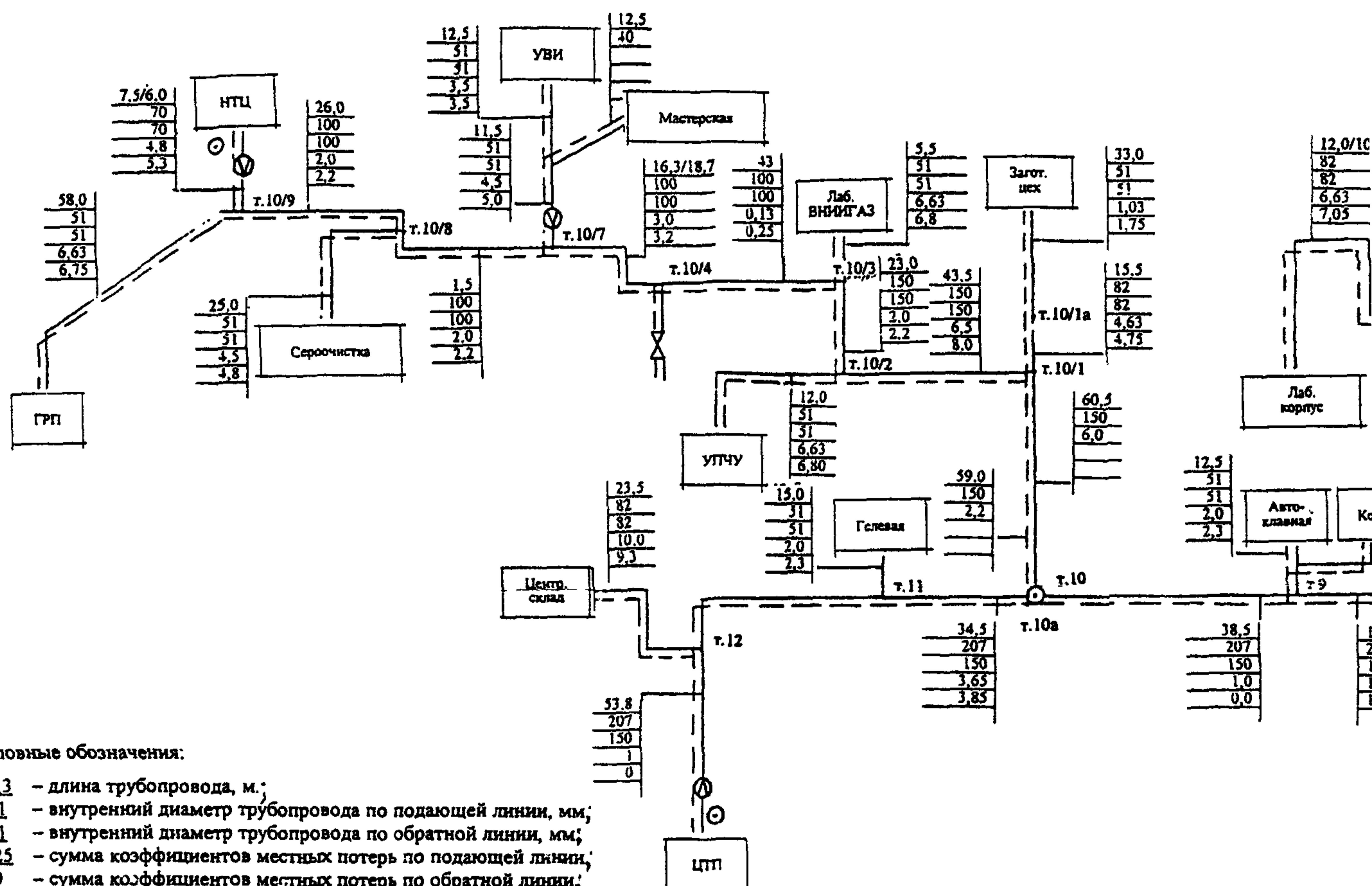
Рисунок Д1 – Расчетная схема испытываемой тепловой сети
