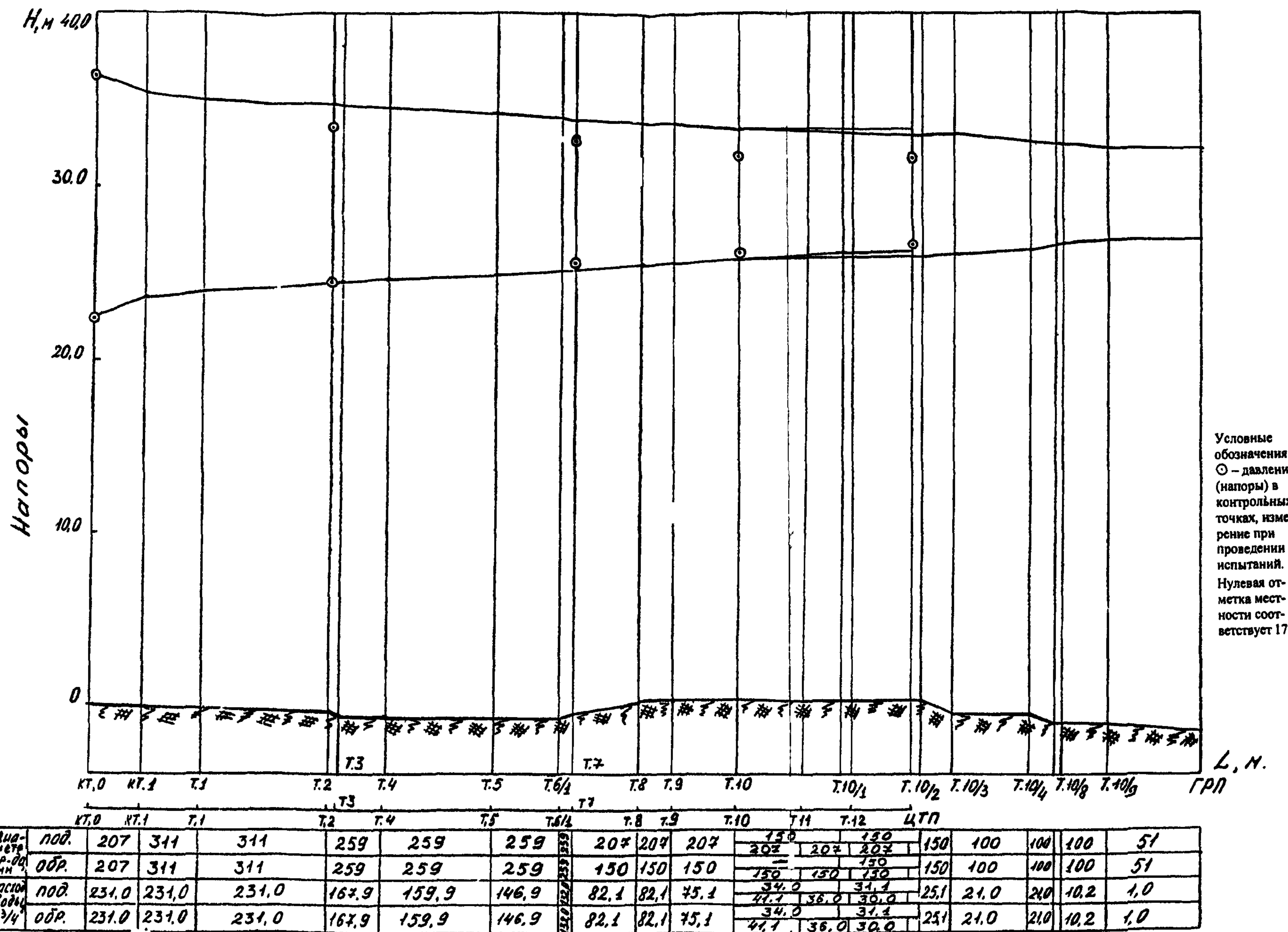
Рисунок Д.2 – Пьезометрический график испытываемой тепловой сети
