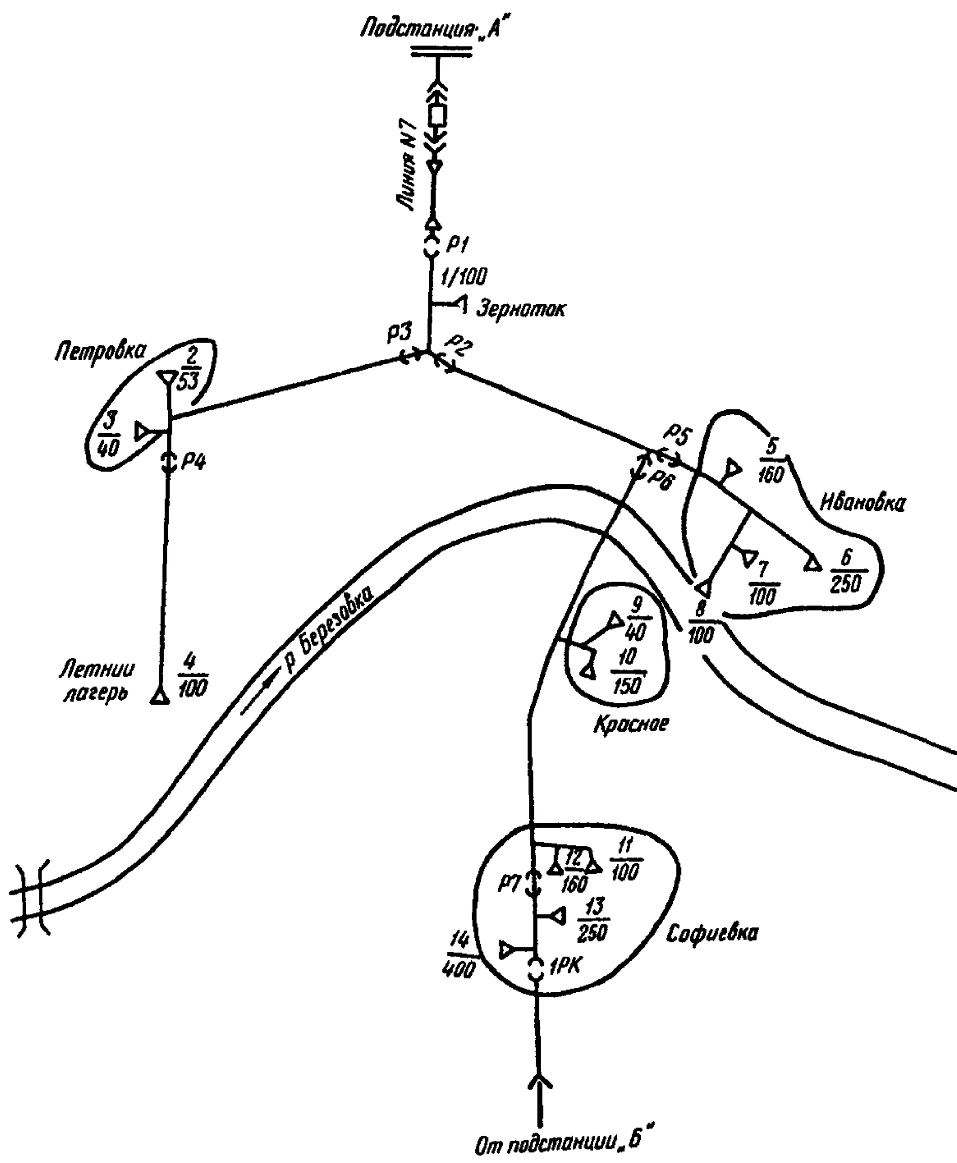
Схема электрической сети 10 кВ
