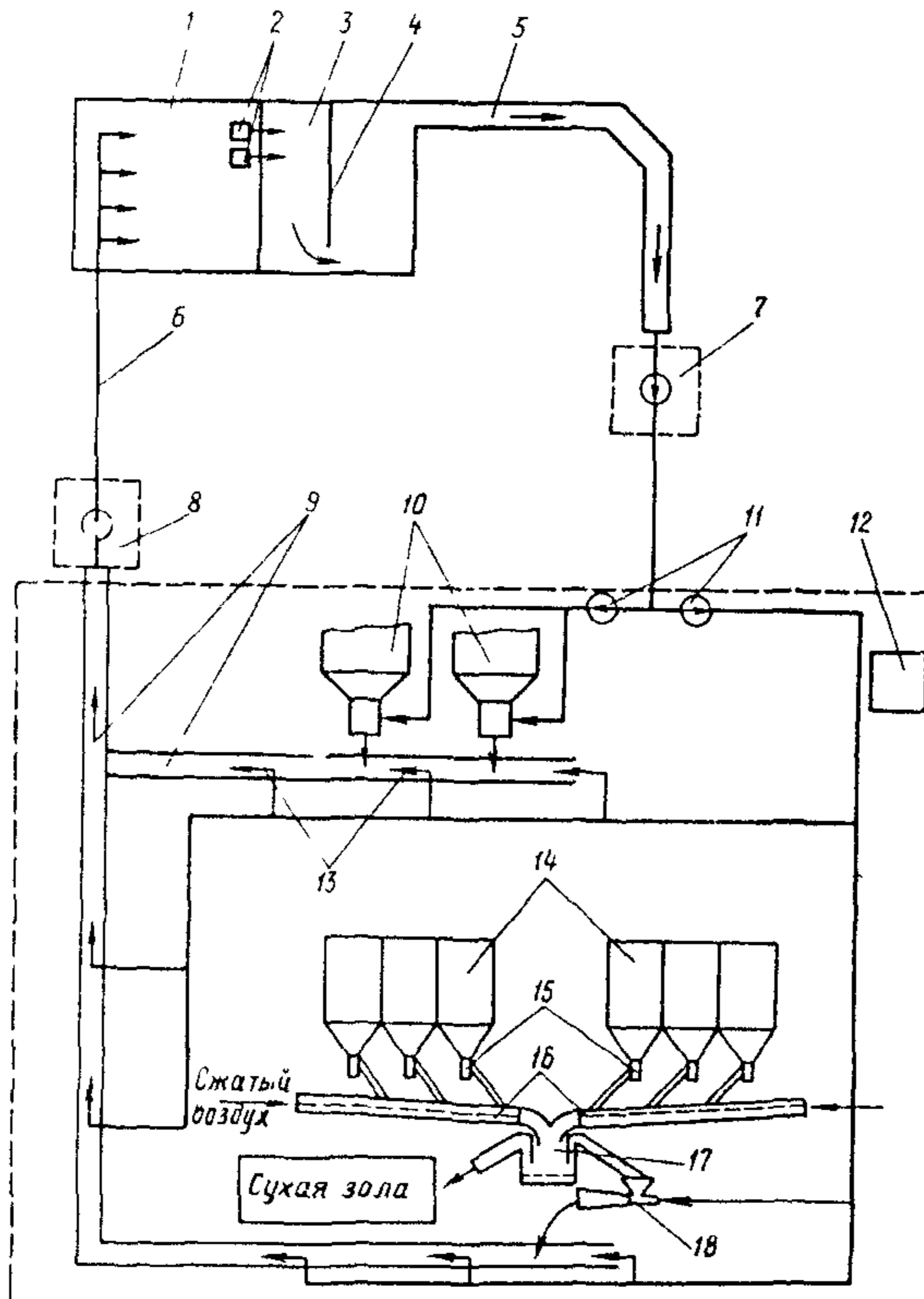
Рис.3. Схема гидрозолоудаления ТЭС
