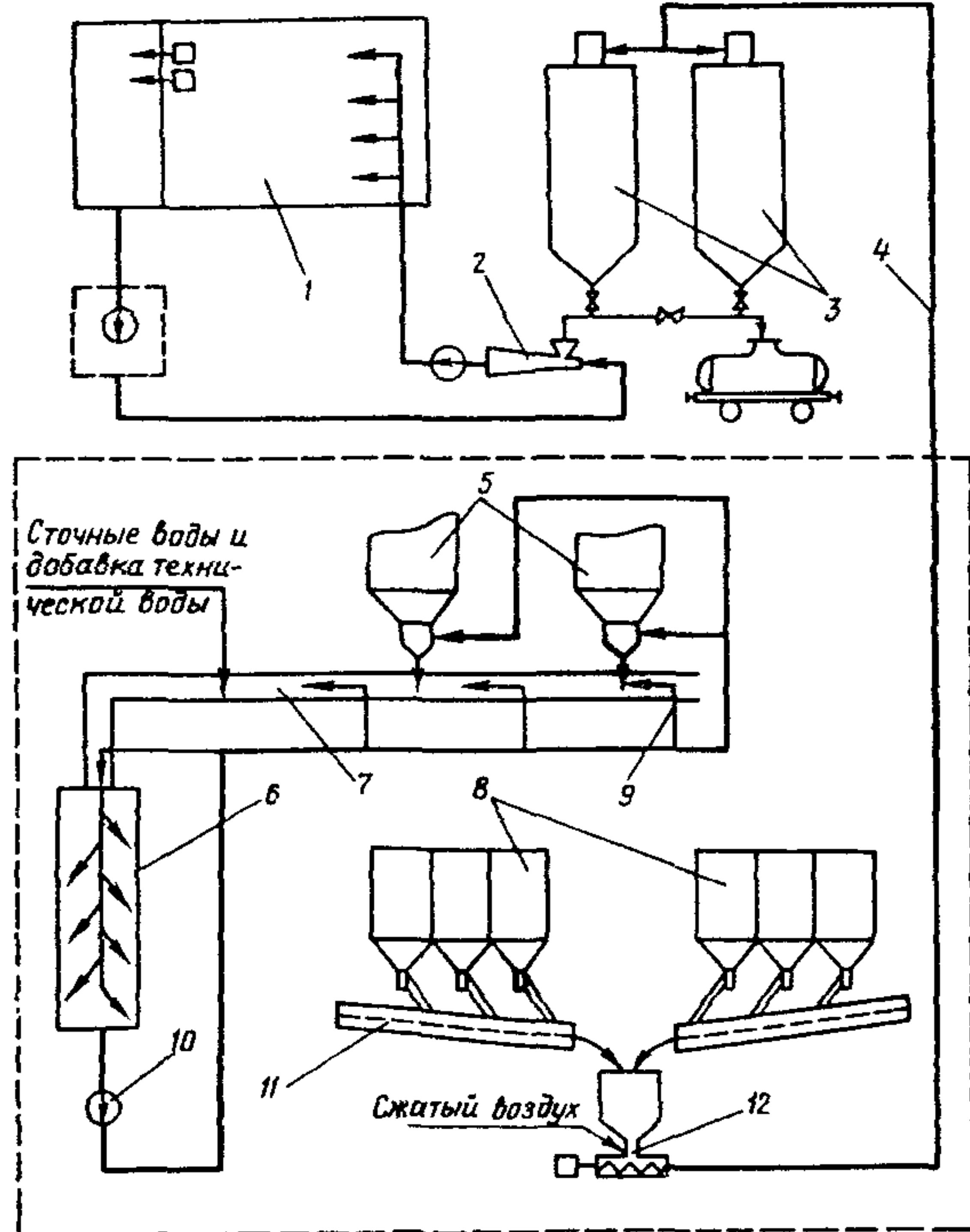
Рис. I0. Схема пневмотранспорта летучей золы с резервной системой гидрозолоудаления
