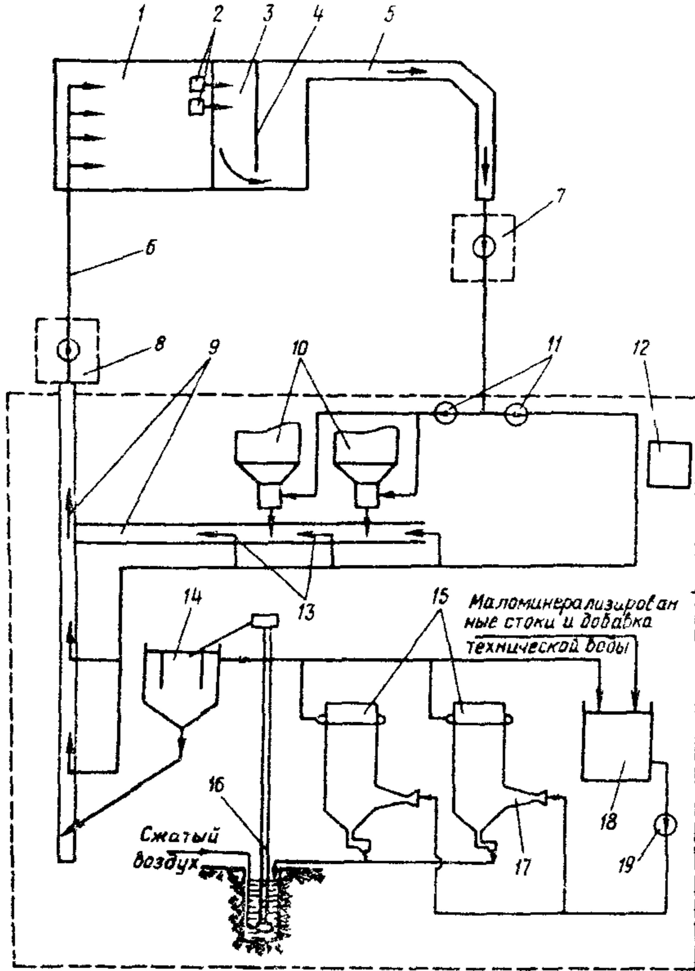
Рис.5. Схема гидрозолоудаления ТЭС, оборудованной мокрыми золоуловителями с автономным циклом орошения
