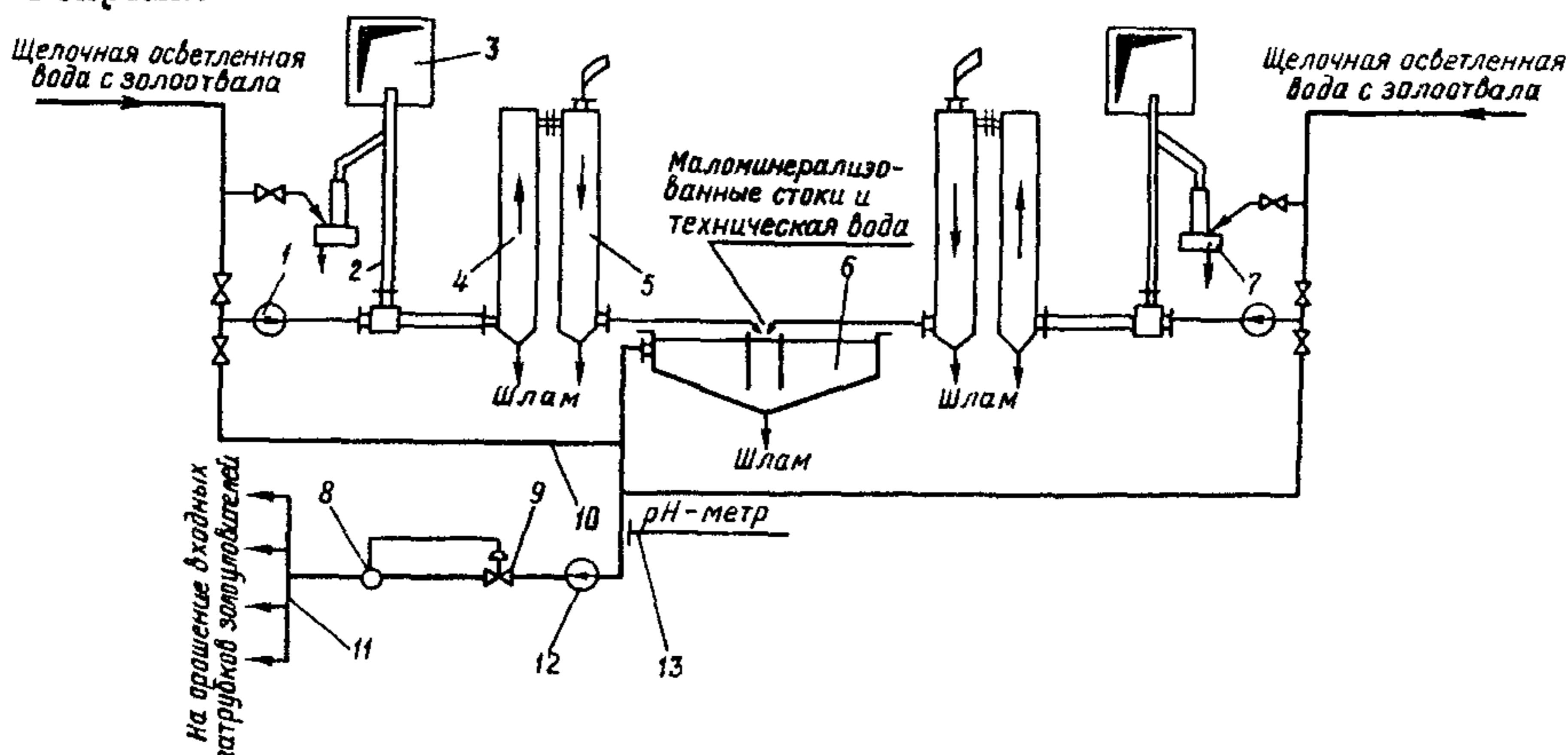
Рис.8. Нейтрализация щелочной оборотной воды дымовыми газами по схеме ВТИ
