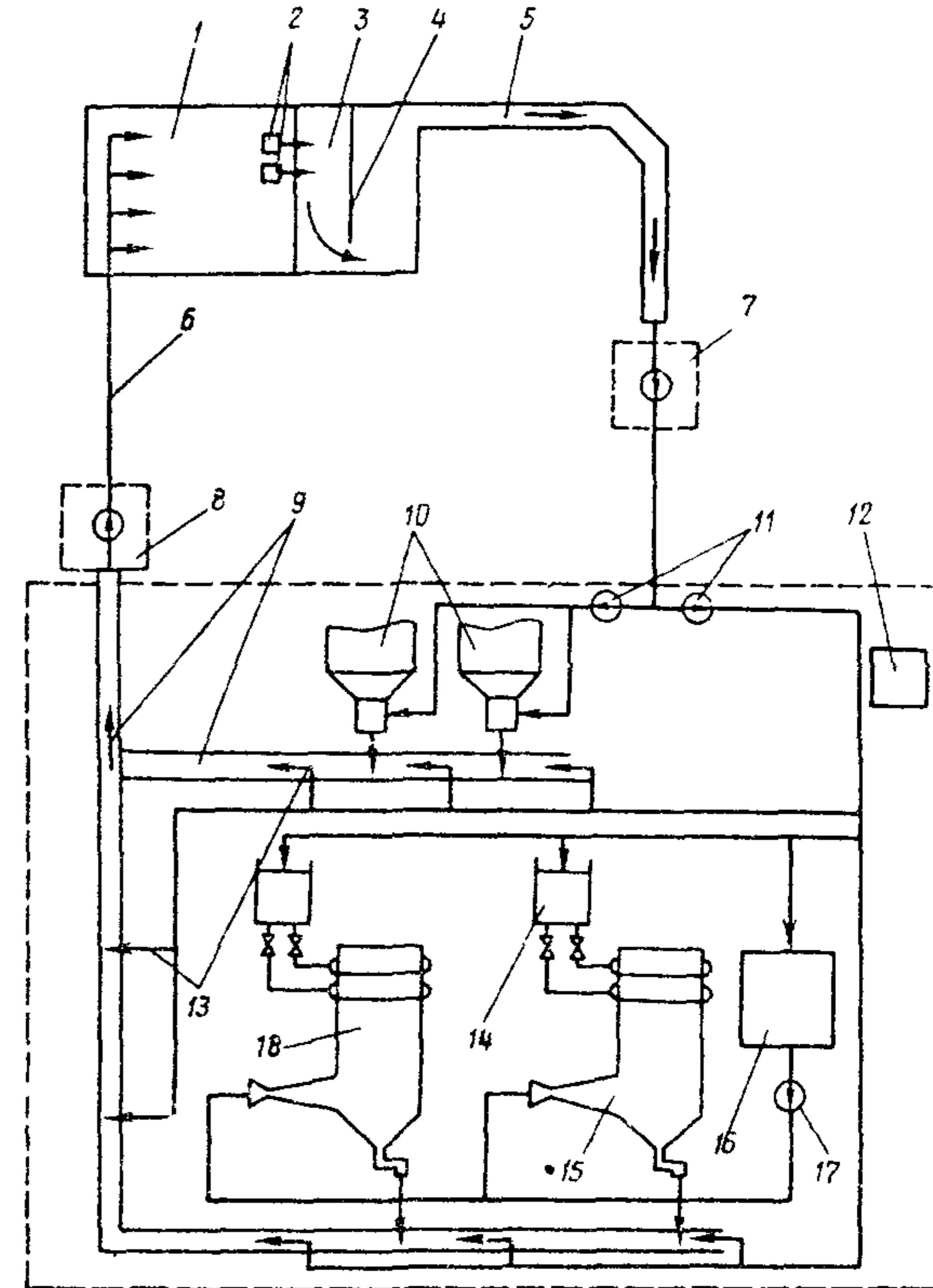
Рис.6. Схема гидрозолоудаления ТЭС с мокрыми золоуловителями при щелочной реакции обратной воды
