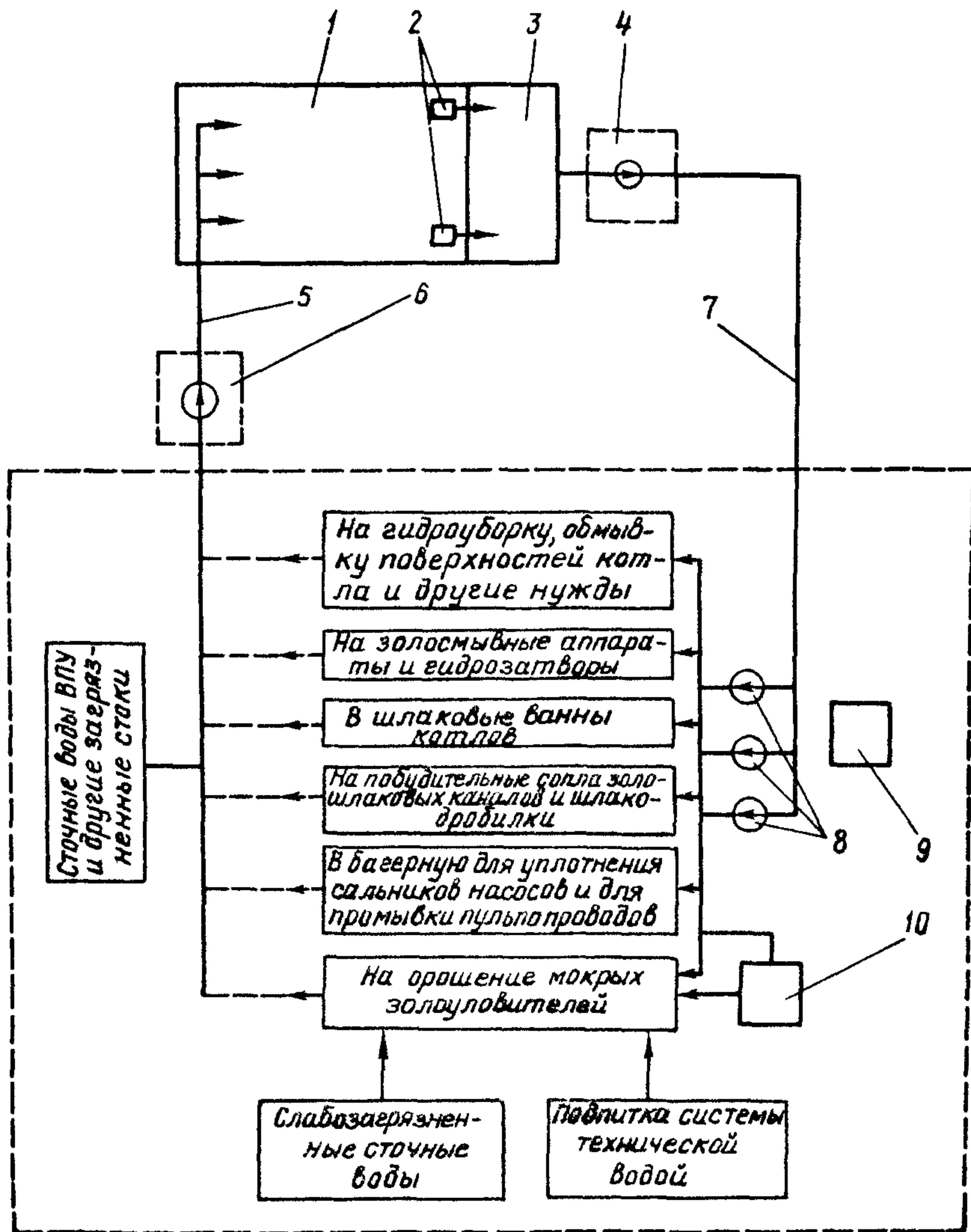
Рис. I. Принципиальная схема бессточнойной системы ГЗУ
