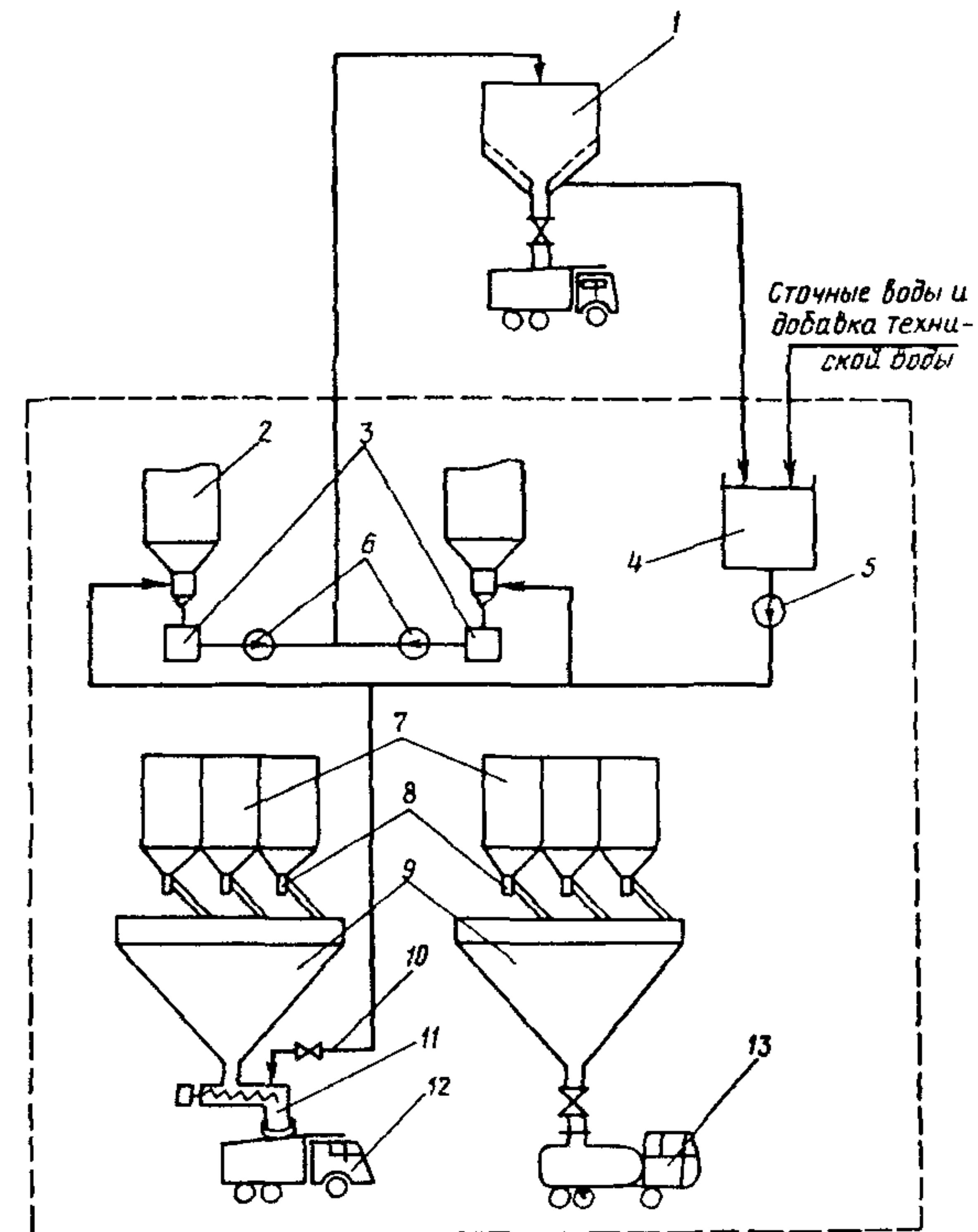
Рис. II. Схема удаления летучей золы и шлаков колесным транспортом
