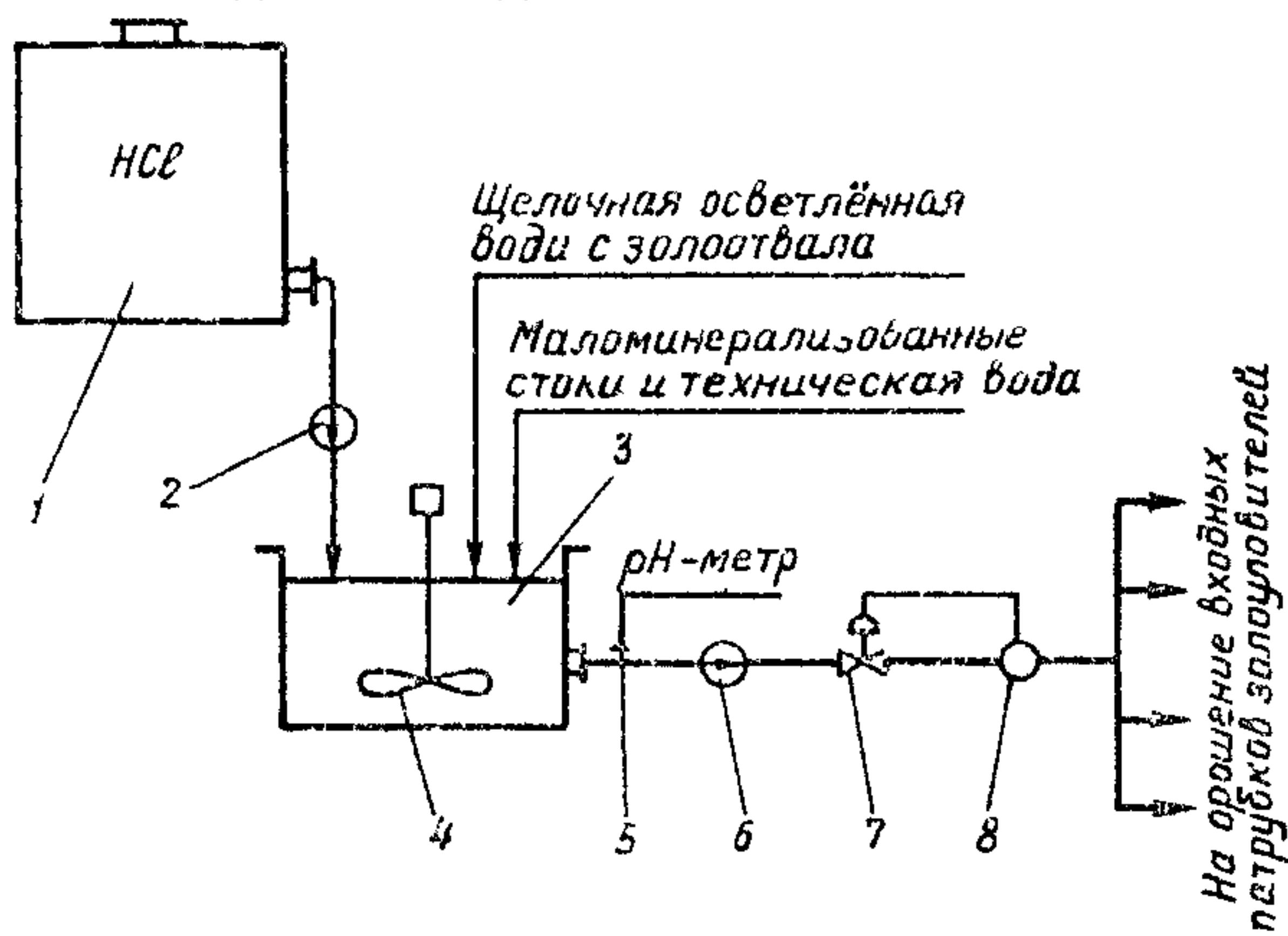
Рис.7. Схема нейтрализации щелочной оборотной воды соляной кислотой
