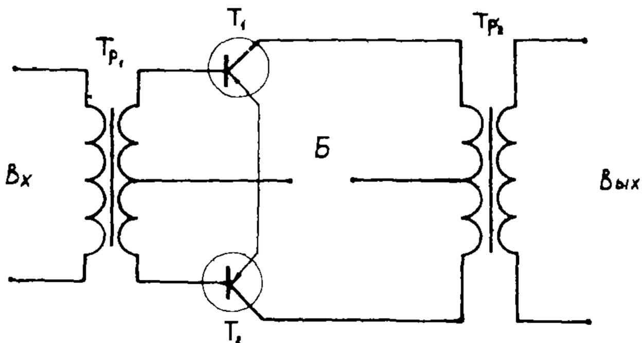
Рис 5 Электрическая схема усилителя к прибору М-416
