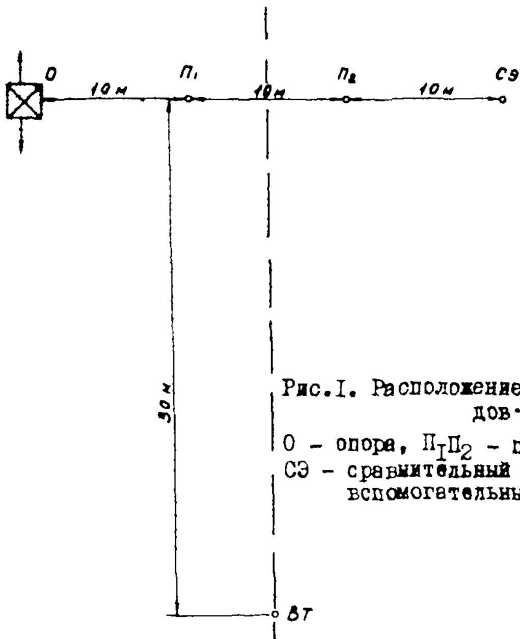
Рис. I. Расположение измерительных электродов.
