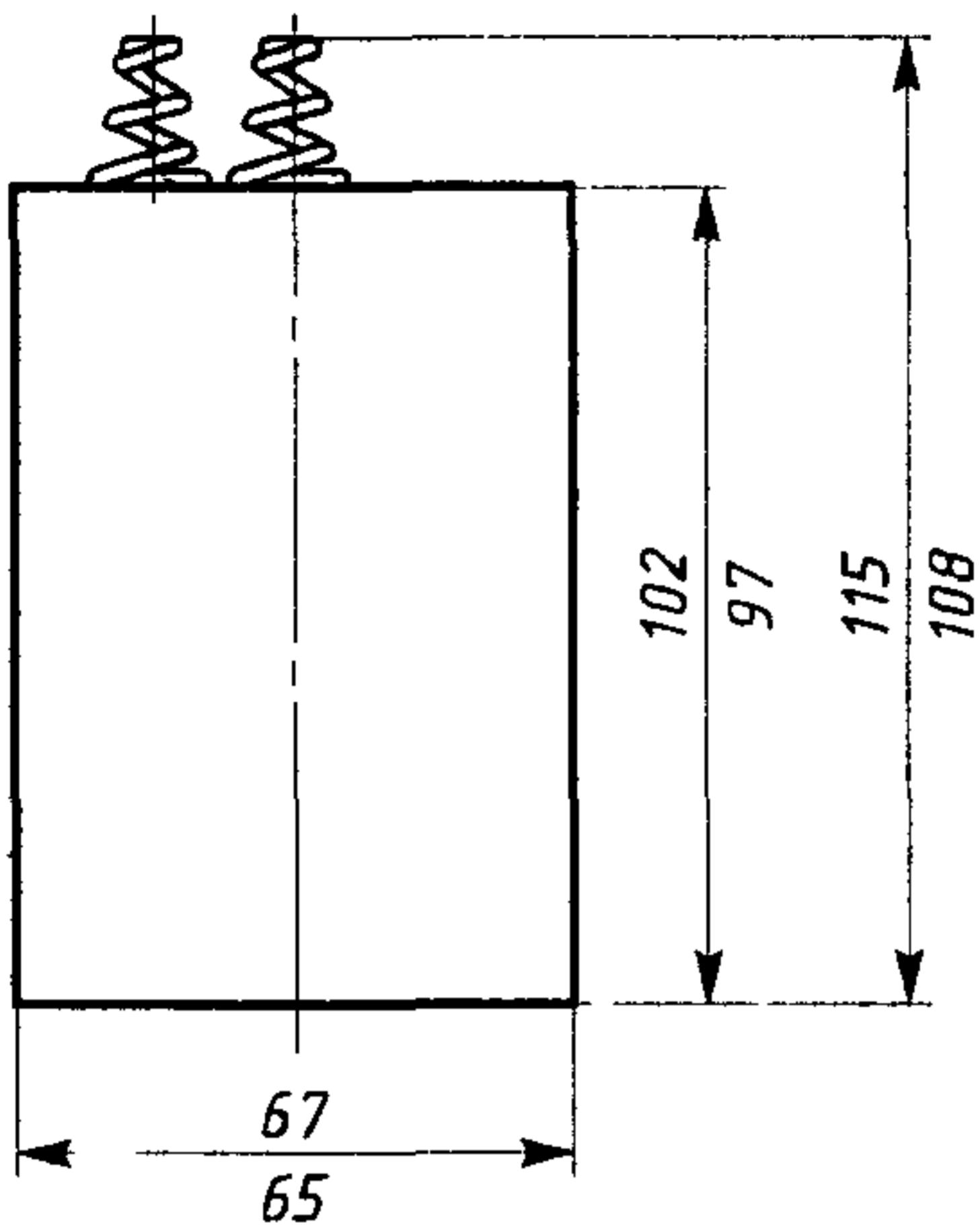
*Контакты в виде конических спиральных пружин*
