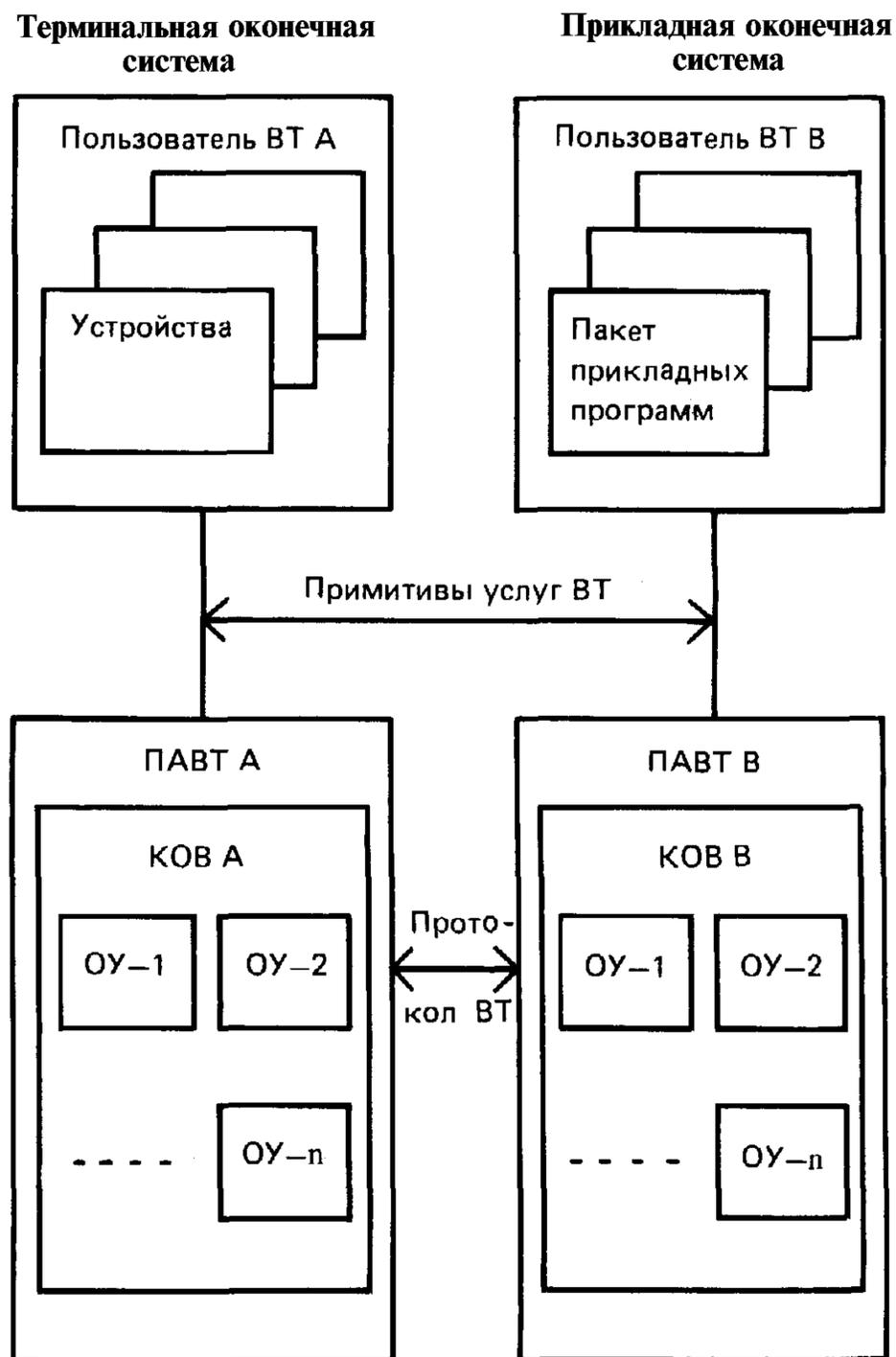
Рисунок 2 — Объекты управления в модели протокола ВТ
