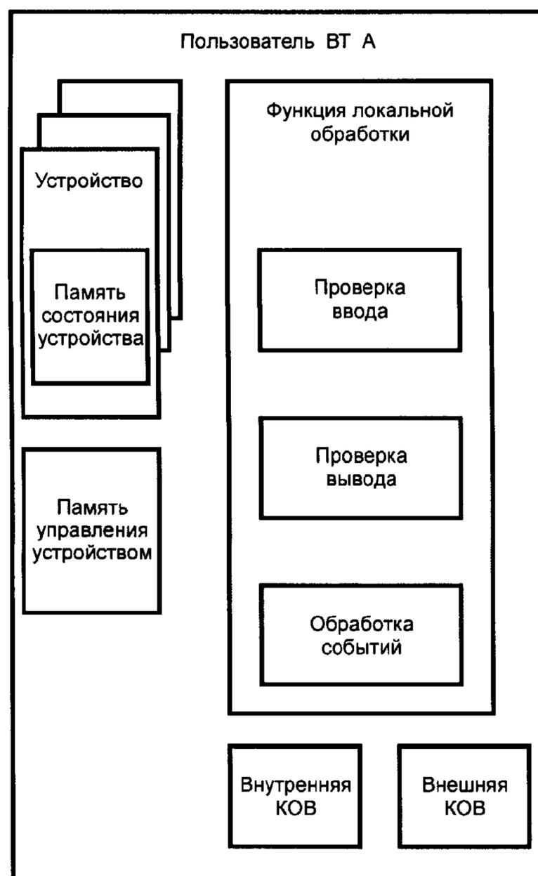
Рисунок 3 — Структура терминального пользователя ВТ
