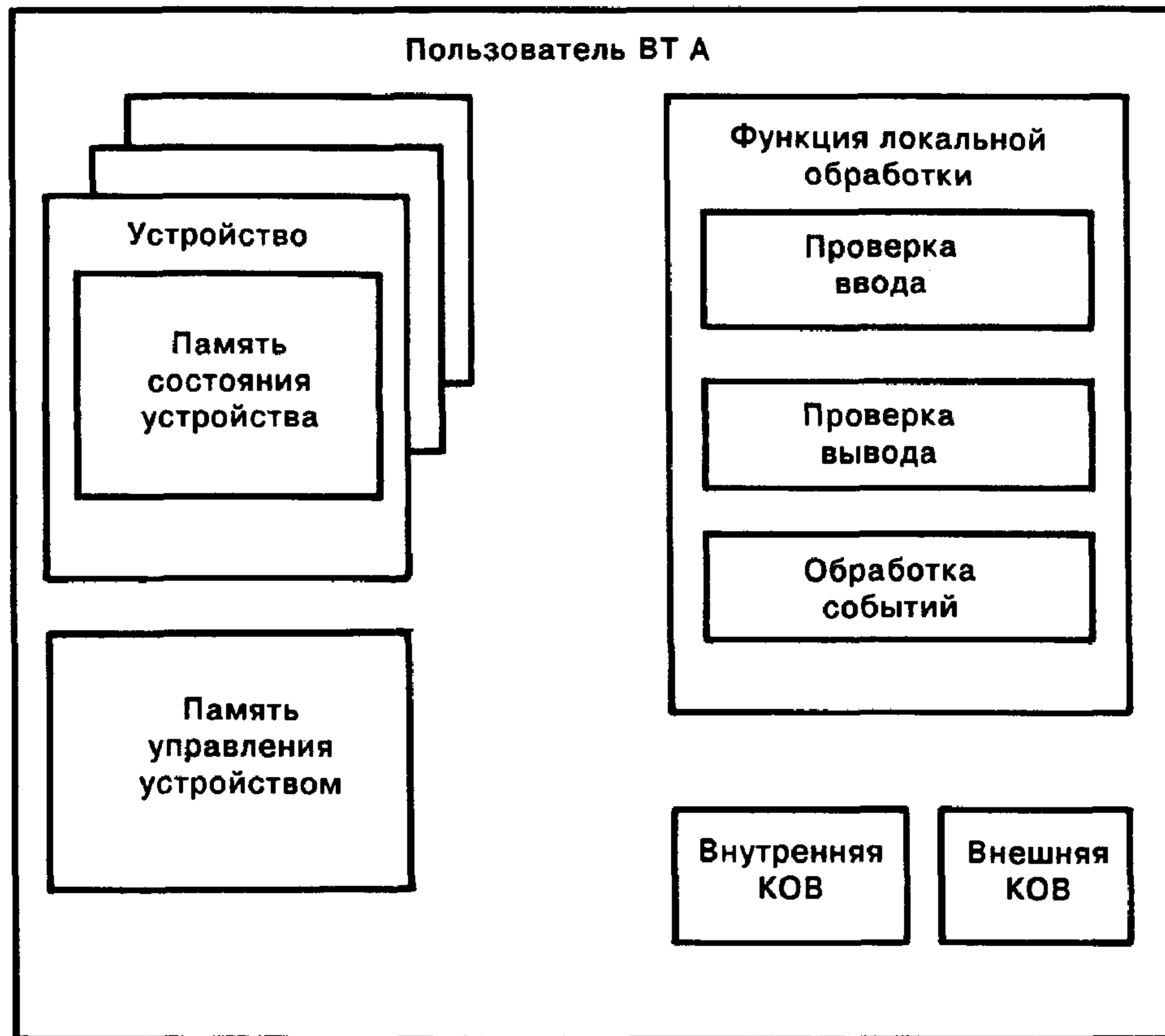
Рисунок 3 — Структура терминального пользователя ВТ
