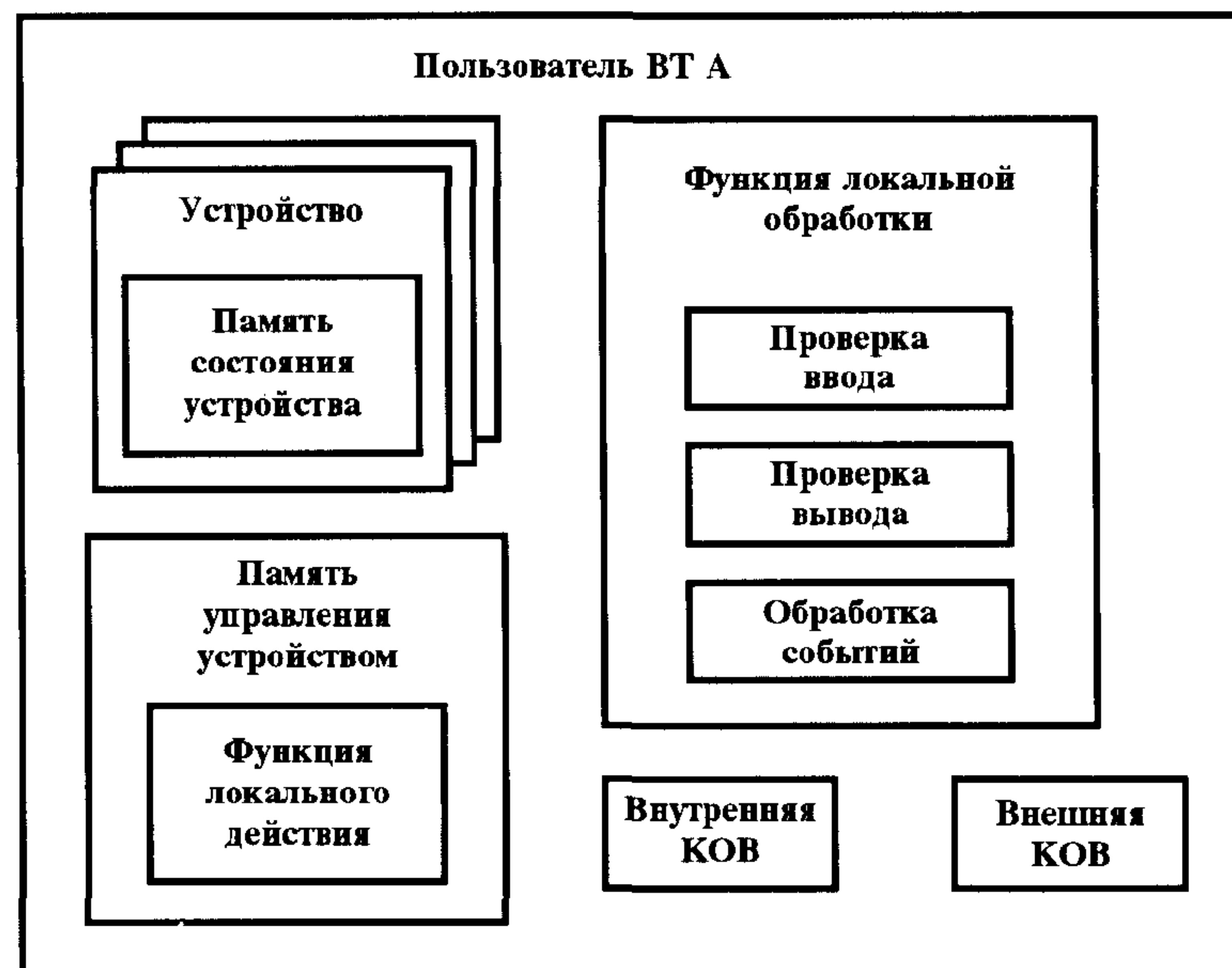
Рисунок 3 — Структура терминального пользователя ВТ
