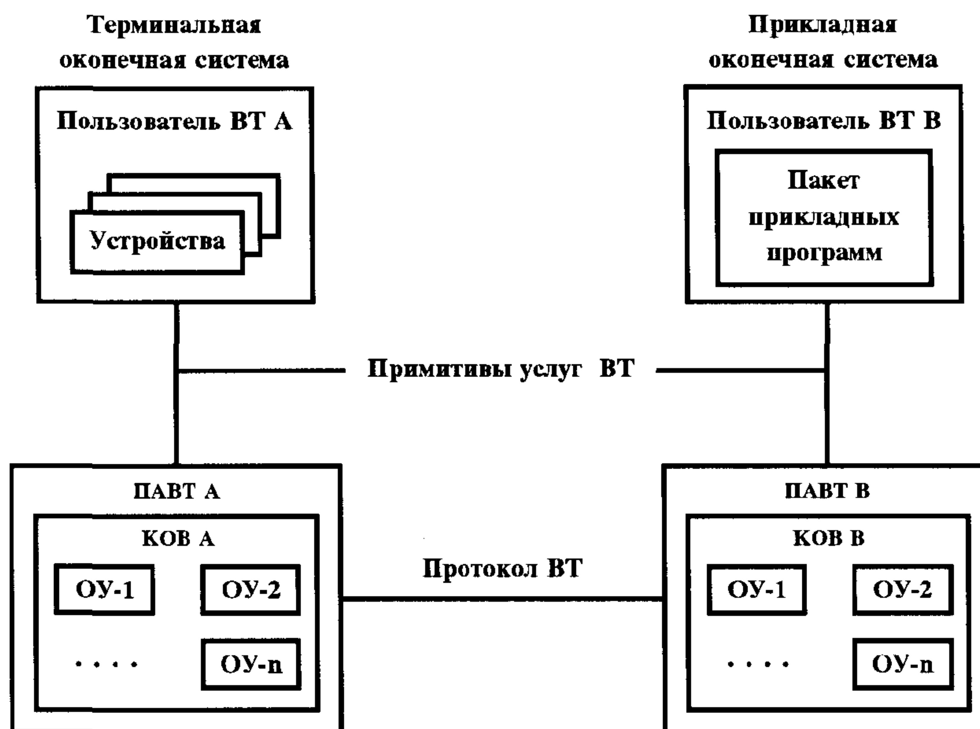
Рисунок 2 — Объекты управления в модели протокола ВТ
