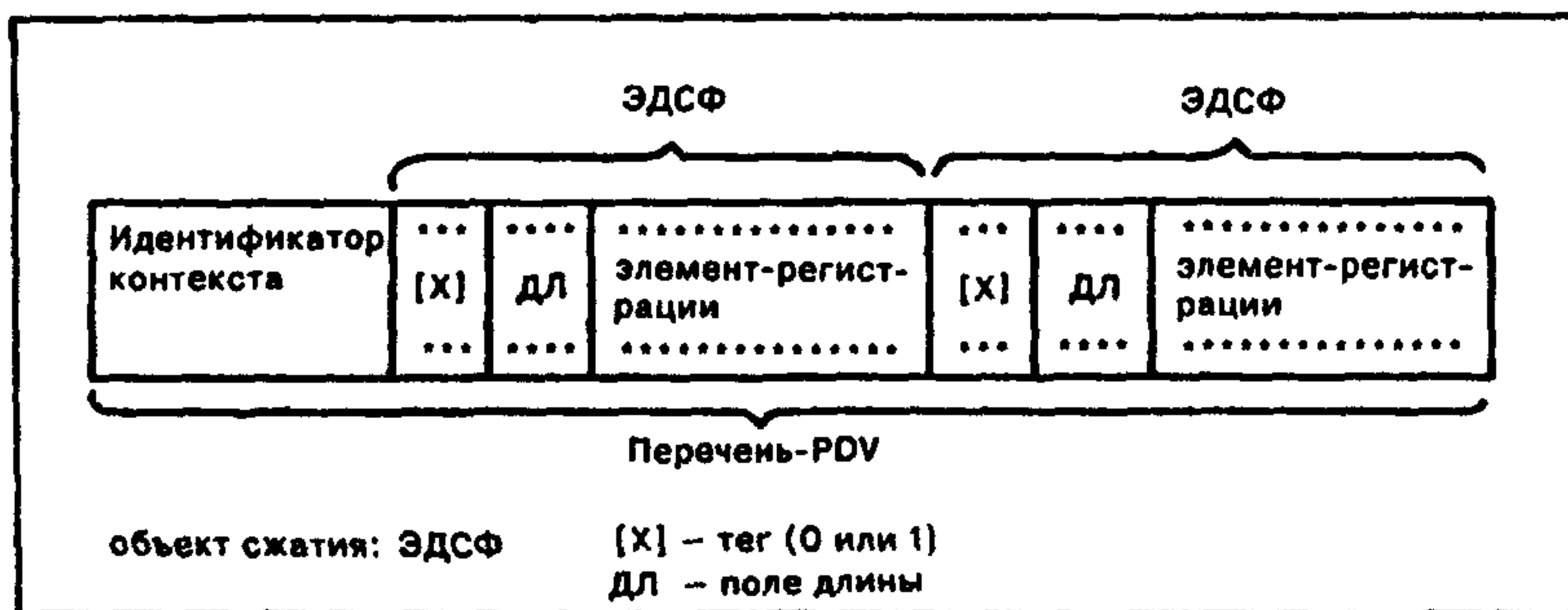
Рисунок 5 — Метод сжатия INTAP-СП1
