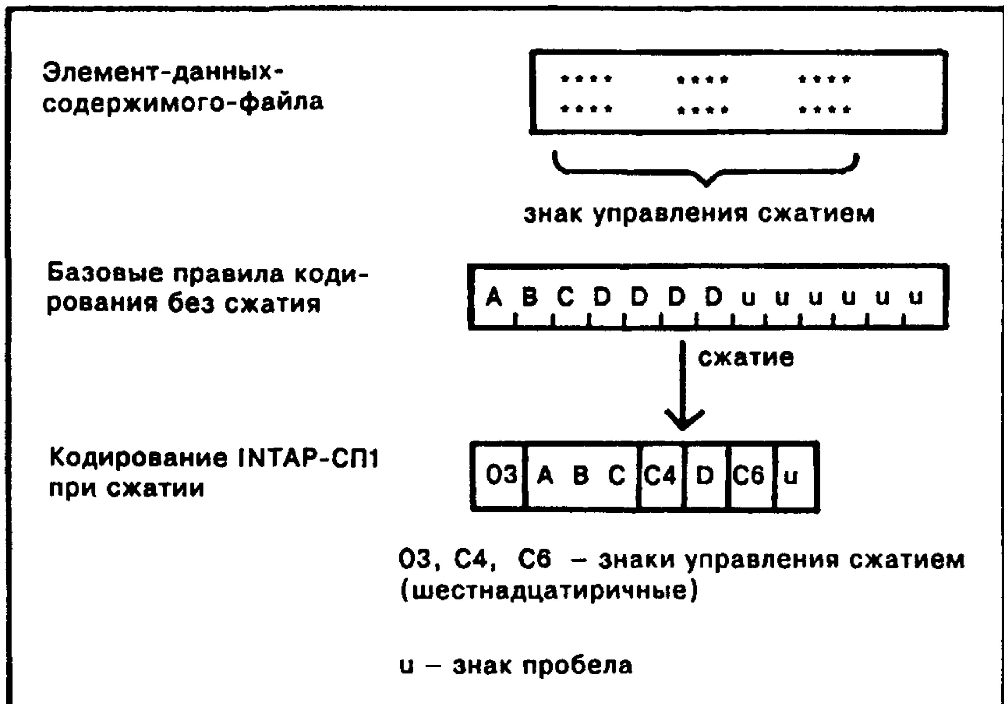
Рисунок 7 — Пример кодирования при использовании INTAP-СП1
