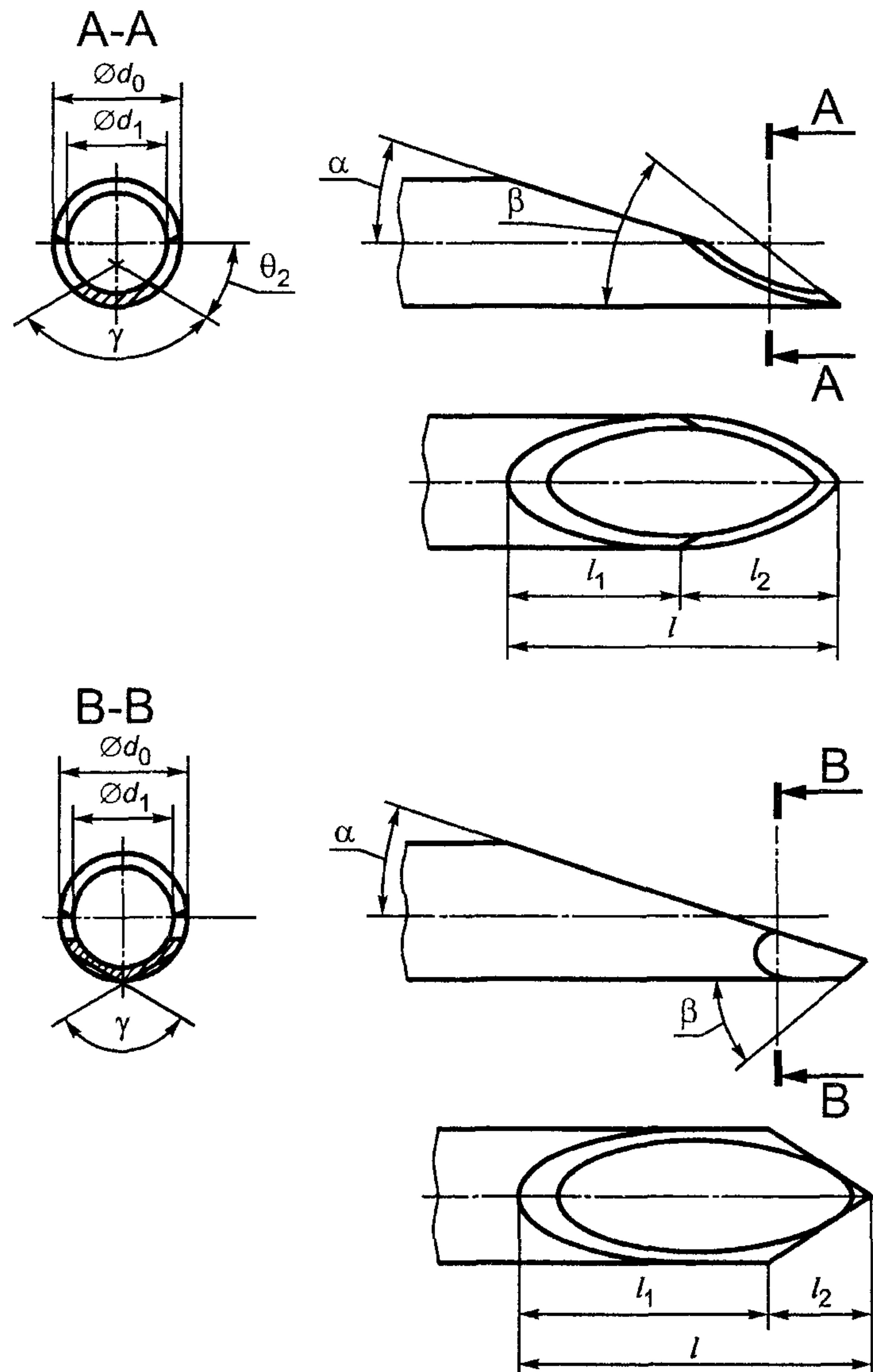
$d_0$  — наружный диаметр трубки;  $d_1$  — внутренний диаметр трубки;  $l$  — длина острия;  $l_1$  — первоначальная номинальная длина скоса;  $l_2$  — вторичная номинальная длина скоса;  $\alpha$  — первичный угол скоса;  $\beta$  — угол наконечника;  $\theta_2$  — вторичный угол вращения скоса;  $\gamma$  — комбинированный вторичный угол скоса
