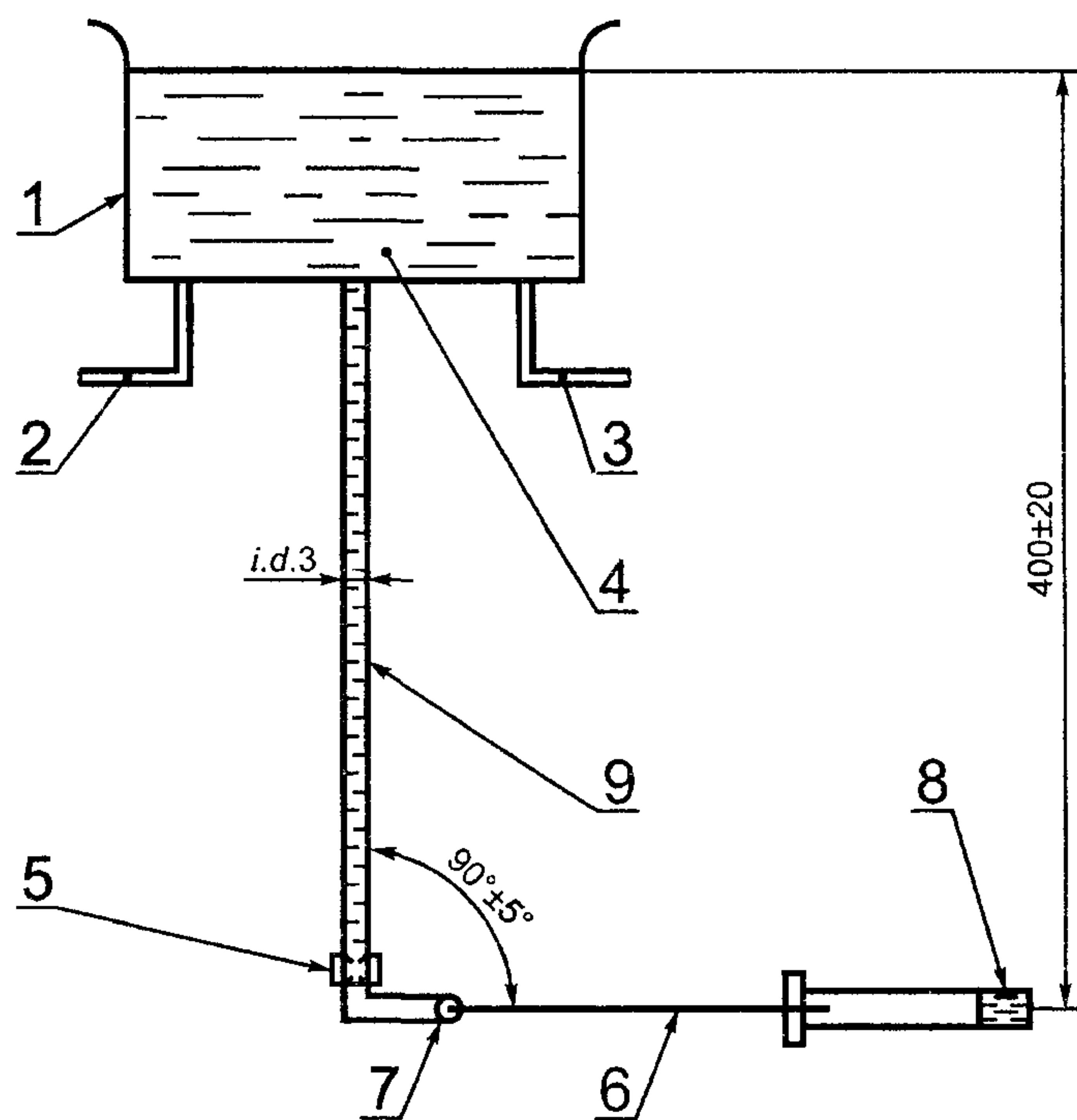
1 — резервуар постоянного уровня; 2 — слив; 3 — впуск; 4 — жидкость для испытаний; 5 — зажим или клапан;
