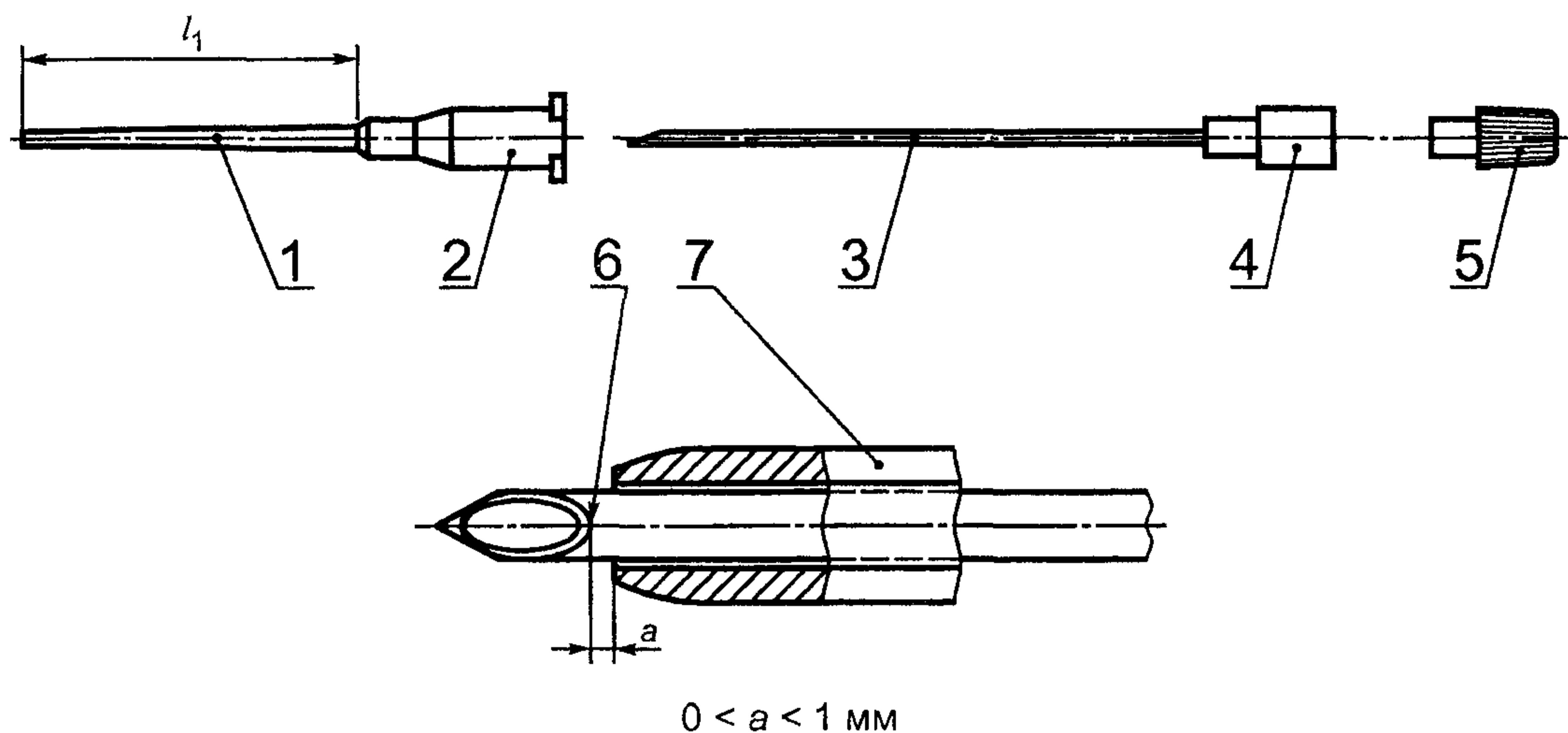
$l_1$  — эффективная длина; 1 — трубка катетера; 2 — канюля катетера; 3 — трубка иглы; 4 — канюля иглы; 5 — насадка с клапаном; 6 — пятка скоса; 7 — элемент катетера
