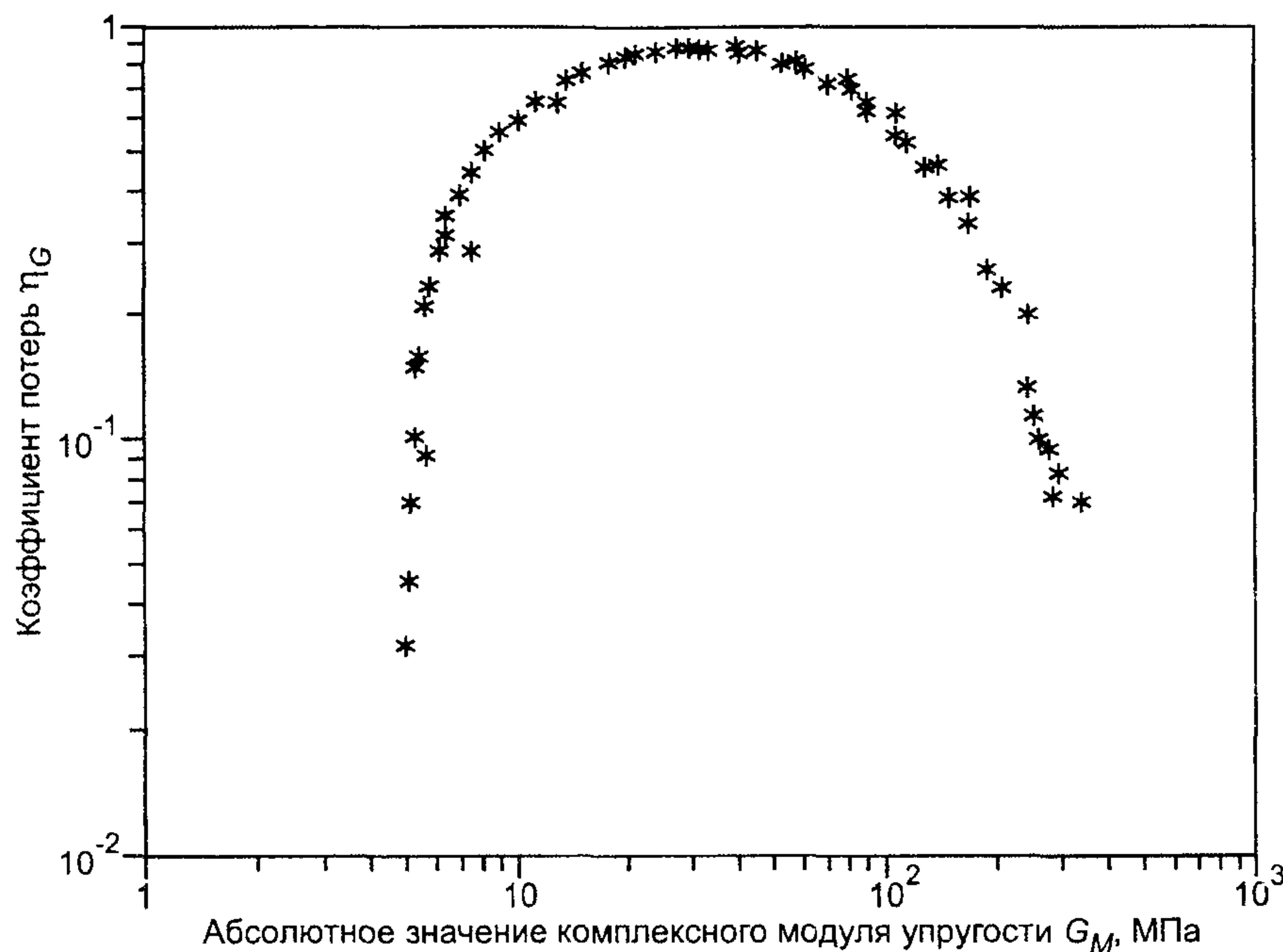
Рисунок 1 — Проверка качества данных
