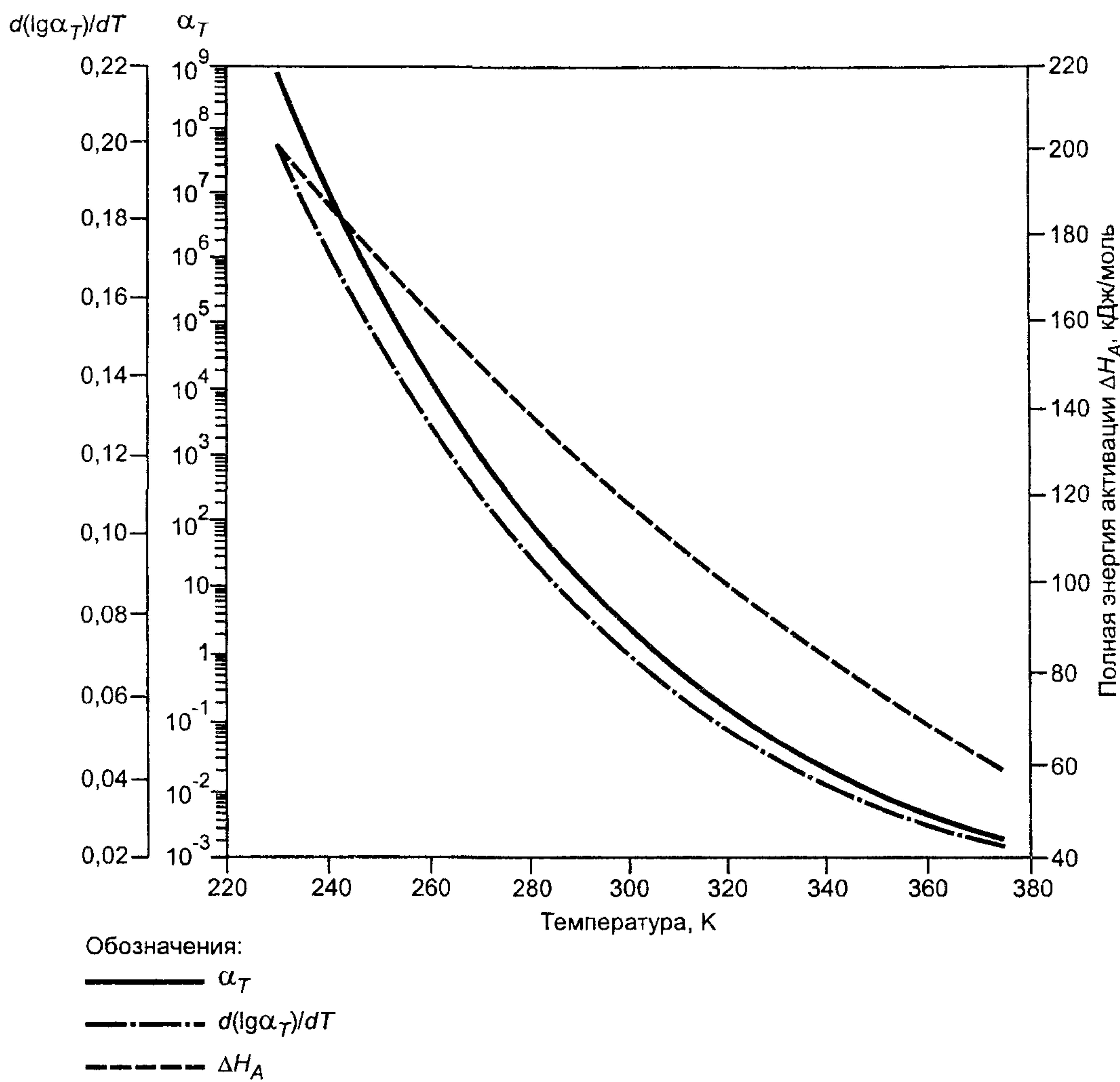
Рисунок 2 — Функция температурного смещения
