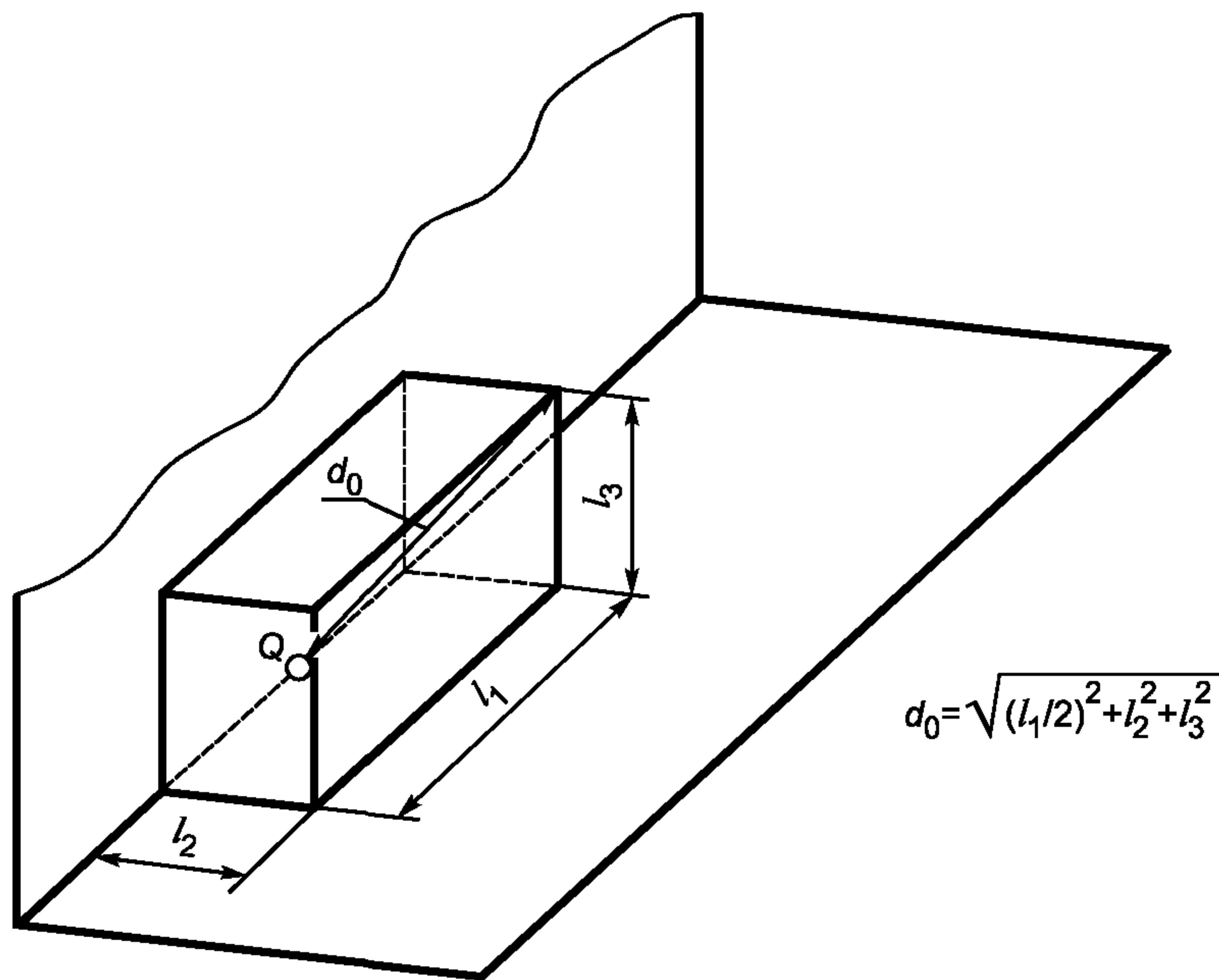
в) Огибающий параллелепипед на трех звукоотражающих плоскостях
