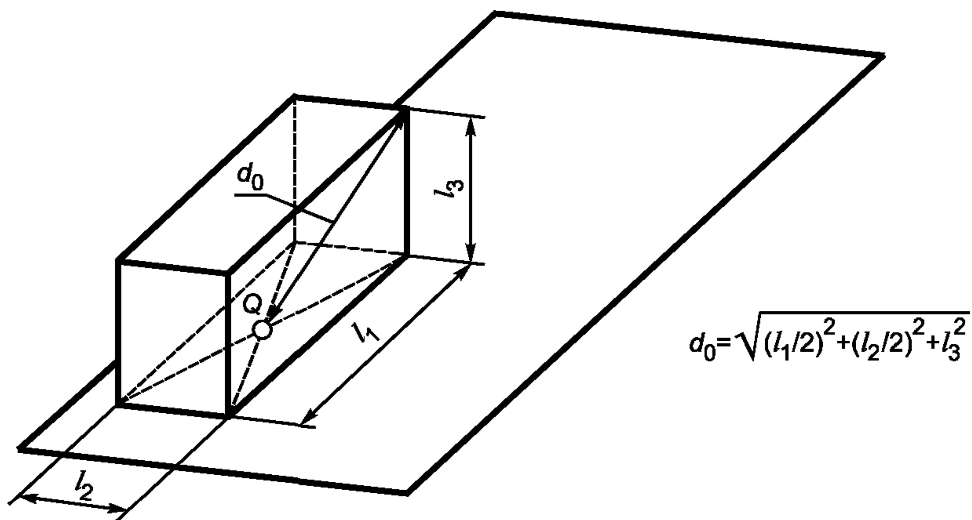
б) Огибающий параллелепипед на двух звукоотражающих плоскостях
