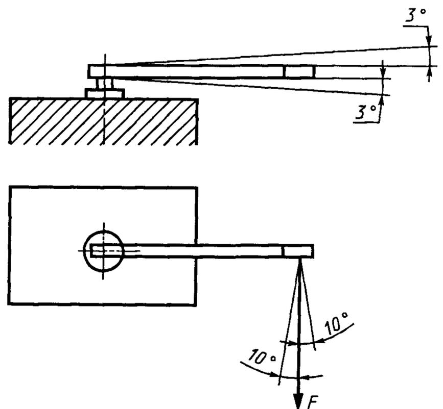
Рисунок 2 — Горизонтальное расположение ключа
