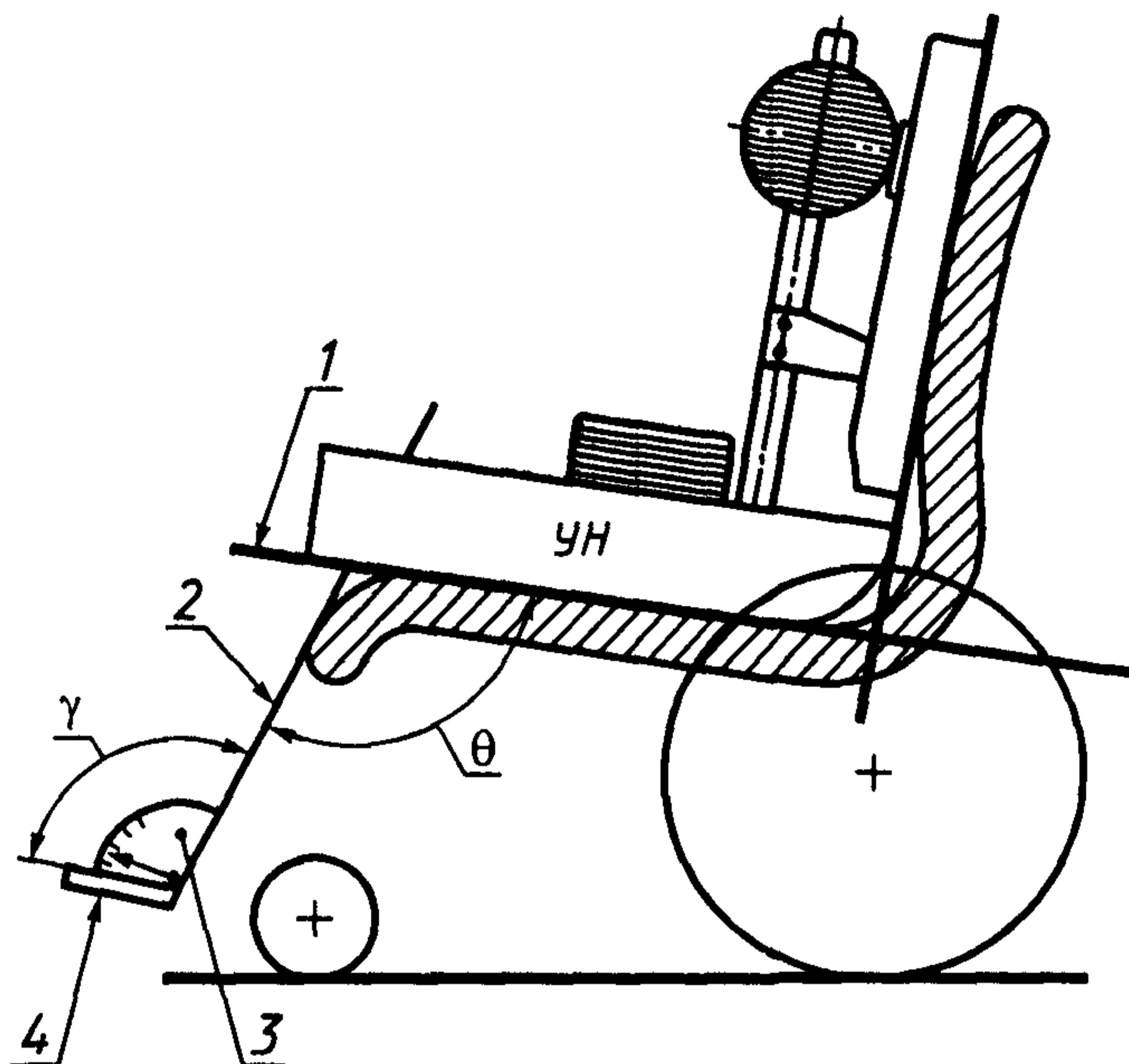
$\gamma$  — угол наклона опоры стопы;  $\theta$  — угол наклона подножки к поверхности сиденья; 1 — базовая плоскость сиденья; 2 — базовая плоскость подножки; 3 — угломер с нониусом; 4 — опора стопы
