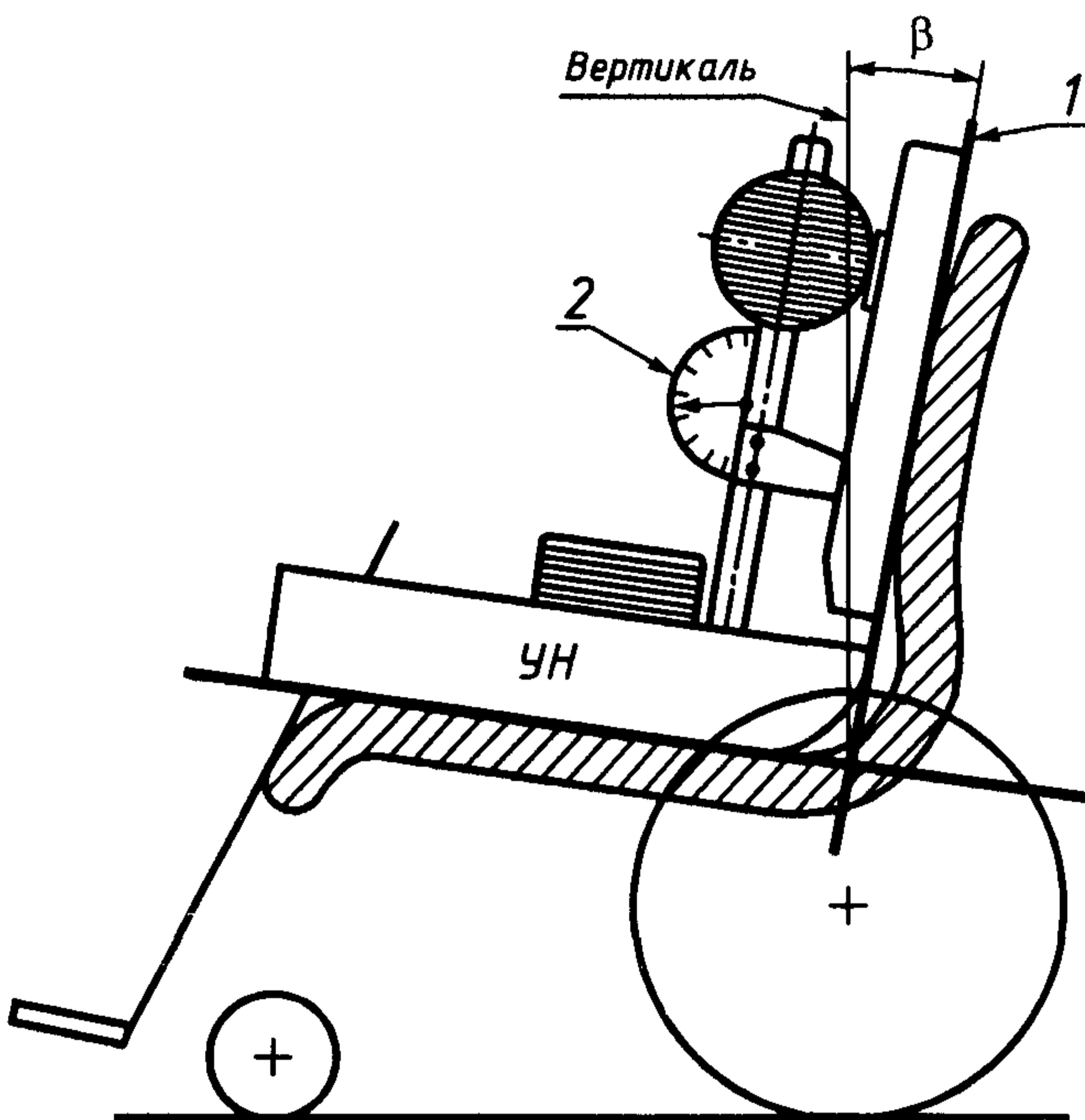
$\beta$  — угол наклона спинки; 1 — базовая плоскость спинки,
