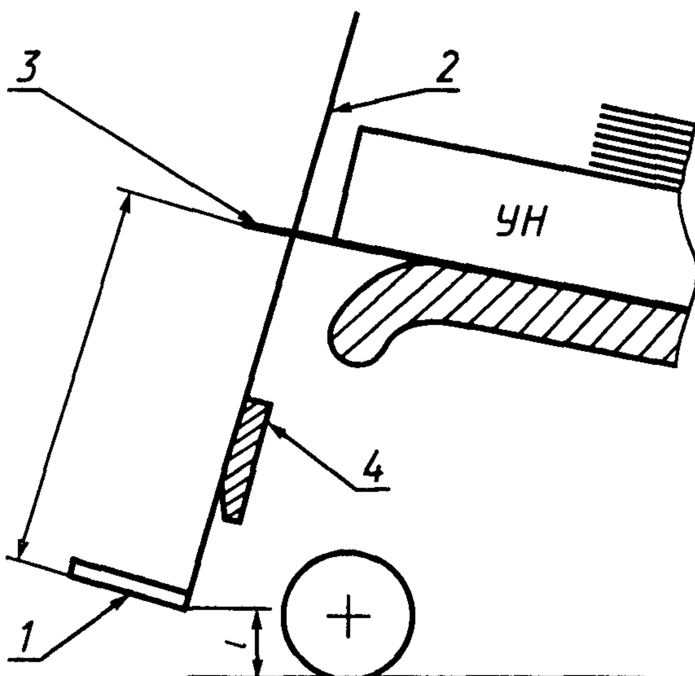
1 — опора стопы; 2 — базовая плоскость подножки; 3 — базовая плоскость сиденья; 4 — подставка под голень
