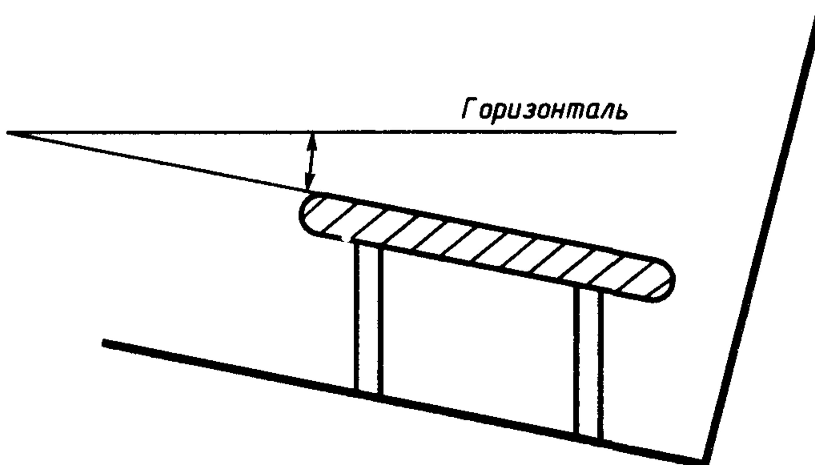
Рисунок 22 — Угол наклона подлокотника
