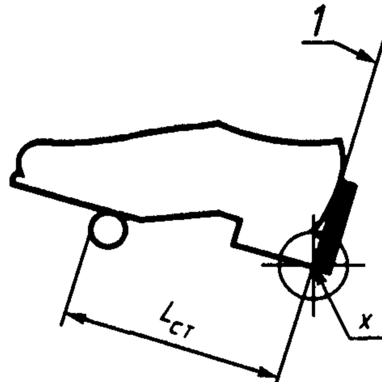
б) Трубчатая опора стопы с задником-держателем
