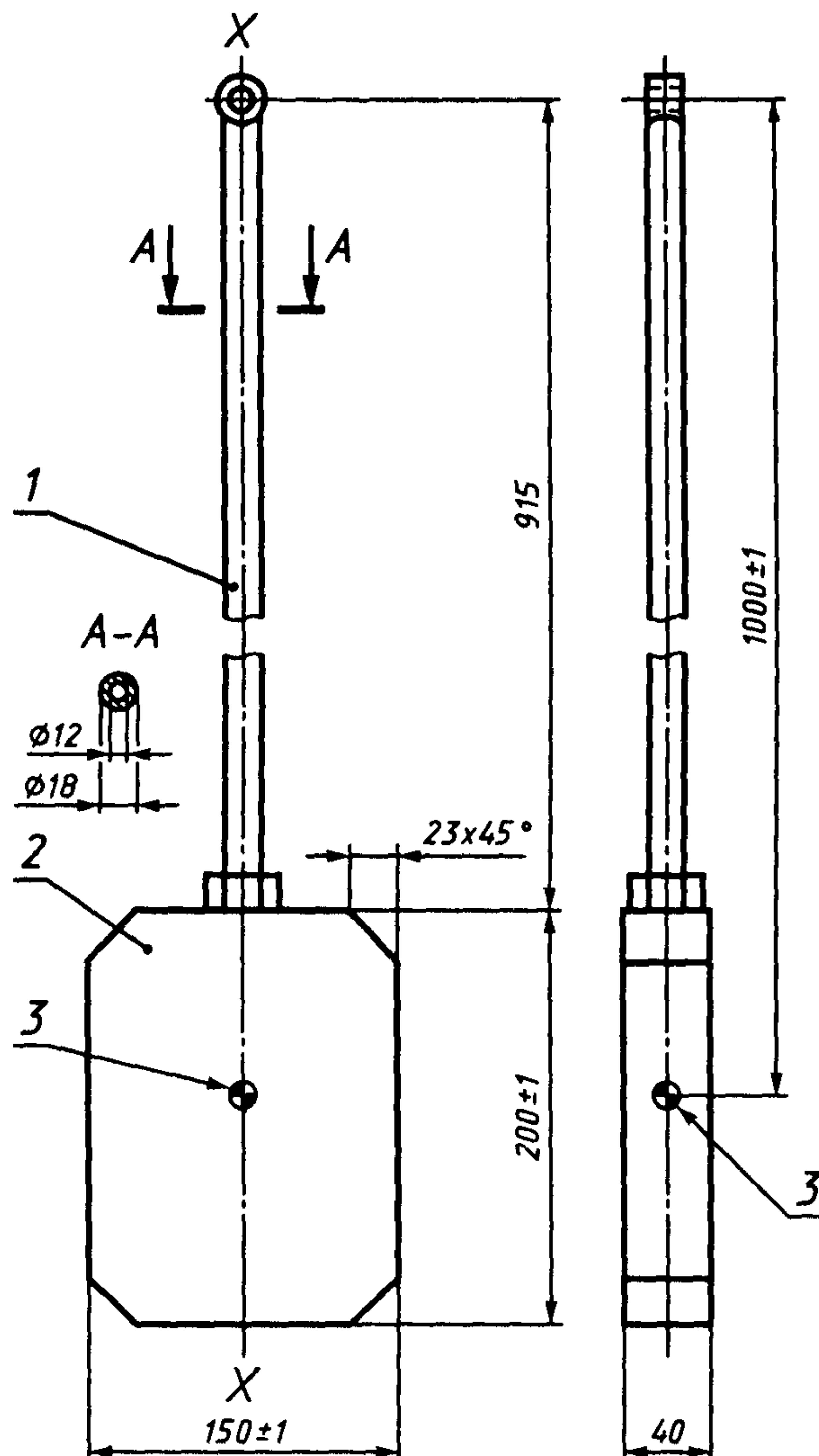
1 — стальная труба; 2 — стальной блок; 3 — центр удара
