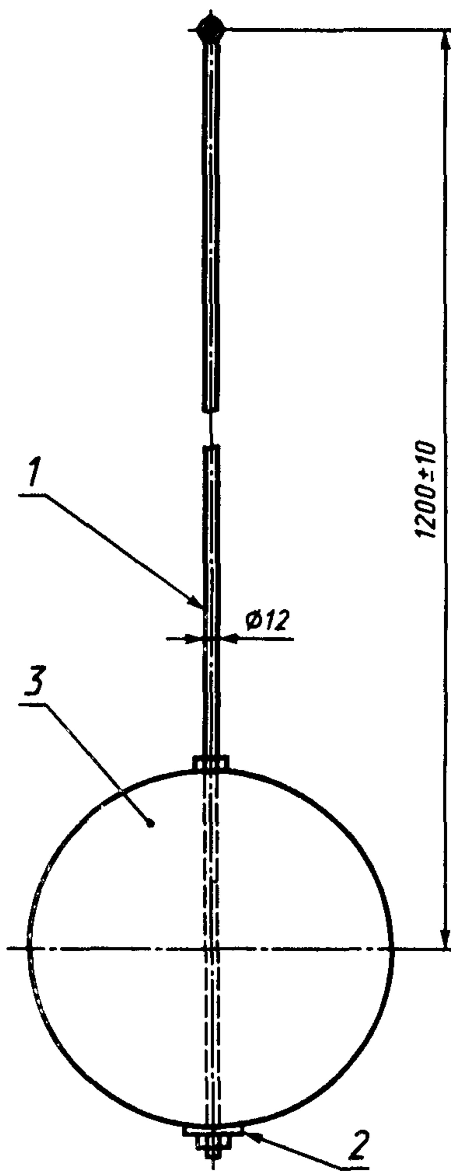
1 — винтовой стержень; 2 — прокладка  $\varnothing (50 \pm 10)$  мм; 3 — шар, наполненный свинцовой дробью диаметром  $(3,5 \pm 1)$  мм, с покрытием из пенопласта со следующими характеристиками: плотность  $(75 \pm 15)$  кг/м<sup>3</sup>, твердость  $(325 \pm 60)$  Н, сферичность  $\pm 20$  мм.
