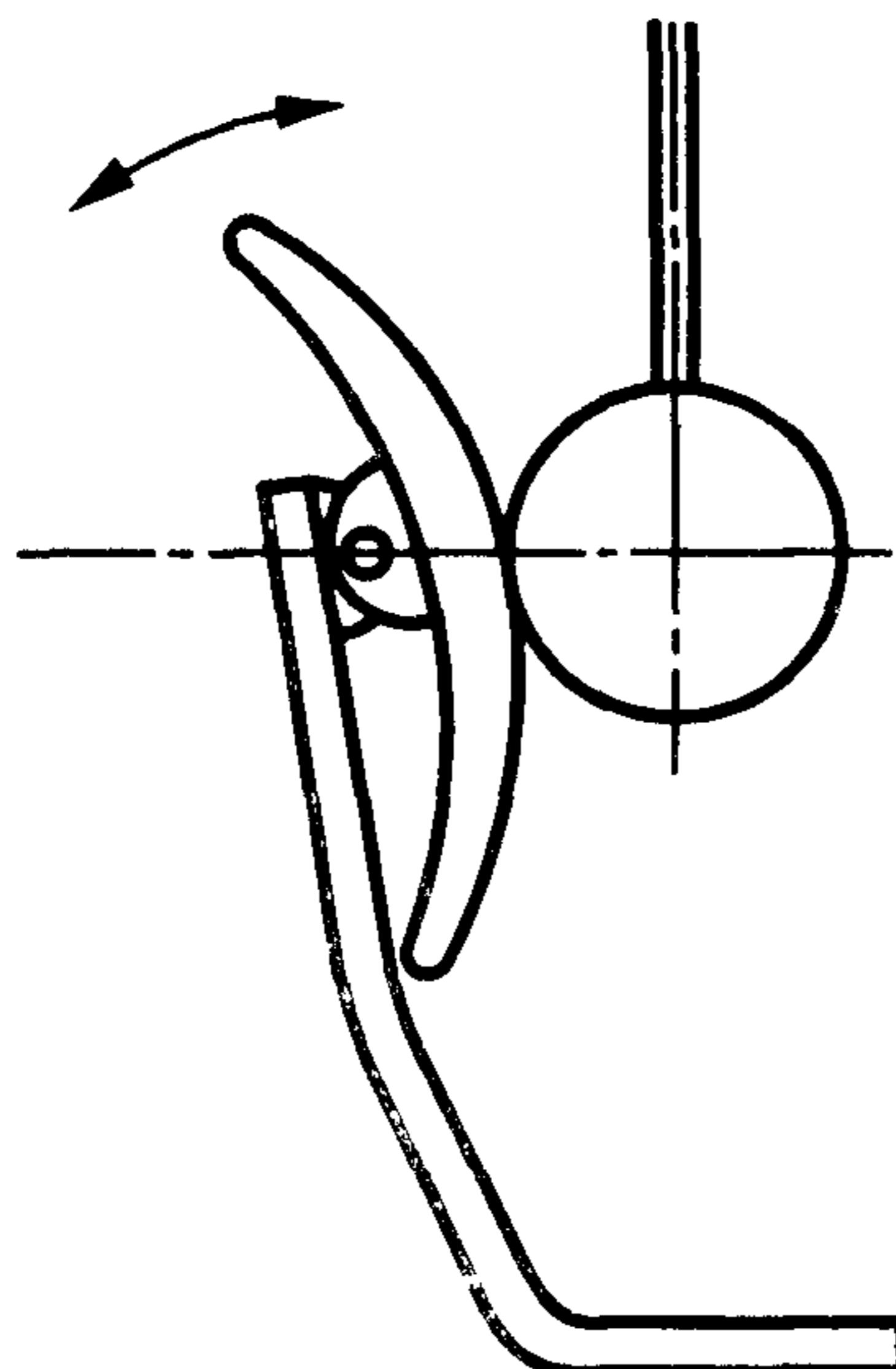
Рисунок 15 — Спинка кресла-коляски с самонастраивающимся углом наклона
