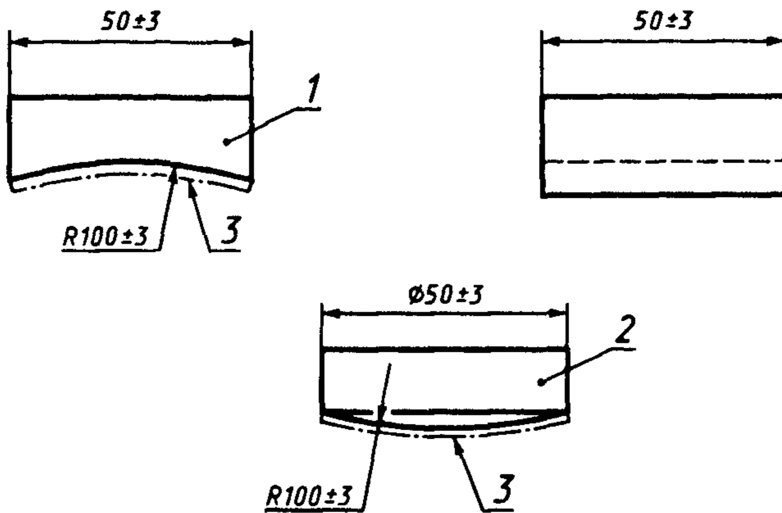
1 — вогнутая пластина; 2 — выпуклая пластина; 3 — нагружающая поверхность
