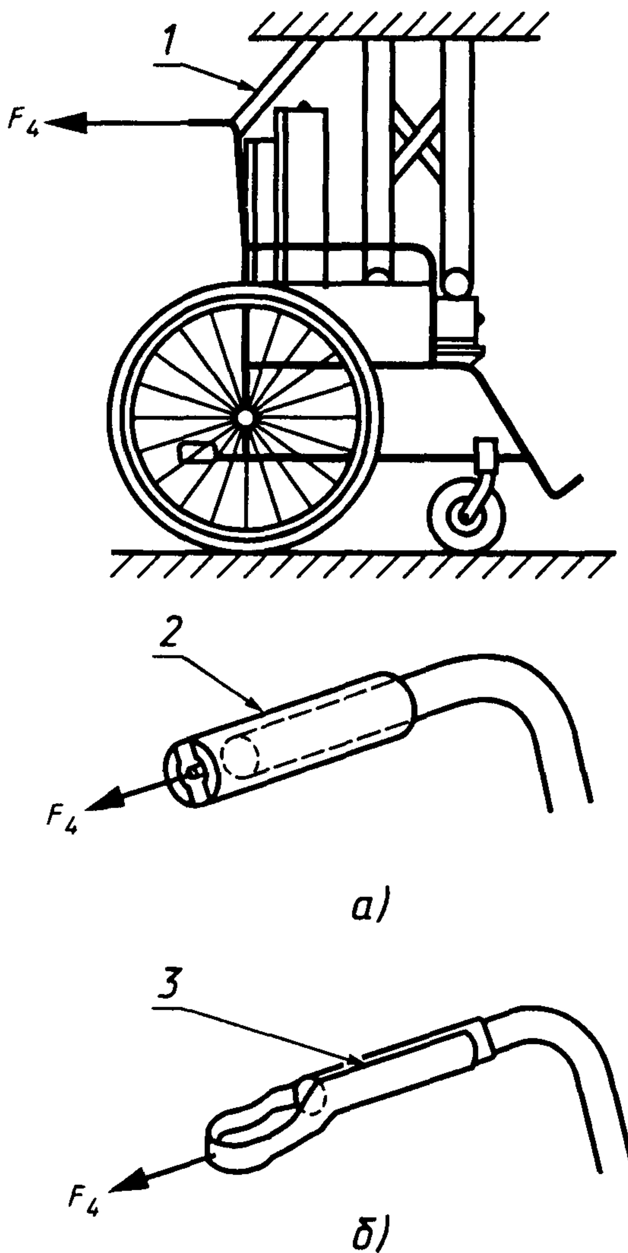
а) и б) — варианты исполнения устройств к ручкам кресла-коляски для приложения испытательной нагрузки
