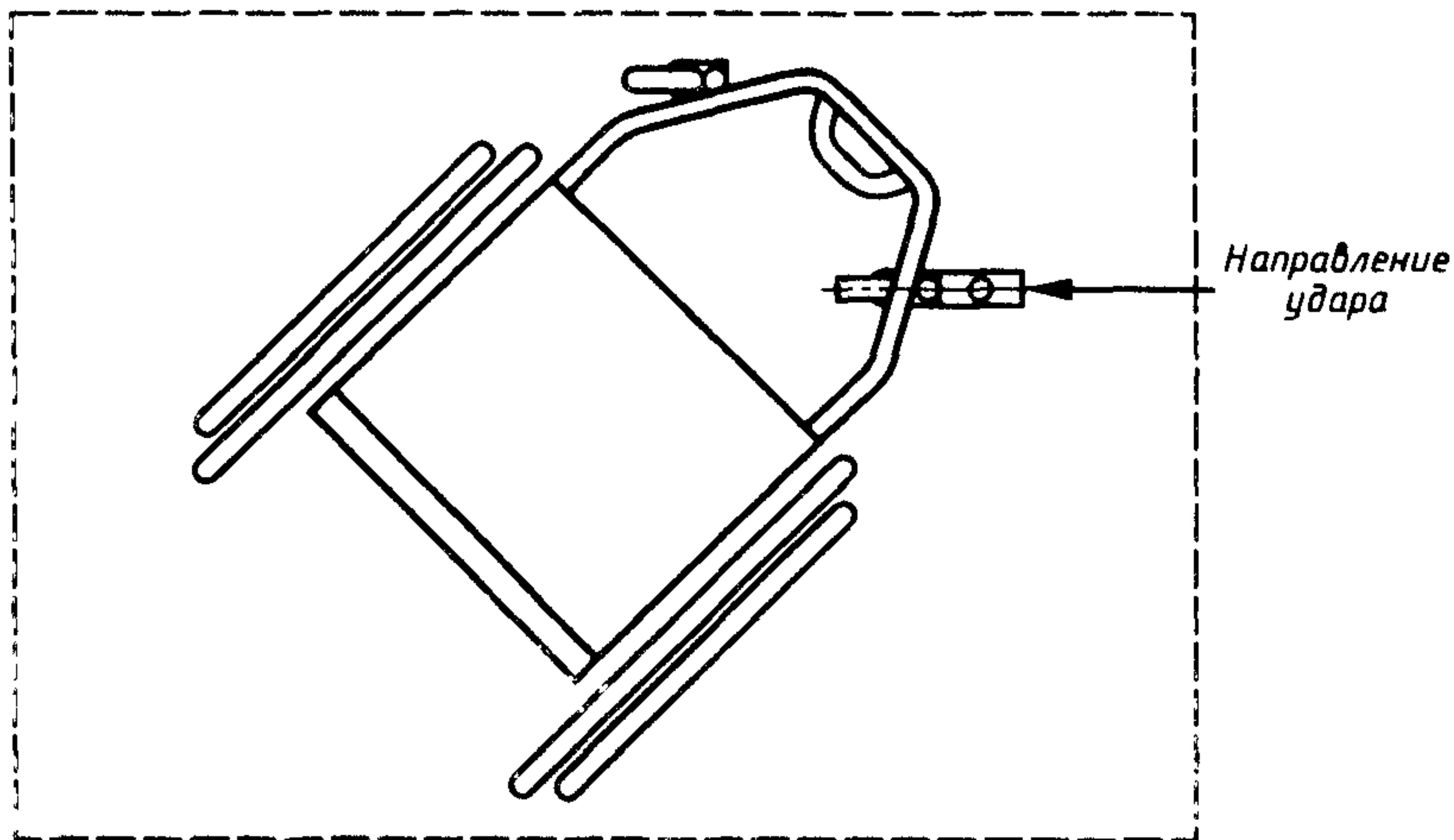
Рисунок 19 — Испытания поворотных колес кресла-коляски на ударную прочность
