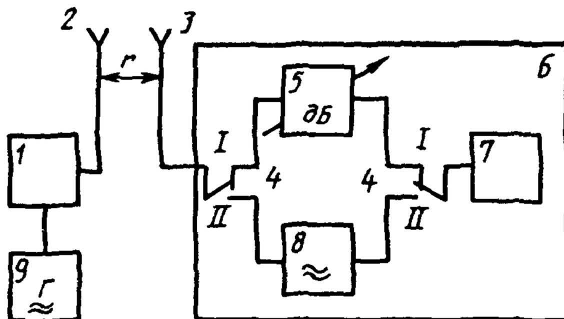
1 — контролируемый радиопередатчик; 2 — антенна испытуемого радиопередатчика;
