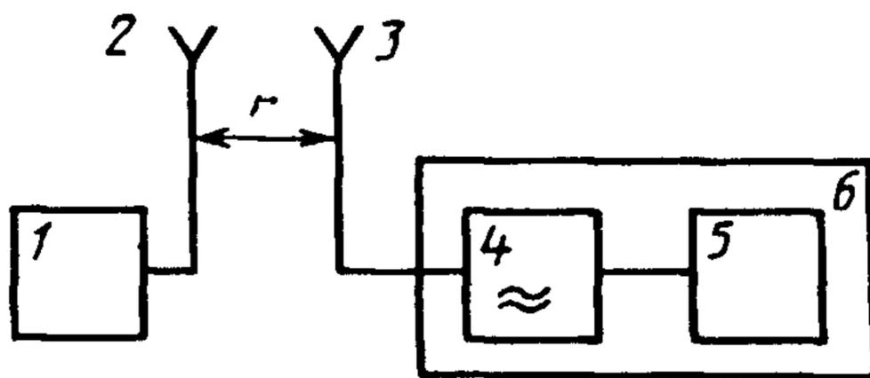
1 — контролируемый радиопередатчик; 2 — антенно-фидерная система;
