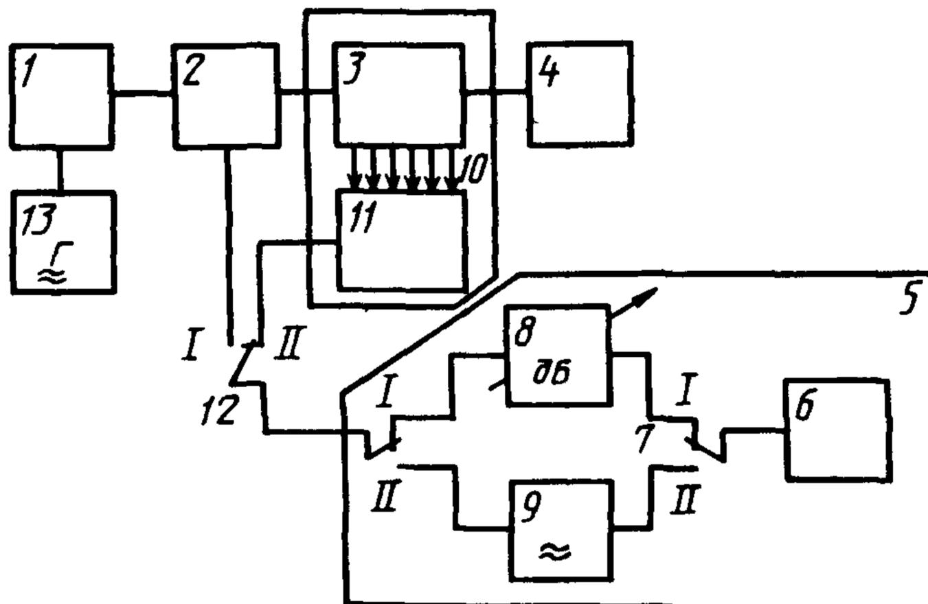
1 — контролируемый передатчик; 2 — направленный ответвитель для волны основного типа, 3 — НОММ или отборник другого типа; 4 — эквивалентное нагрузочное сопротивление или штатная антенна радиопередатчика; 5, 10 — экранированные камеры (используются при необходимости); 6 — измерительный приемник; 7, 12 — высокочастотный переключатель; 8 — измерительный аттенюатор; 9 — фильтр (используется при необходимости); 11 — многоканальный коаксиальный переключатель; 13 — генератор сигналов низкочастотный
