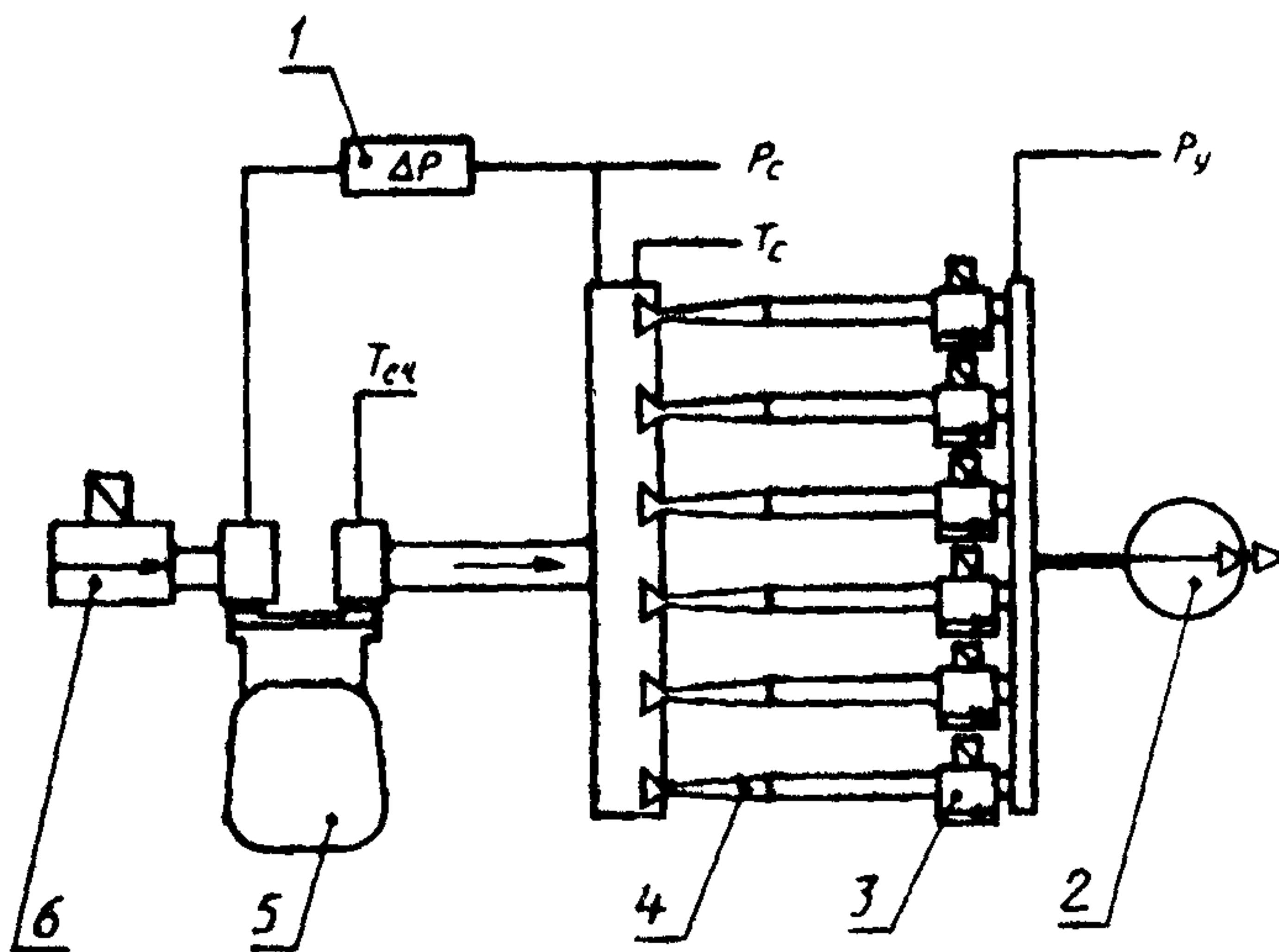
1 — дифманометр измерения потери давления  $\Delta P$  на счетчике; 2 — вакуумный насос, 3 — выходные краны сопел; 4 — образцовое звуковое сопло; 5 — испытуемый счетчик; 6 — входной кран установки;
