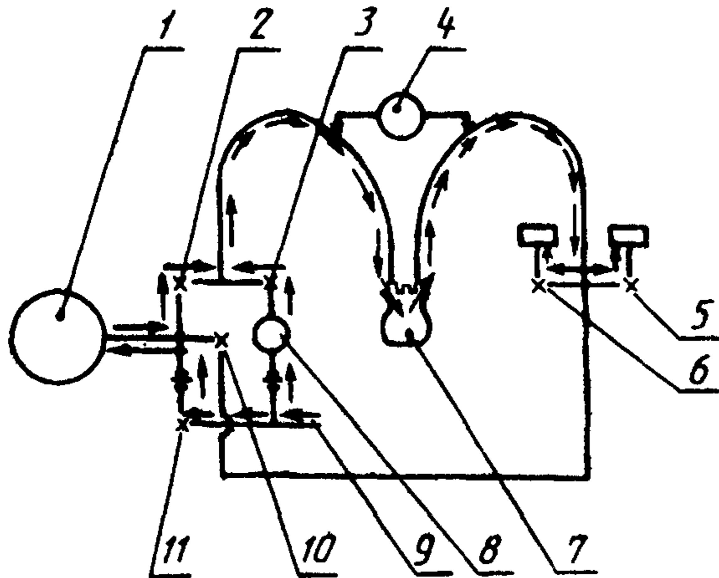
1 — колокольная установка; 2 — кран испытания; 3 — кран подачи воздуха для опробования;
