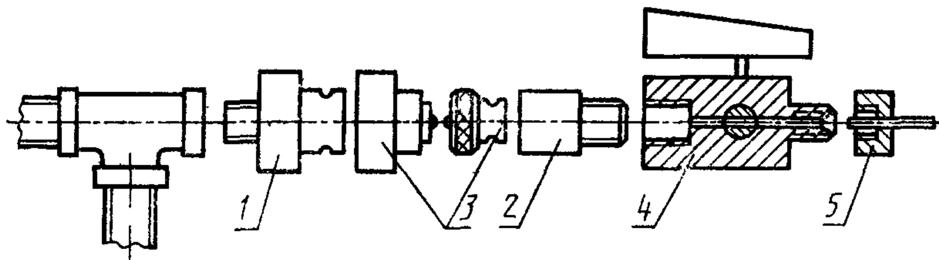
1 — запорный клапан, постоянно подсоединеная часть быстроразъемного соединения; 2 — съемная часть быстроразъемного соединения (если применяется); 3 — защитные крышки, 4 — сферический край, 5 — насадок
