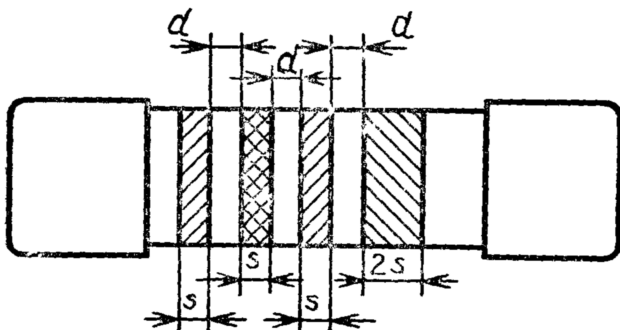
Значения размеров  $d$  и  $s$  должны составлять  $(0,8 \pm 0,2)$  мм; могут уточняться в последующих частях комплекса стандартов
