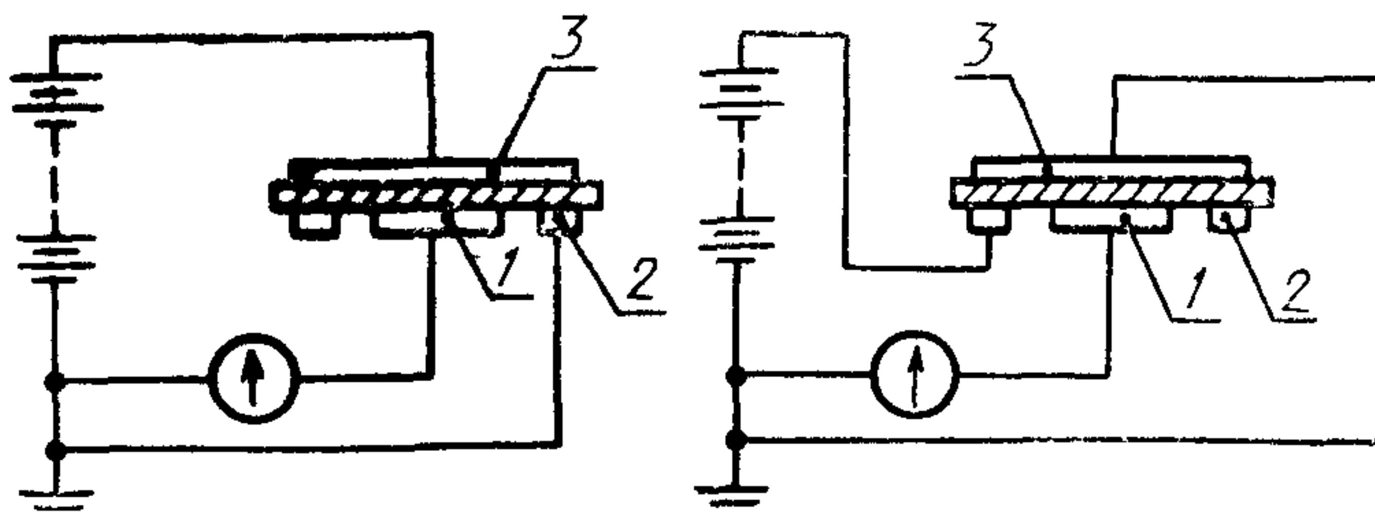
а) для измерения удельного объемного сопротивления
