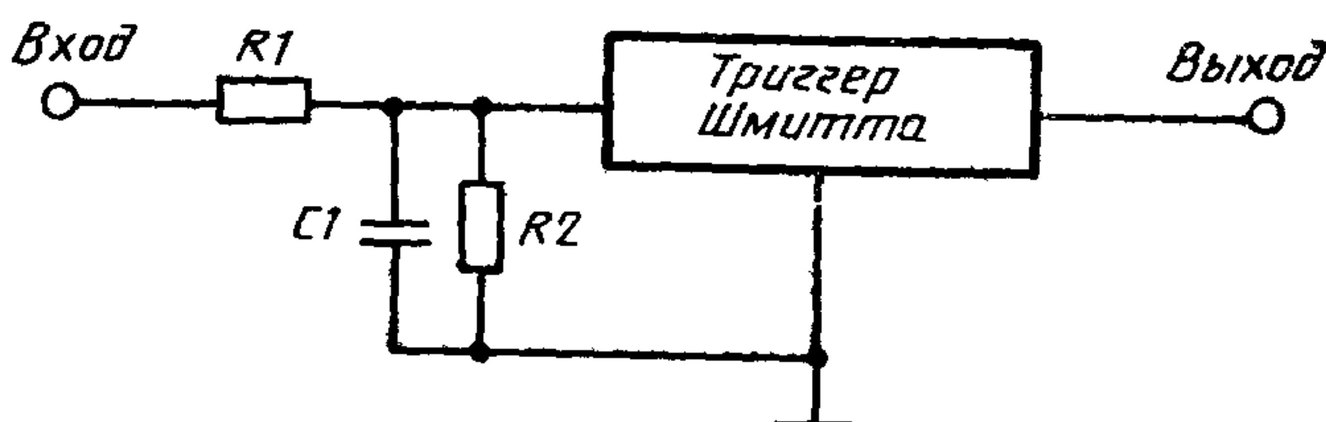
Примечание. В качестве триггера Шмитта используют микросхемы типов 552 ТЛ2 и 1533 ТЛ2
