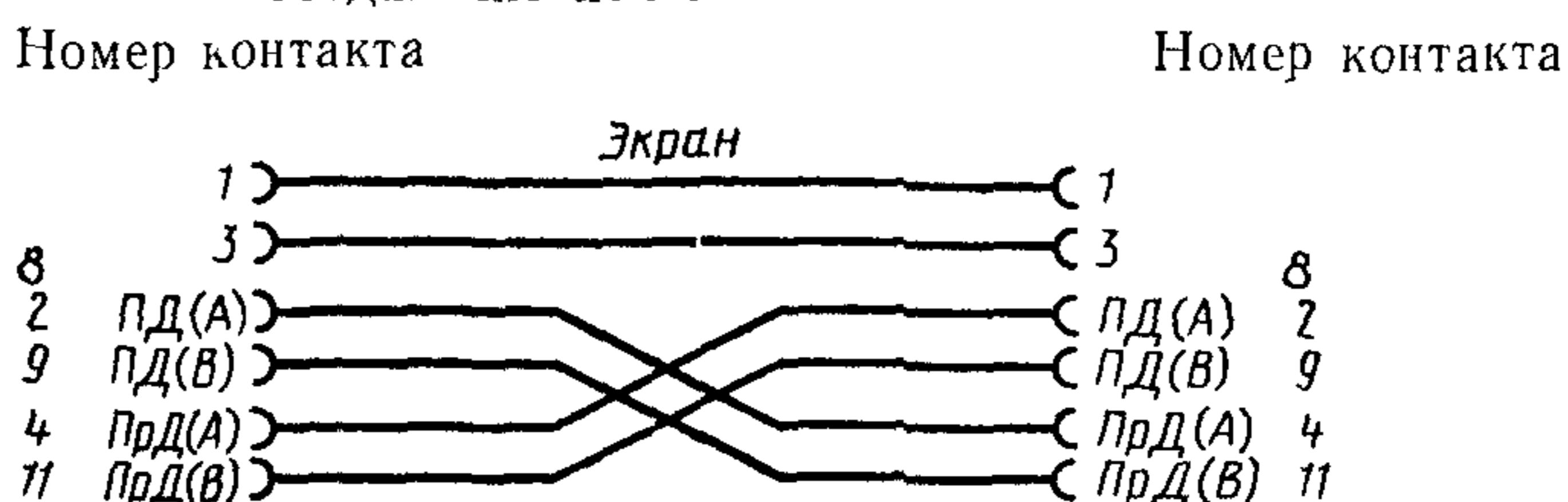
**Примечание** Эта версия согласования соответствует ИСО 8481 и обеспечивает взаимодействие интерфейсов типа X 20 и X.21, определенных Рекомендациями МККТТ, в сети передачи данных общего пользования при скоростях до 9600 бит/с.
