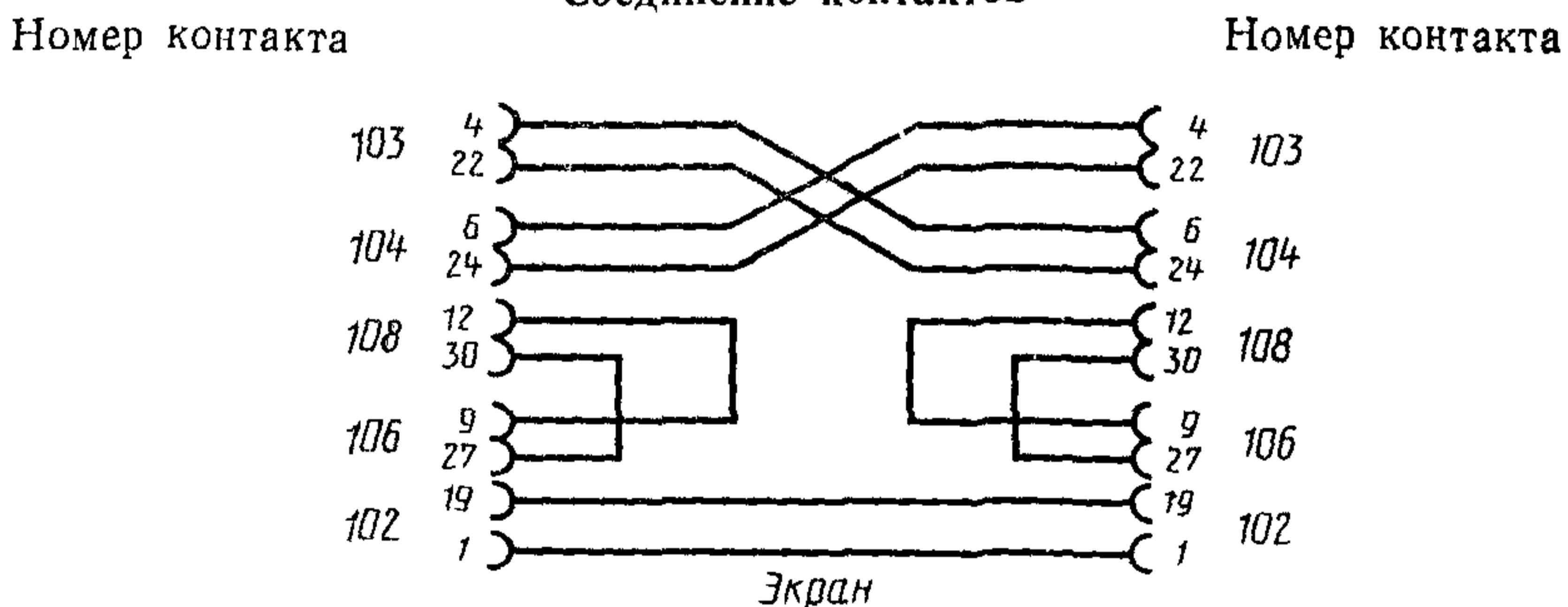
Примечание. Эта схема использует упрощенную версию соединений контактов цепей обмена, которая не была включена в ИСО/ТО 7477.
