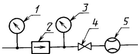
1 — манометр для измерения входного давления  $P_1$  (класс точности не хуже 1,0); 2 — испытуемое устройство; 3 — манометр для измерения выходного давления  $P_2$  (класс точности не хуже 1,0); 4 — вентиль; 5 — расходомер
