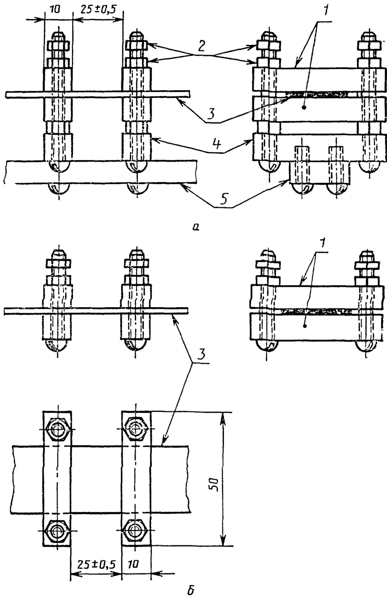
1—металлические электроды; 2—гайки; 3—образец; 4—изоляционный материал; 5—металлический держатель и экран
