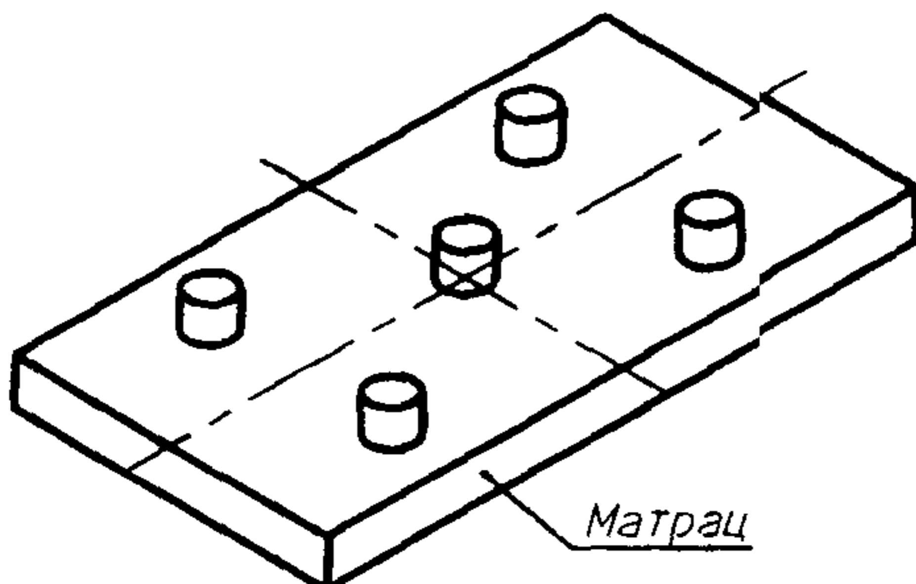
Рисунок 102 – Расположение ИСПЫТАТЕЛЬНЫХ УСТРОЙСТВ
