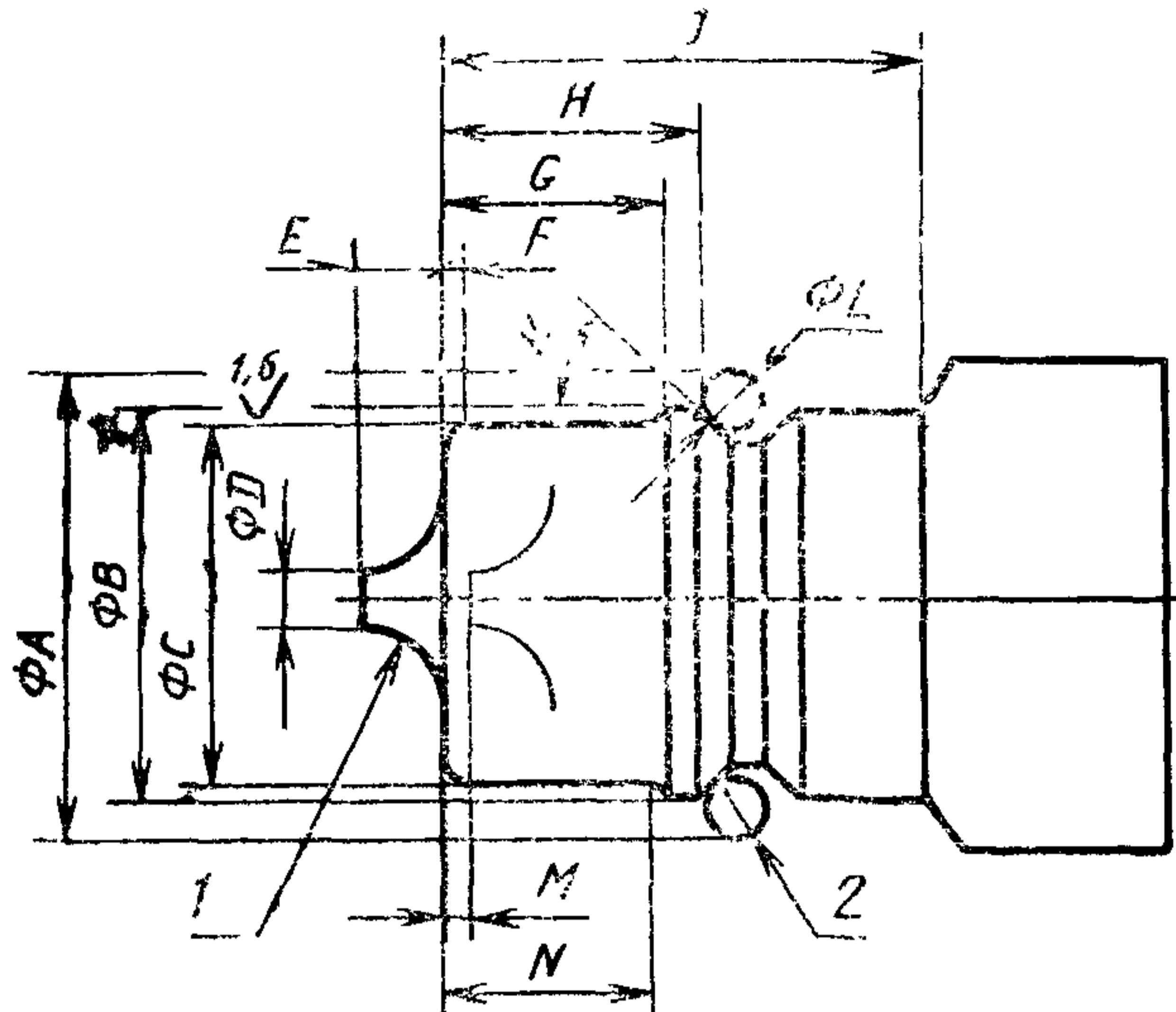
$\text{Ø}A$  — контролируемый диаметр;  $F$  — размер скругления или фаски (форма — по выбору);  $H$  — размер до шарика;  $M$  — размер при полностью открытом клапане — «до упора»;  $N$  — минимальная длина образующей на  $\text{Ø}C$ ; 1 — клапан (форма — произвольная); 2 — место контакта шарика
